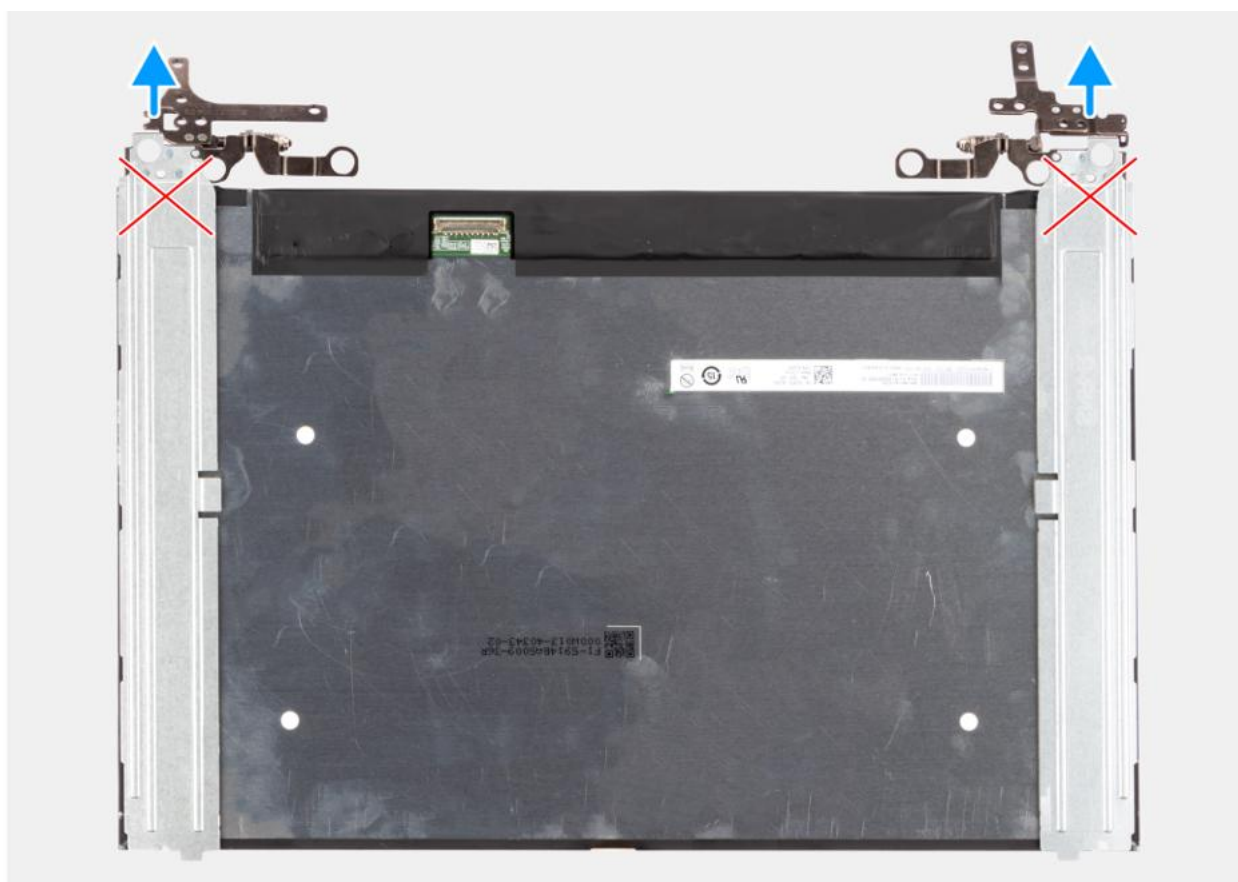
Rysunek 80. Wymontowywanie wyświetlacza
