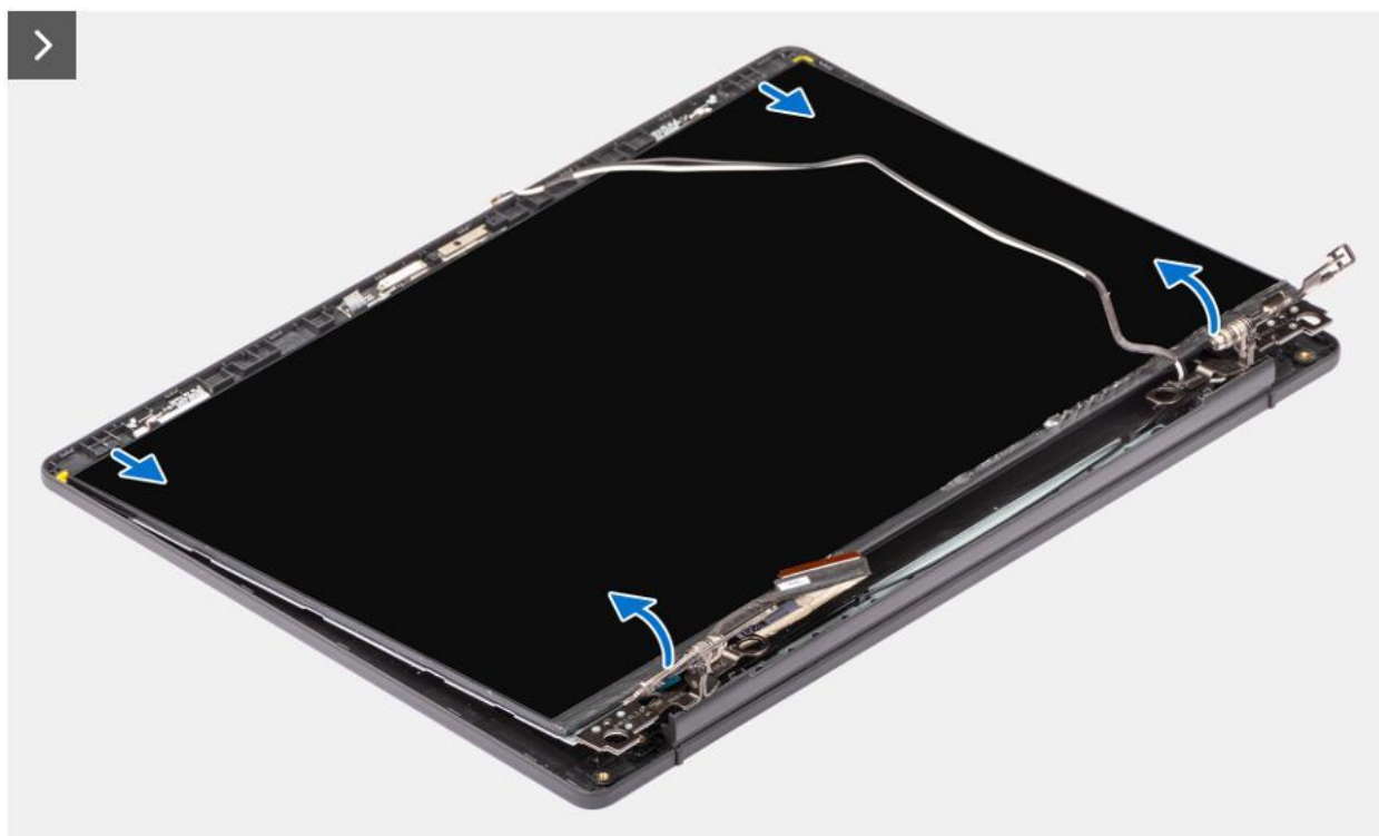
Rysunek 78. Wymontowywanie wyświetlacza
