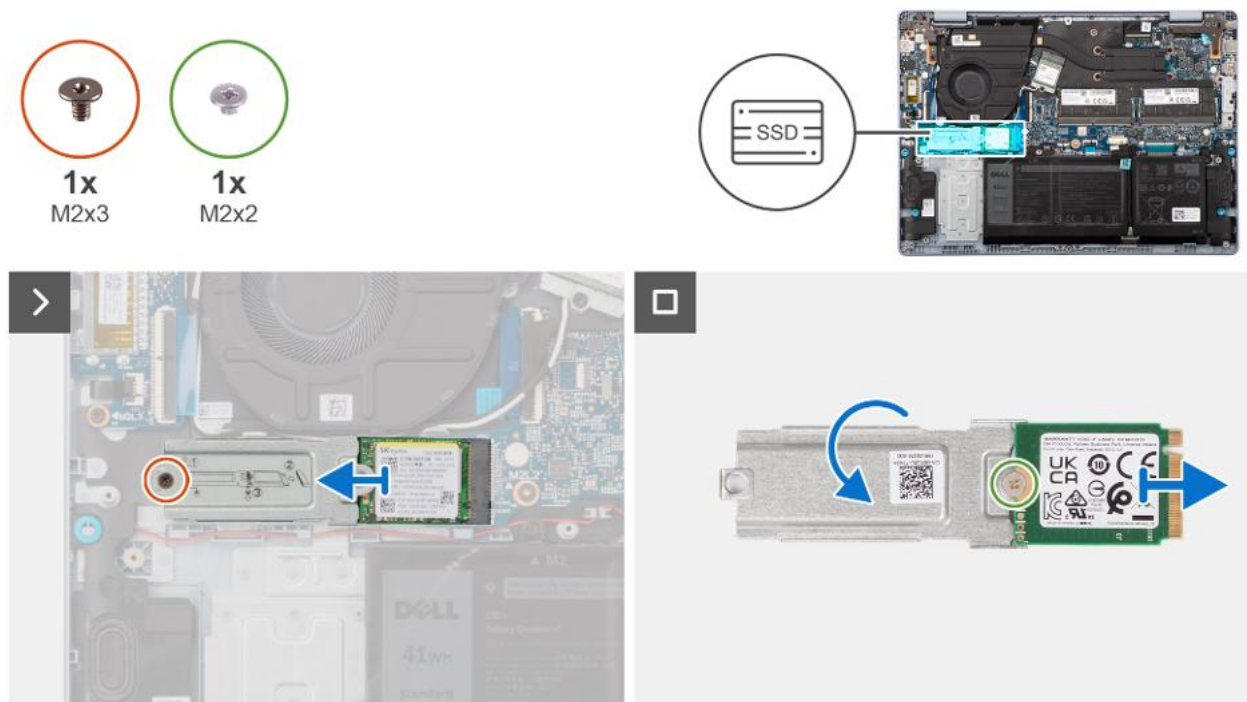
Rysunek 32. Wymontowywanie dysku SSD
