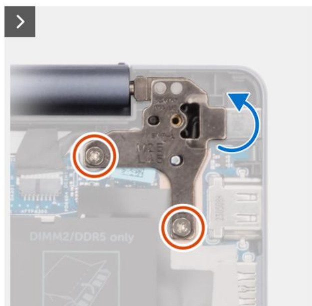
Rysunek 48. Wymontowywanie gniazda zasilacza
