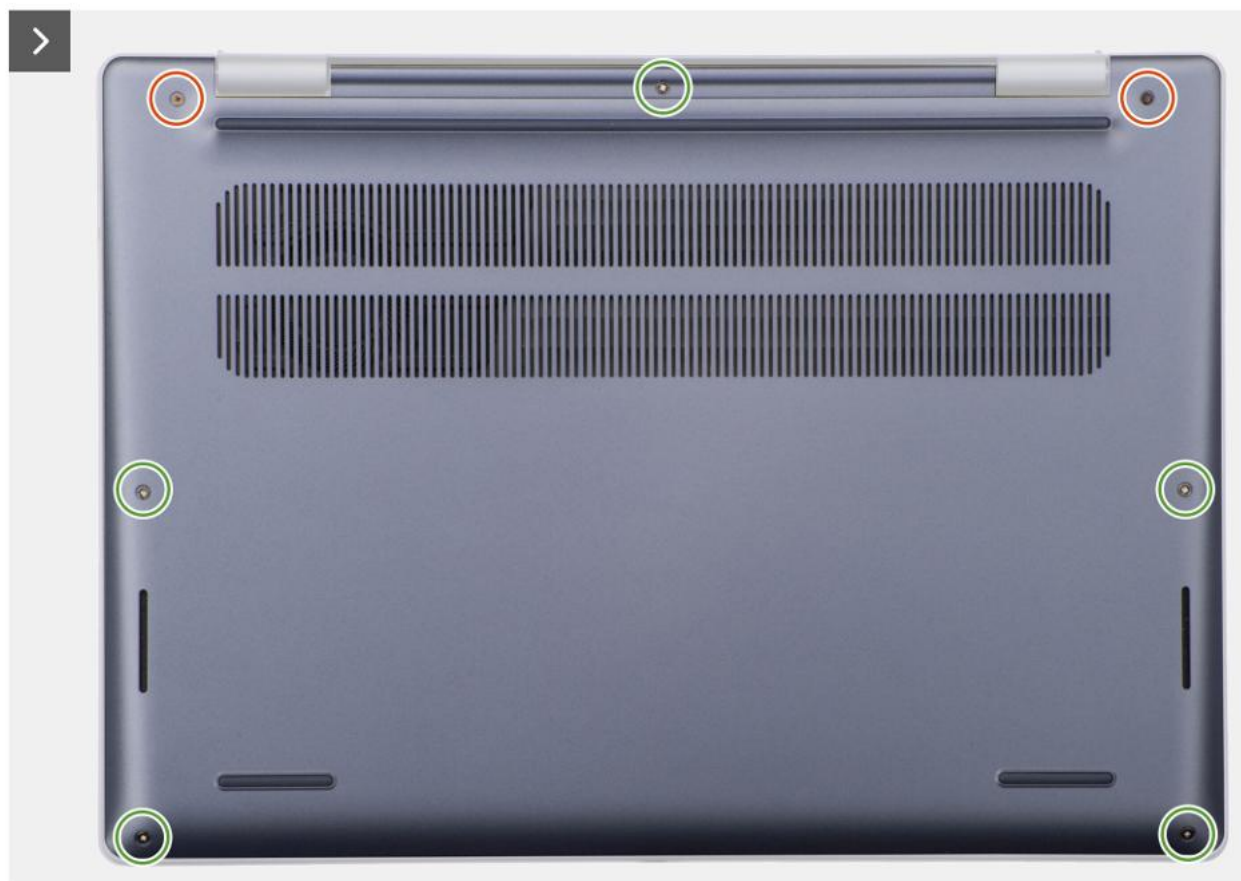
Rysunek 16. Wymontowywanie pokrywy dolnej
