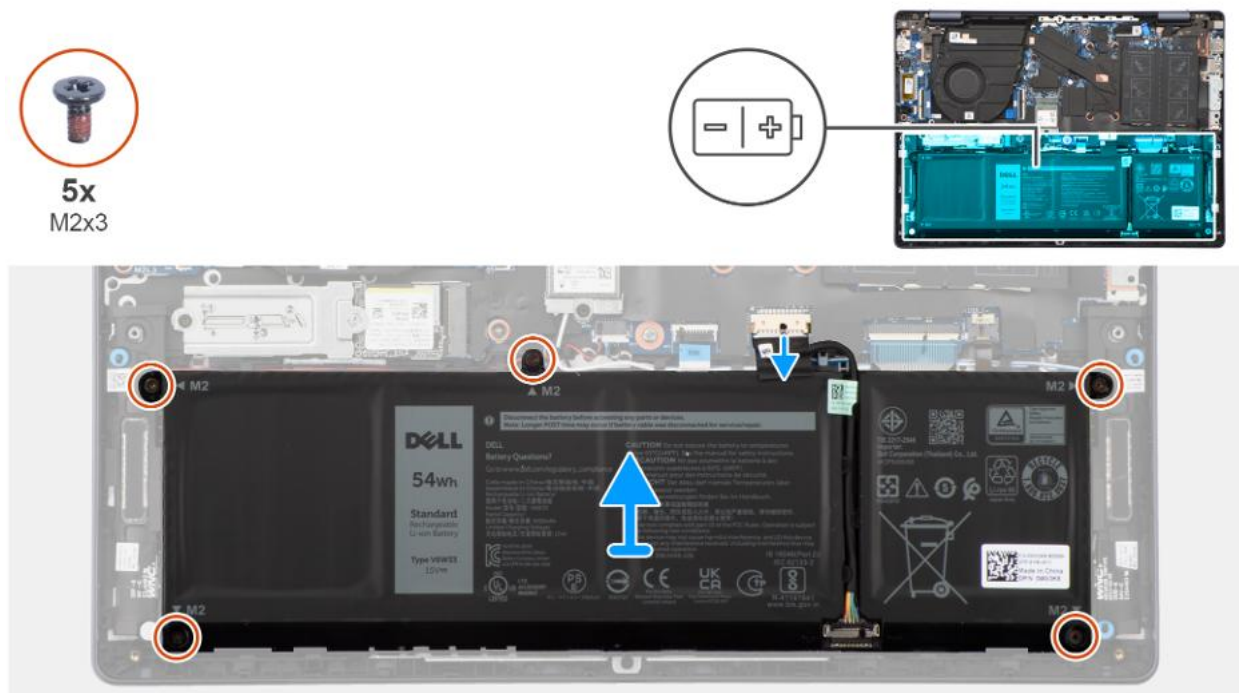
Rysunek 24. Wymontowywanie akumulatorów
