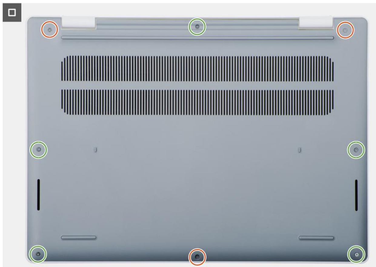
Rysunek 15. Instalowanie pokrywy dolnej
