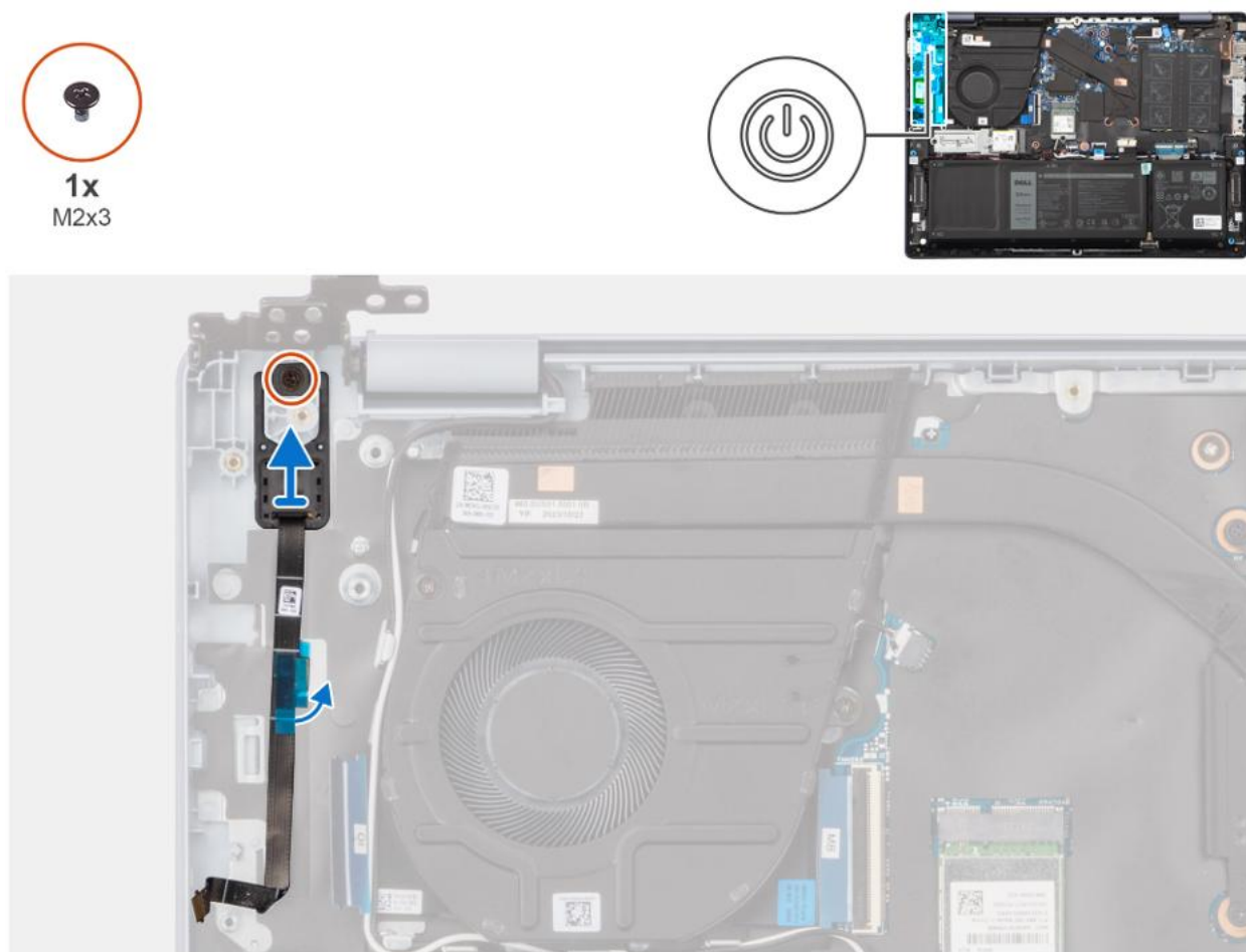
Rysunek 56. Wymontowywanie przycisku zasilania z czytnikiem linii papilarnych
