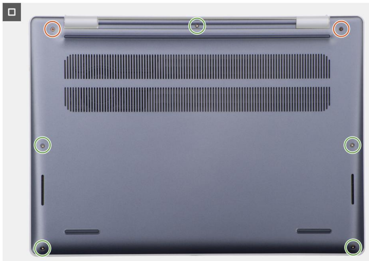
Rysunek 19. Instalowanie pokrywy dolnej
