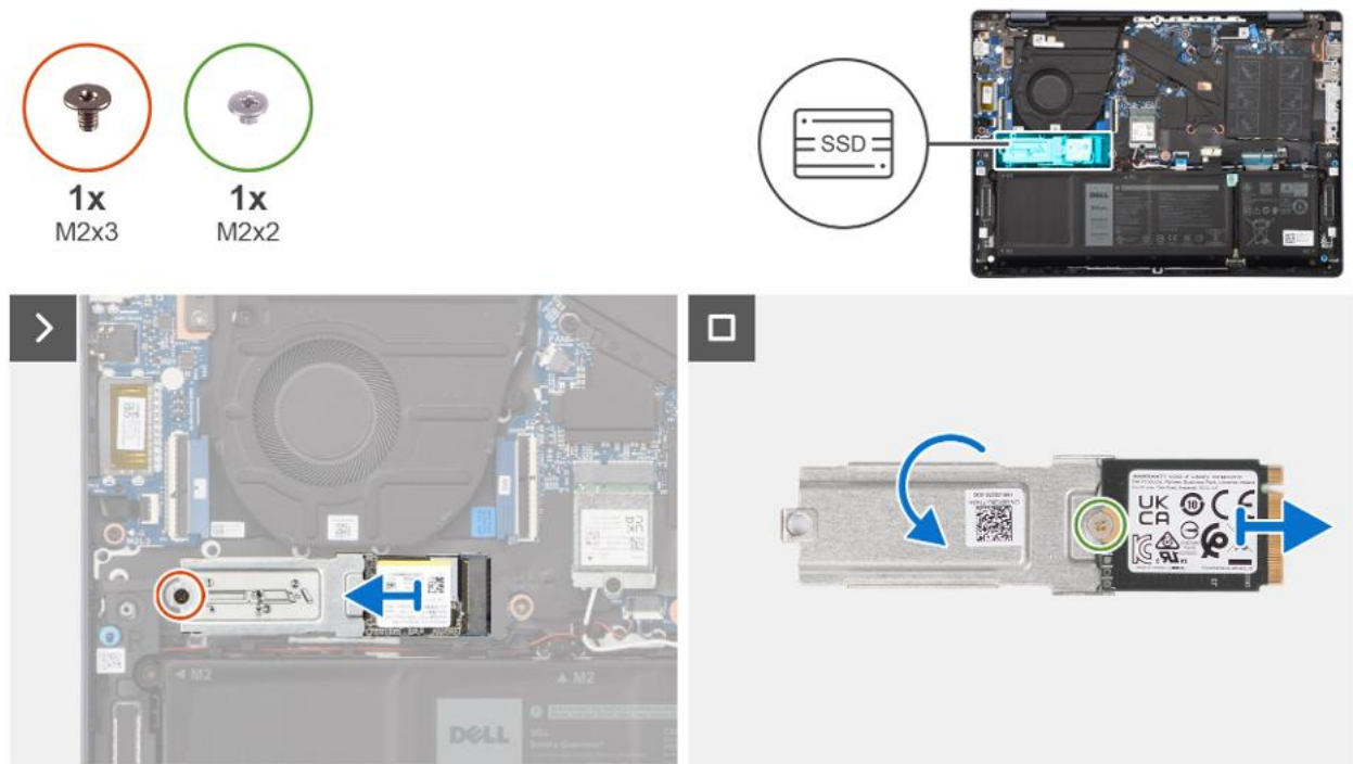
Rysunek 34. Wymontowywanie dysku SSD
