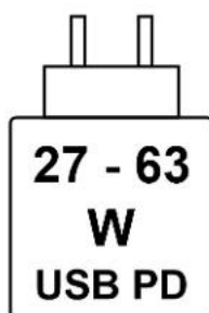
Rysunek 8. Wymagania dotyczące zasilania komputerów wyposażonych w baterię 4-ogniową 64 Wh
