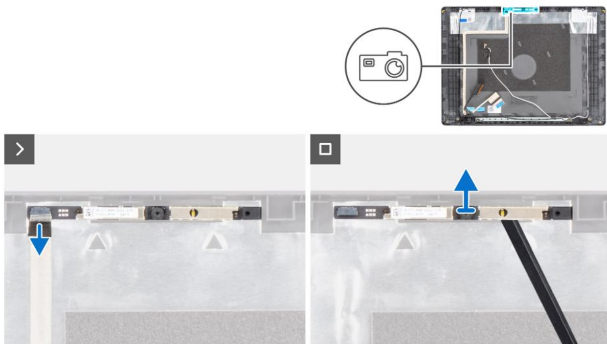
Rysunek 87. Wymontowywanie kamery
