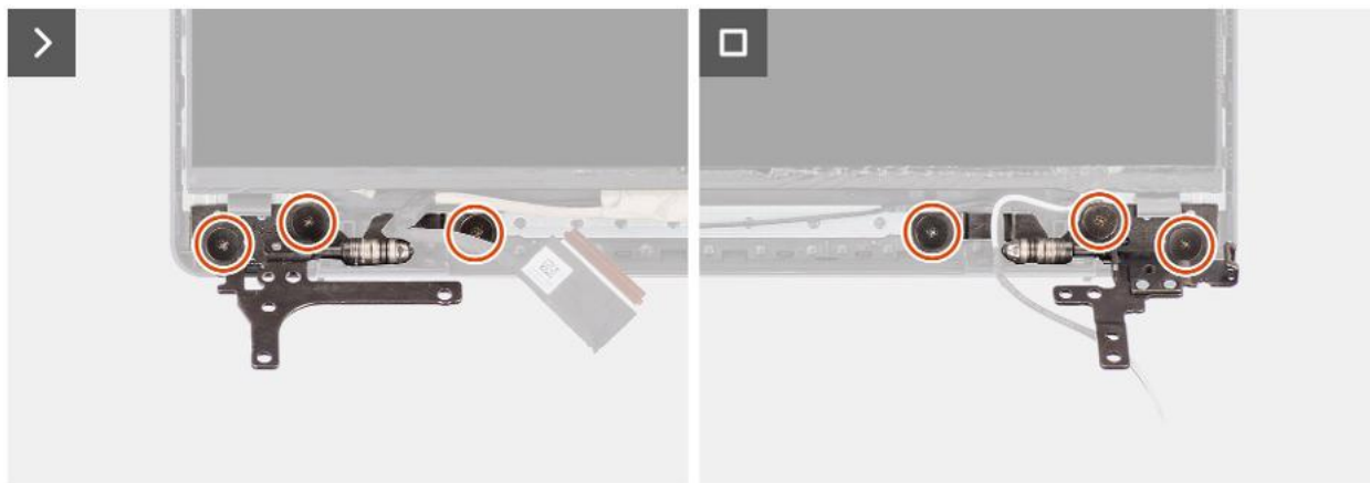
Rysunek 84. Instalowanie wyświetlacza
