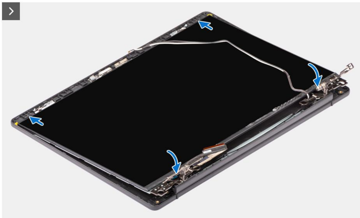
Rysunek 82. Wkręcanie śrub
