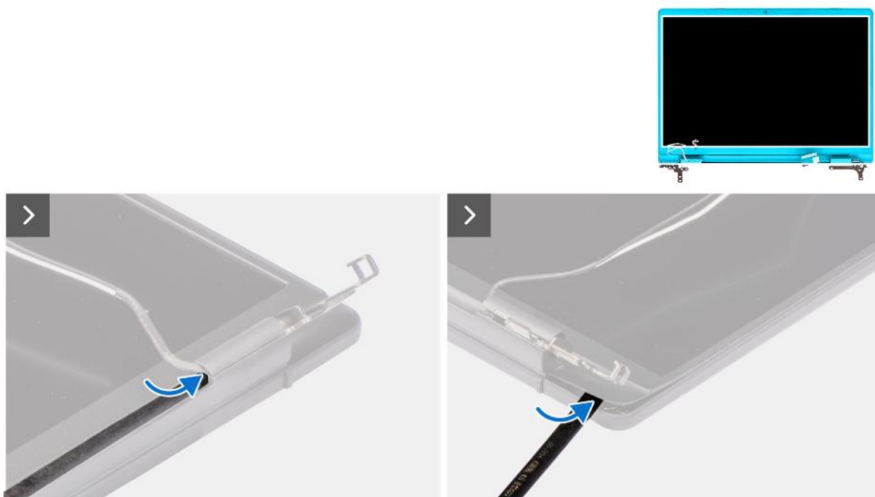
Rysunek 74. Wymontowywanie ramki wyświetlacza
