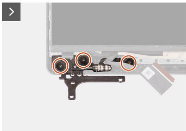
Rysunek 76. Wykręcanie śrub wyświetlacza
