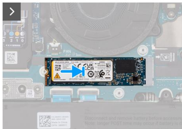
Rysunek 34. Instalowanie dysku SSD M.2 2280
