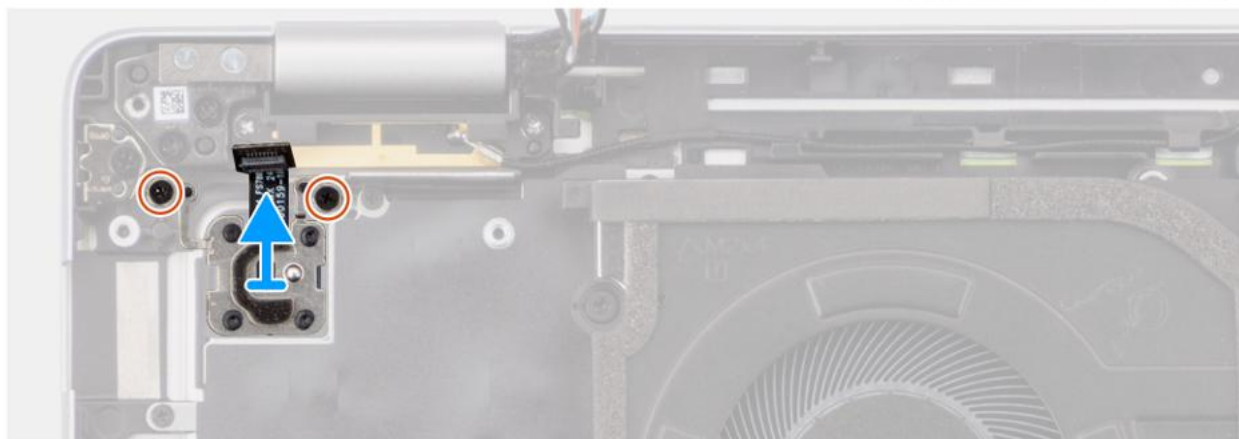
Rysunek 59. Wymontuj przycisk zasilania z opcjonalnym czytnikiem linii papilarnych
