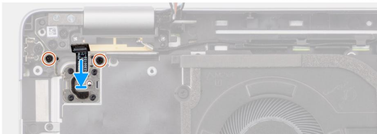
Rysunek 60. Instalowanie przycisku zasilania z opcjonalnym czytnikiem linii papilarnych
