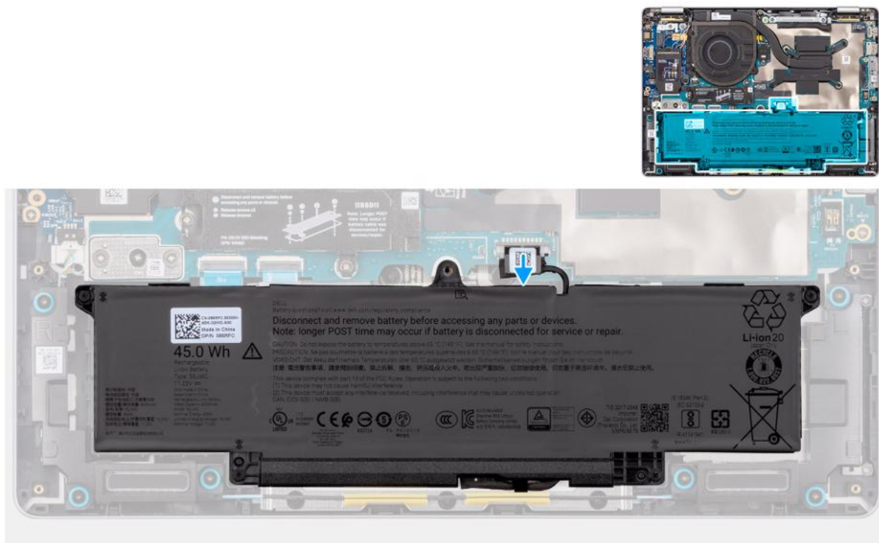
Rysunek 19. Odłączenie kabla baterii
