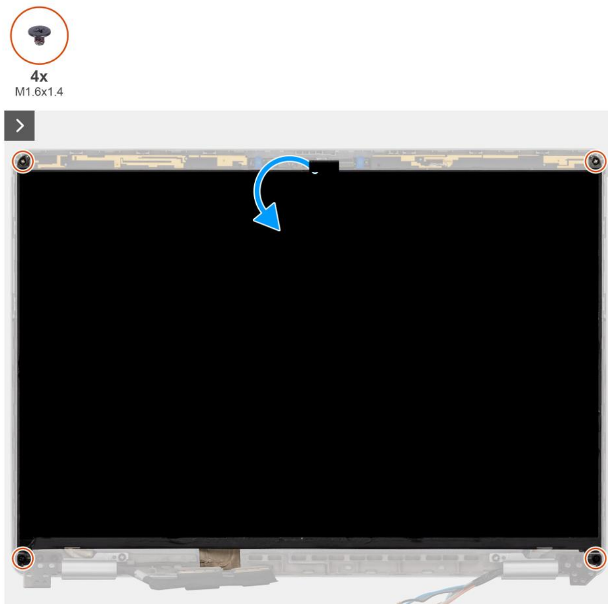
Rysunek 72. Wymontowywanie wyświetlacza
