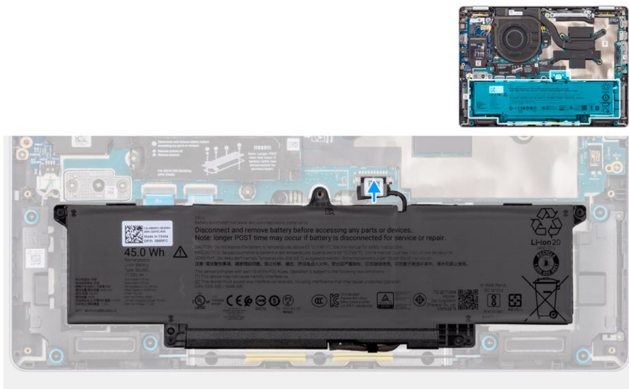
Rysunek 20. Podłączanie kabla baterii
