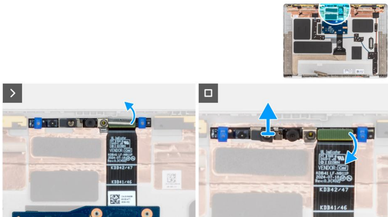
Rysunek 83. Wymontowywanie kamery MIPI
