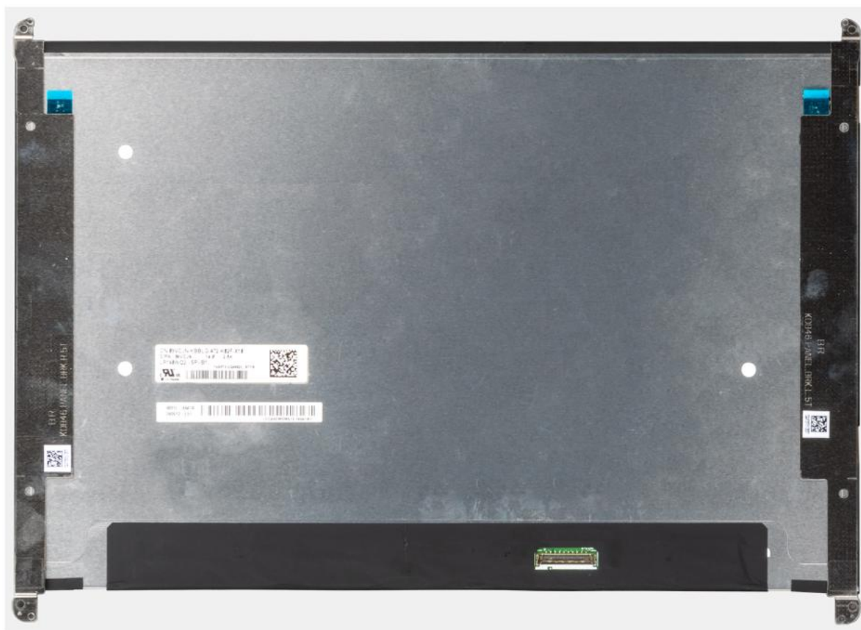
Rysunek 74. Panel wyświetlacza z klamrami
