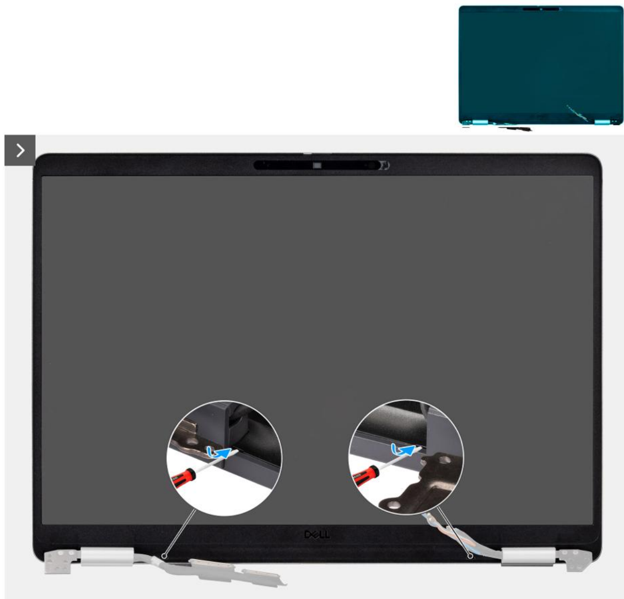
Rysunek 65. Podważanie plastikowej ramki
