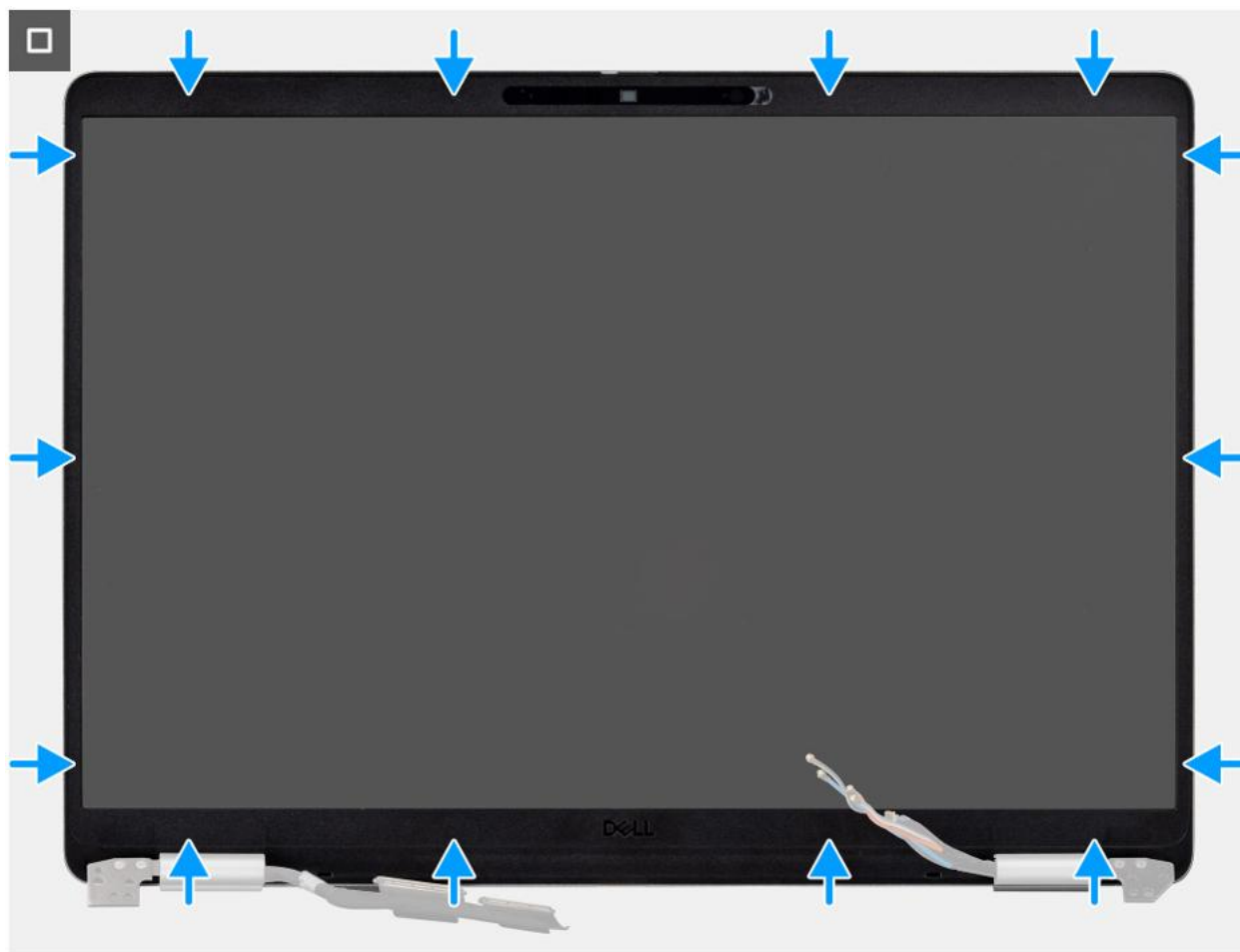
Rysunek 71. Instalowanie ramki wyświetlacza
