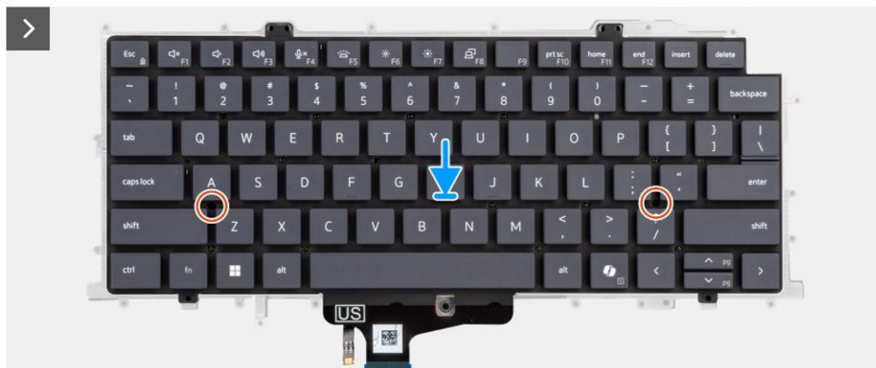
Rysunek 99. Instalowanie klawiatury
