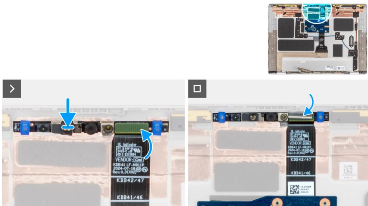
Rysunek 84. Instalowanie kamery MIPI
