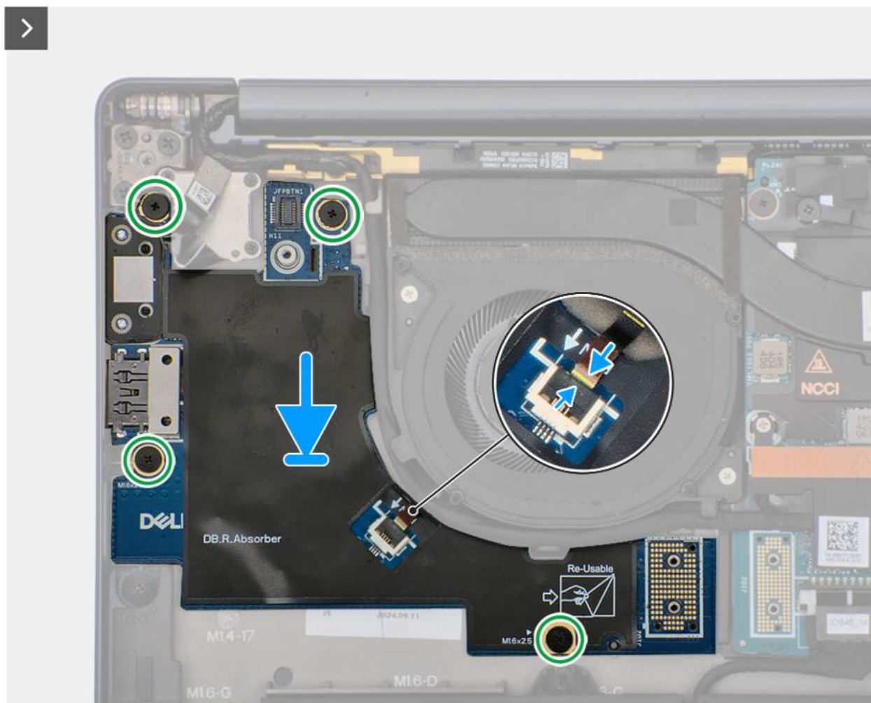
Rysunek 48. Instalowanie prawej płyty we/wy (bez anten WWAN)
