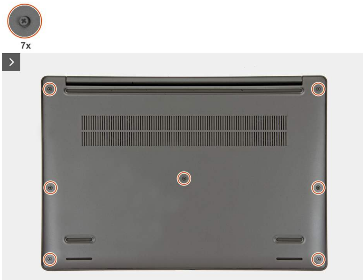
Rysunek 16. Luzowanie śrub mocujących
