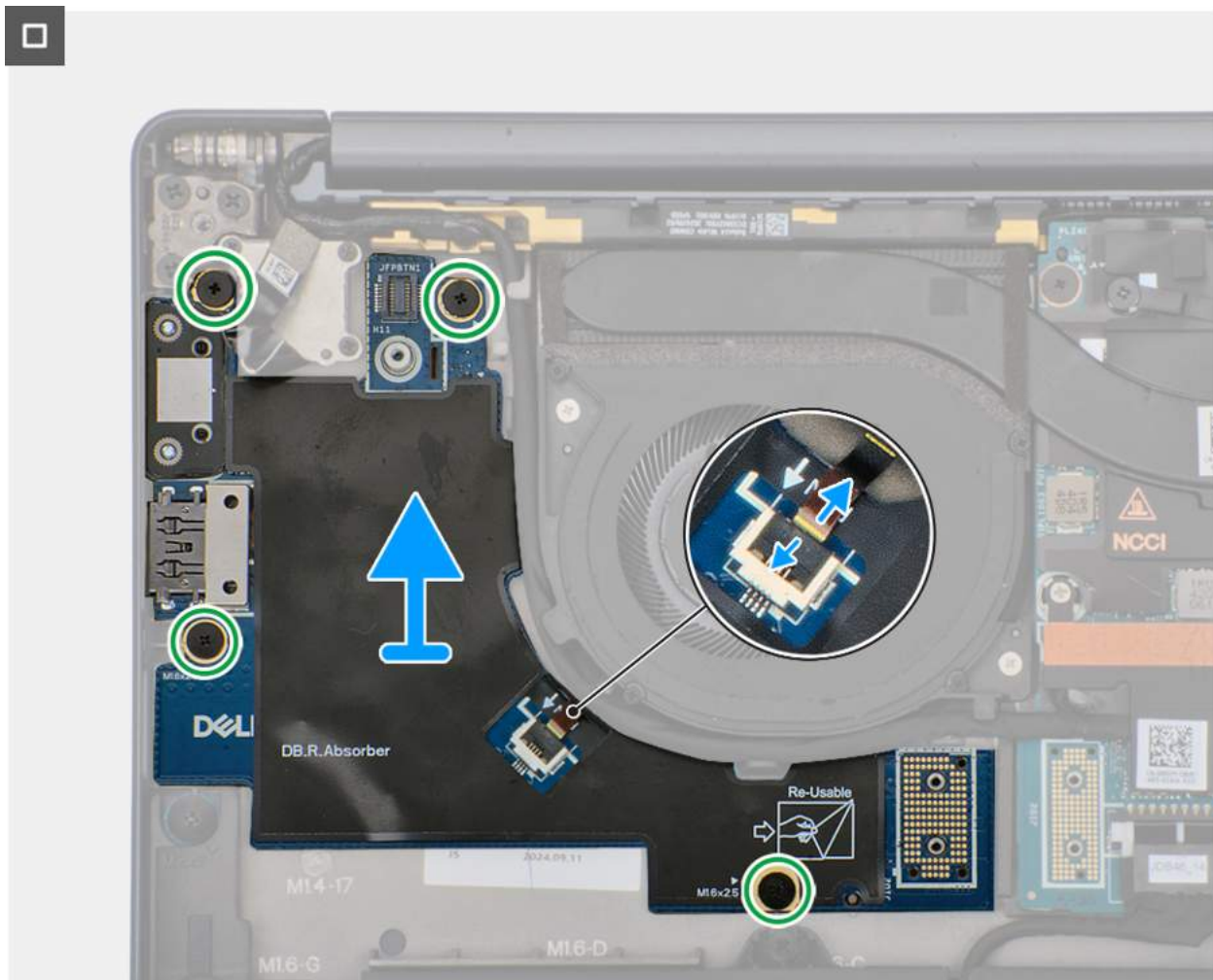
Rysunek 45. Wyjmowanie prawej płyty we/wy (bez anten WWAN)
