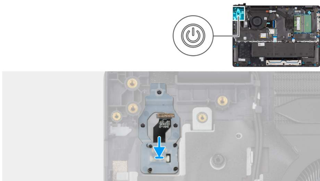
Rysunek 56. Instalowanie przycisku zasilania z czytnikiem linii papilarnych
