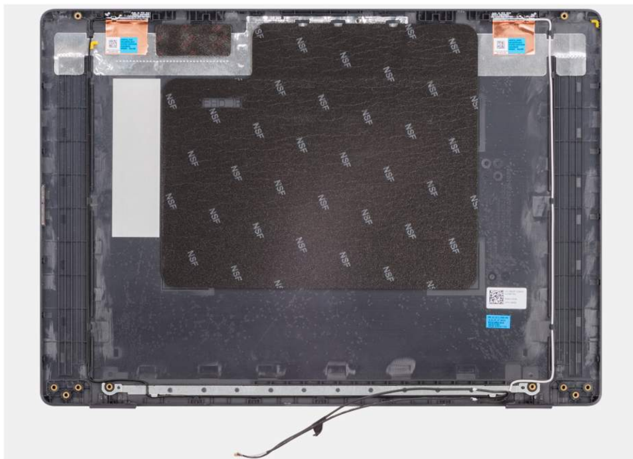
Rysunek 118. Instalowanie zestawu pokrywy tylnej wyświetlacza
