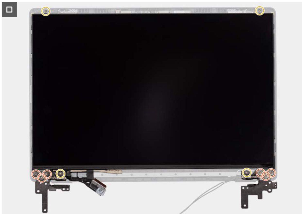
Rysunek 112. Instalowanie zestawu panelu wyświetlacza
