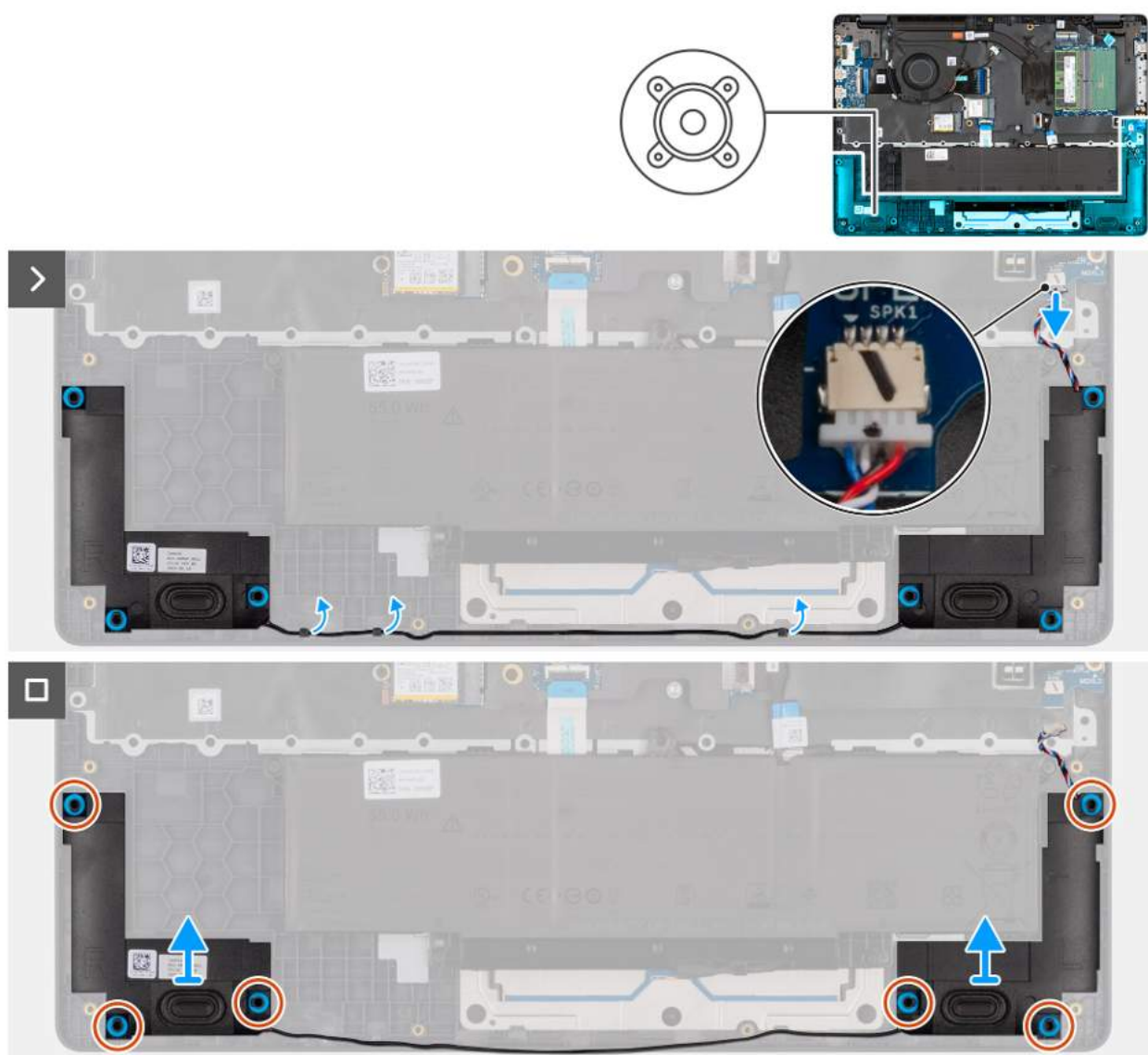
Rysunek 27. Wymontowywanie głośników
