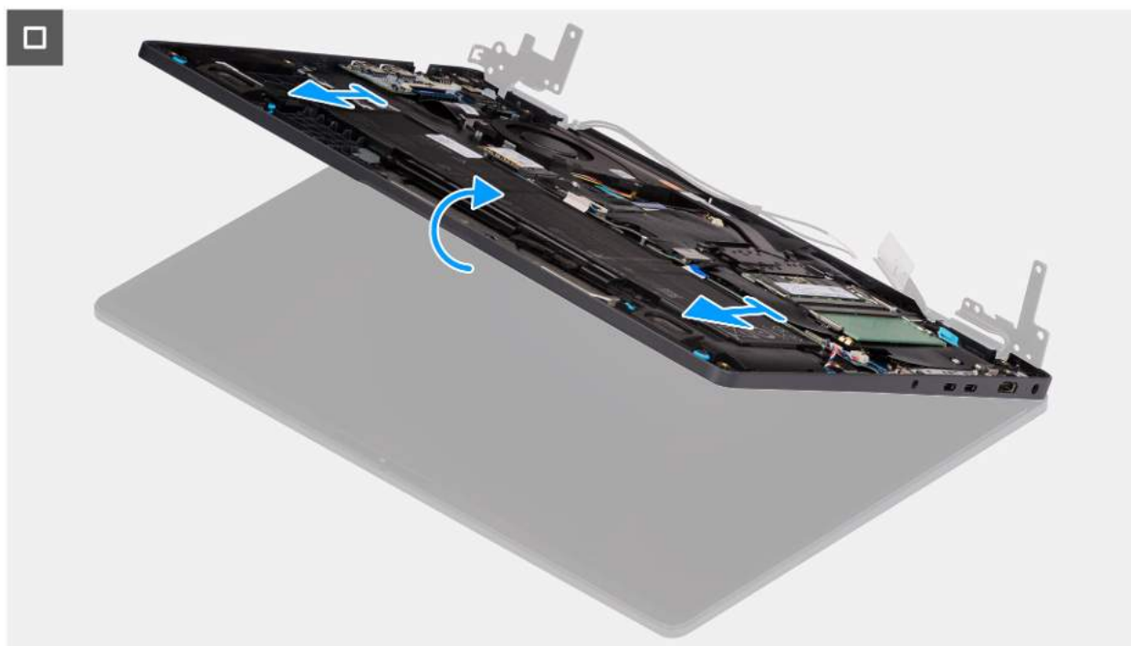
Rysunek 94. Wymontowywanie zestawu wyświetlacza
