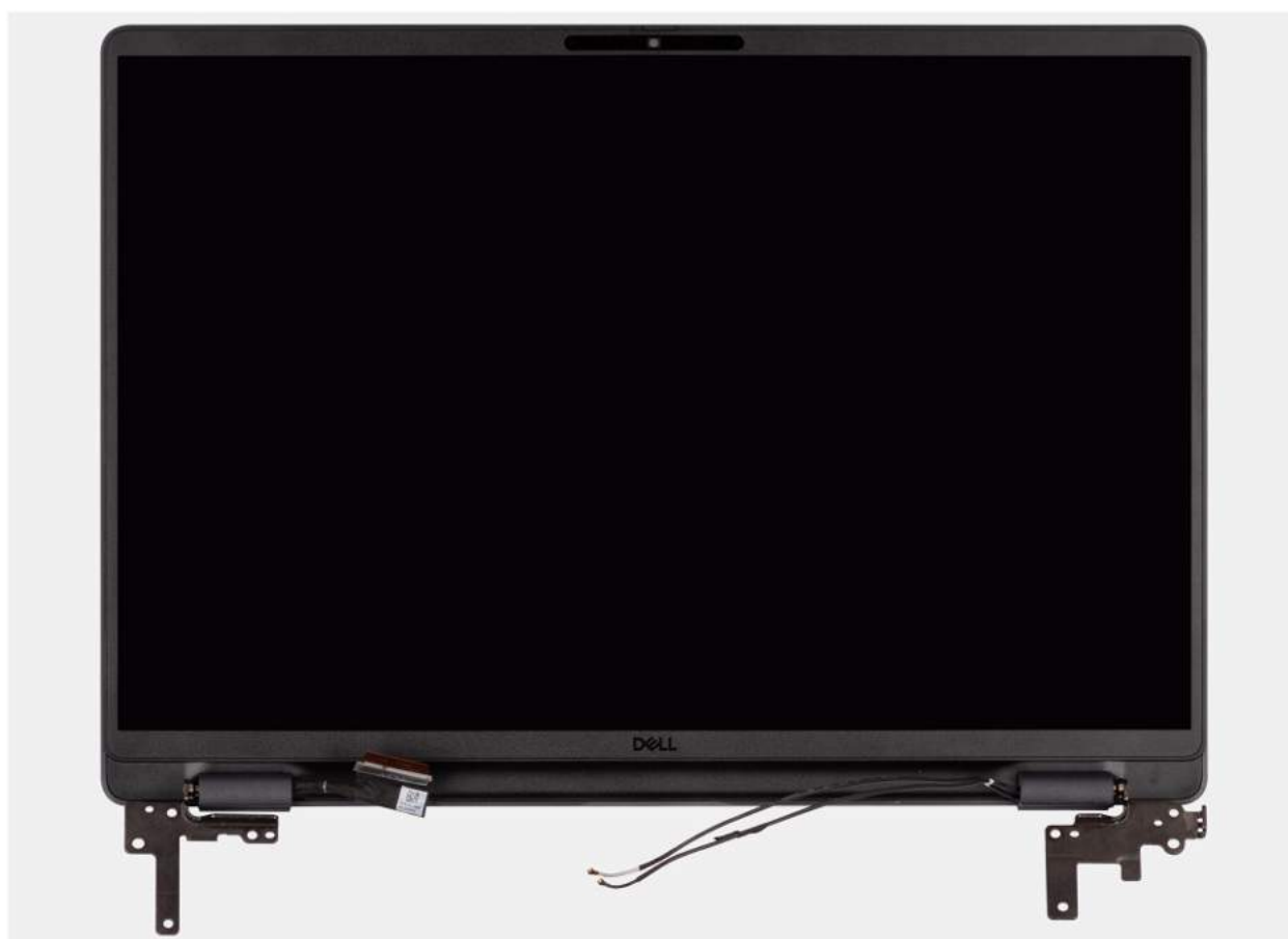
Rysunek 95. Wymontowywanie zestawu wyświetlacza
