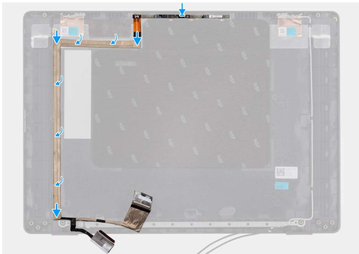
Rysunek 116. Instalowanie kabla eDP
