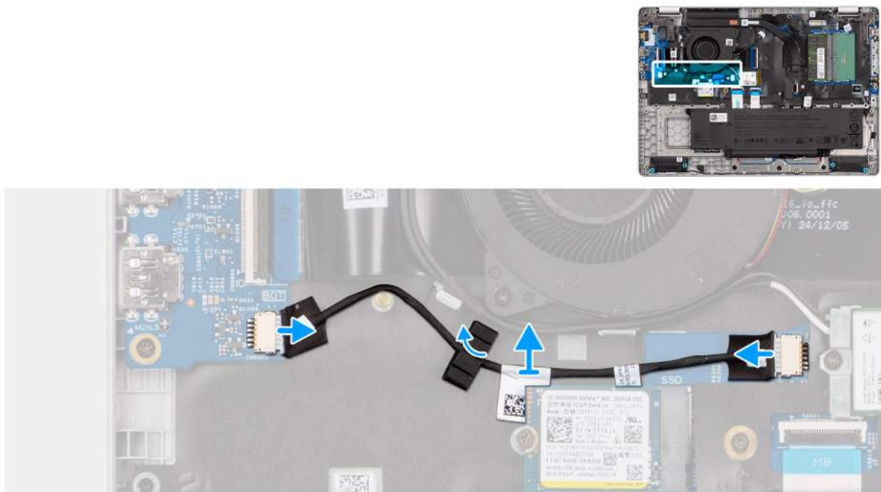
Rysunek 47. Wymontowywanie vPro
