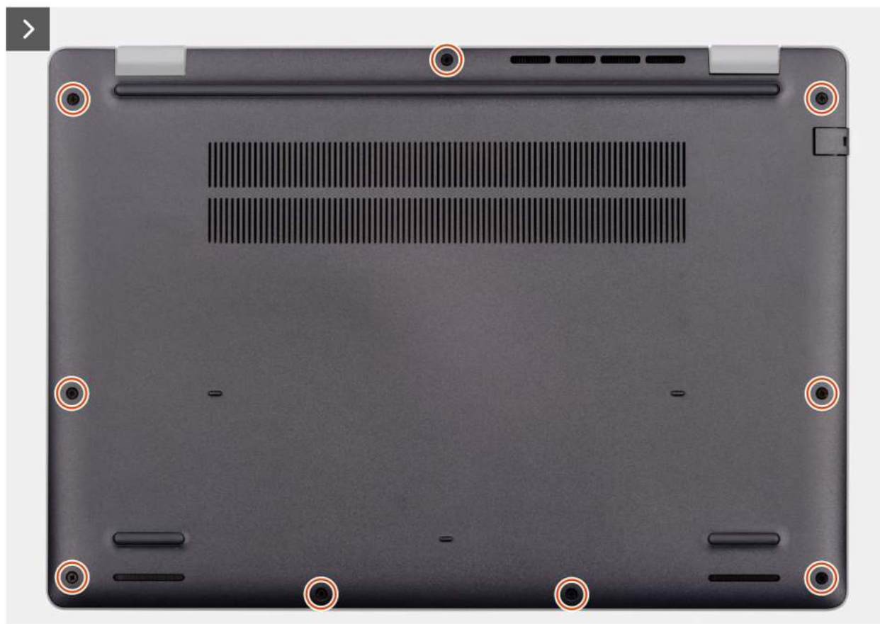
Rysunek 11. Wymontowywanie pokrywy dolnej
