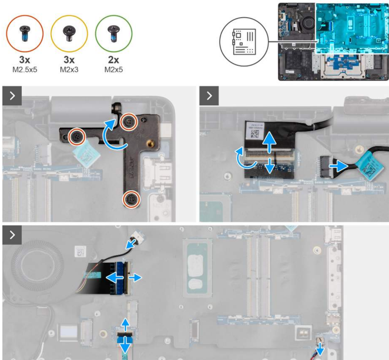
Rysunek 58. Wymontowywanie płyty głównej
