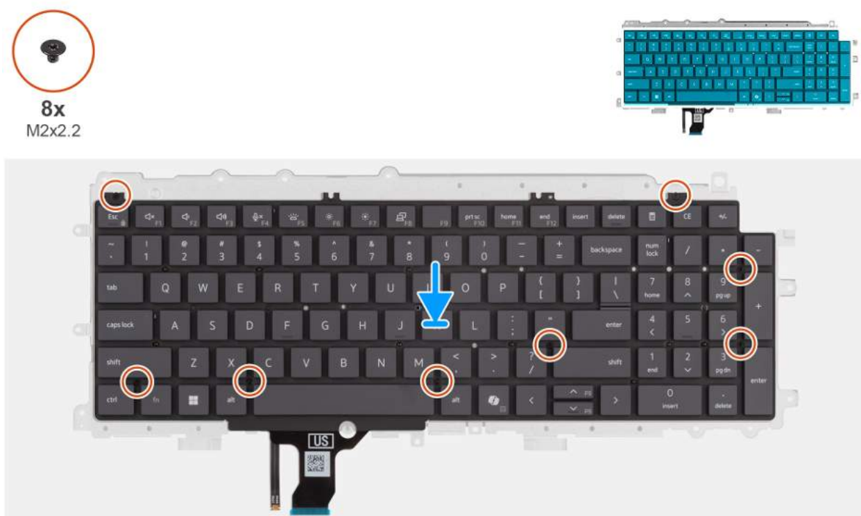
Rysunek 88. Instalowanie płyty nośnej klawiatury
