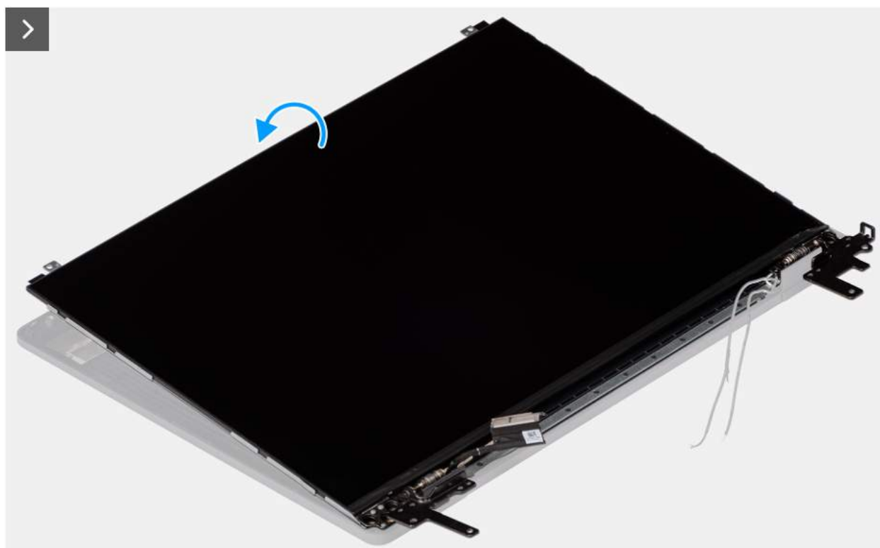
Rysunek 111. Instalowanie zestawu panelu wyświetlacza
