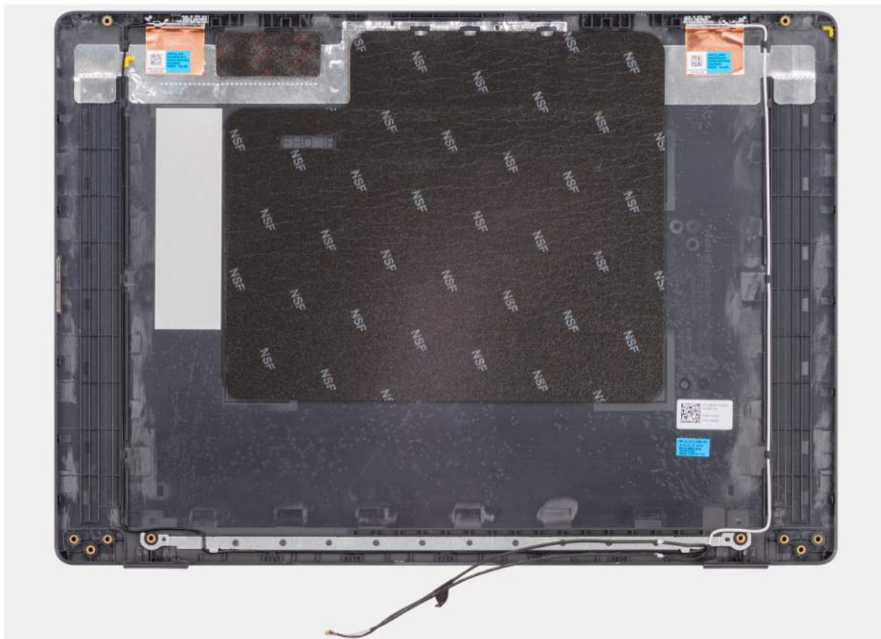
Rysunek 117. Wymontowywanie zestawu pokrywy tylnej wyświetlacza
