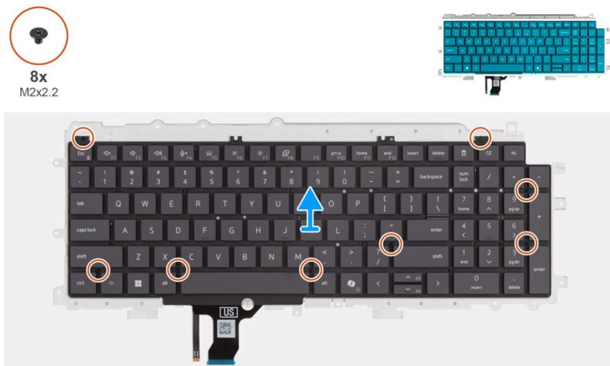
Rysunek 85. Wymontowywanie płyty nośnej klawiatury
