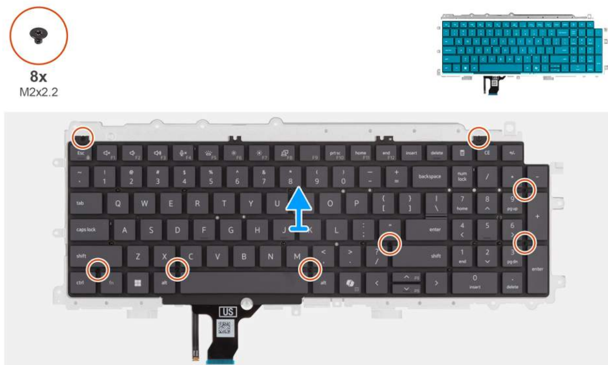
Rysunek 56. Wymontowywanie płyty nośnej klawiatury
