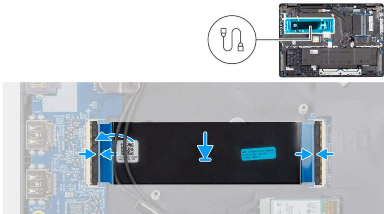
Rysunek 39. Instalowanie płyty we/wy
