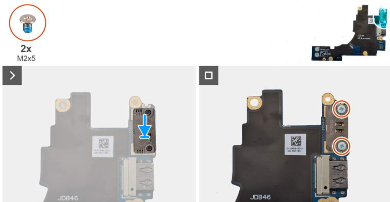
Rysunek 53. Instalowanie lewego modułu USB typu C
