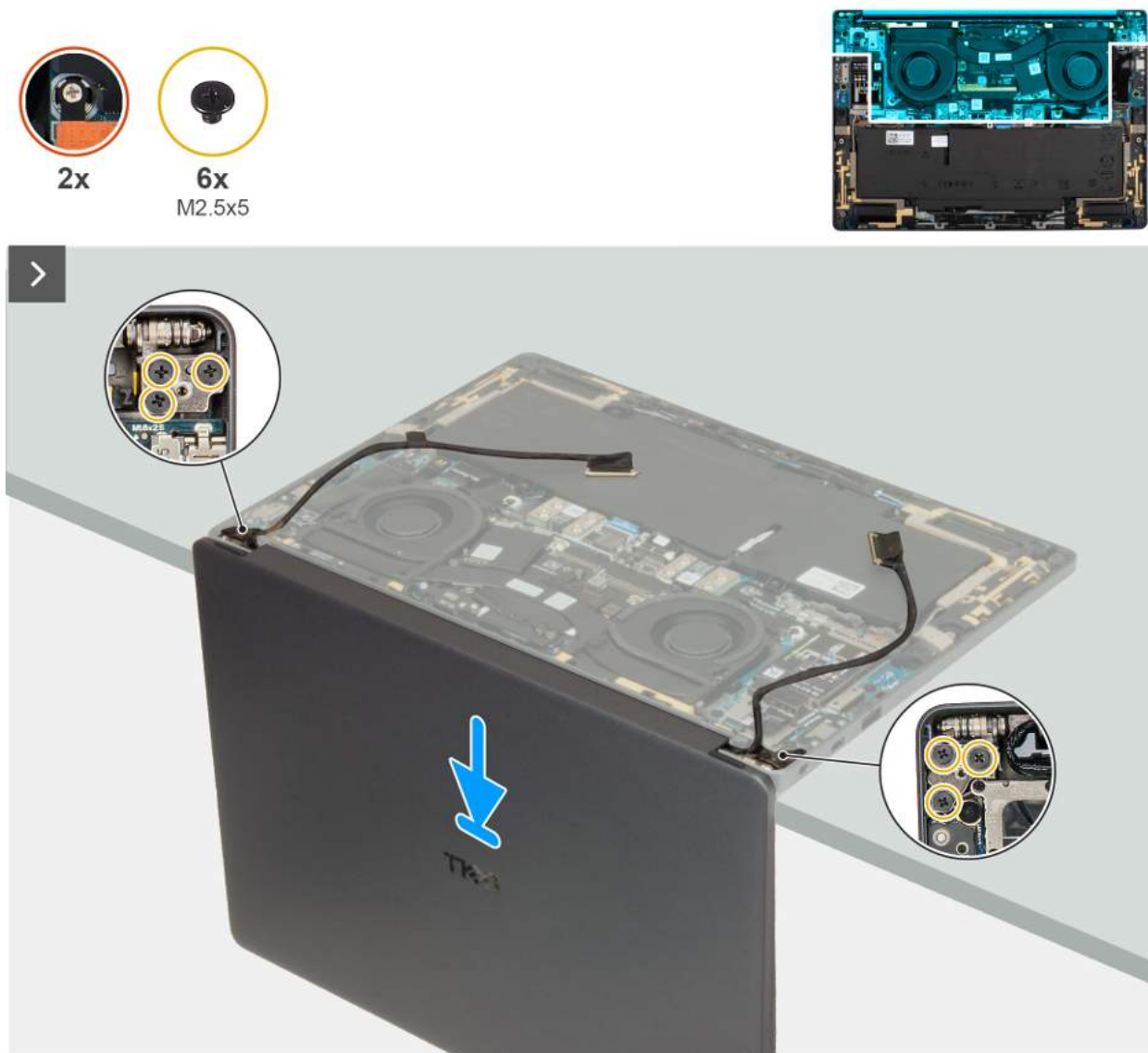
Rysunek 61. Instalowanie zestawu wyświetlacza
