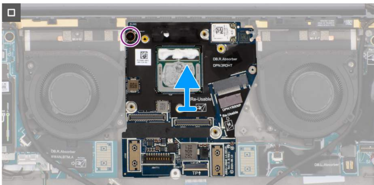
Rysunek 66. Wymontowywanie płyty głównej
