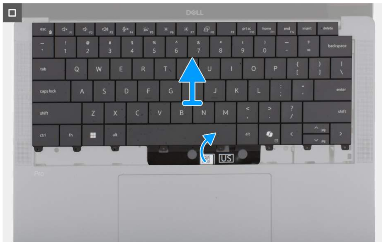
Rysunek 74. Wymontowywanie zestawu klawiatury
