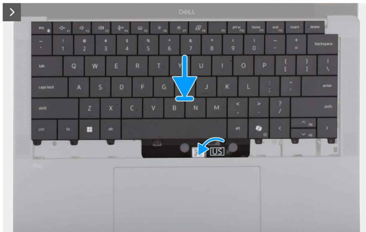
Rysunek 75. Instalowanie zestawu klawiatury
