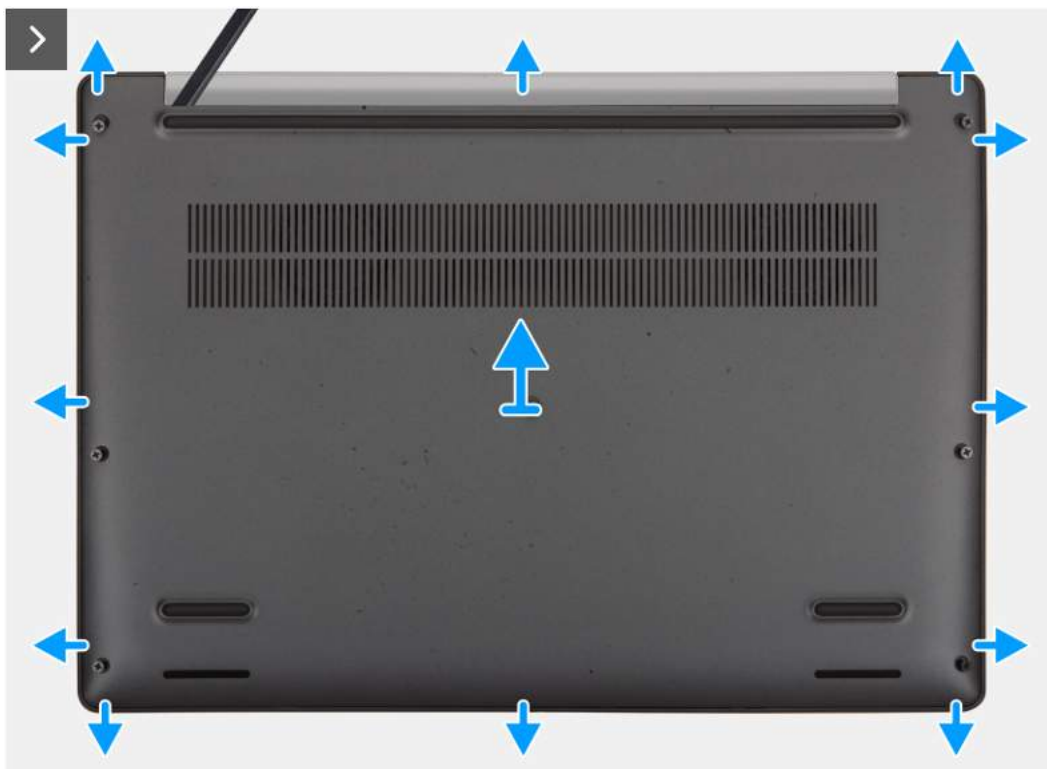
Rysunek 17. Wymontowywanie pokrywy dolnej
