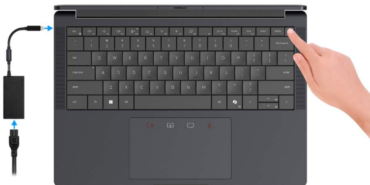
Rysunek 8. Podłącz zasilacz i naciśnij przycisk zasilania.
