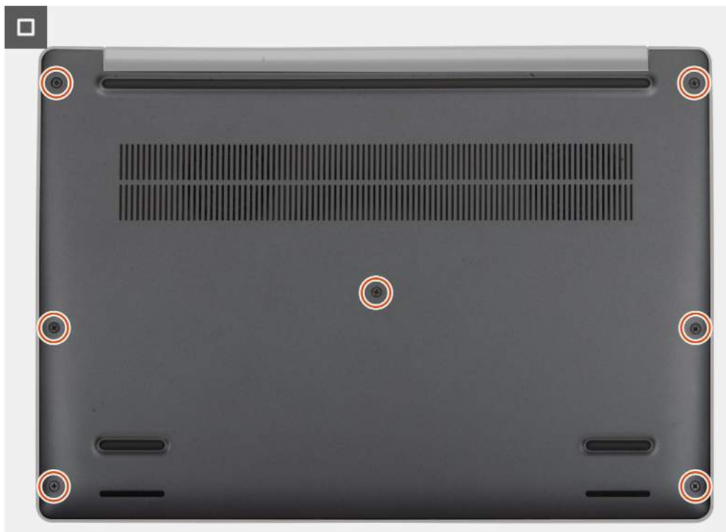
Rysunek 21. Dokręcanie śrub mocujących
