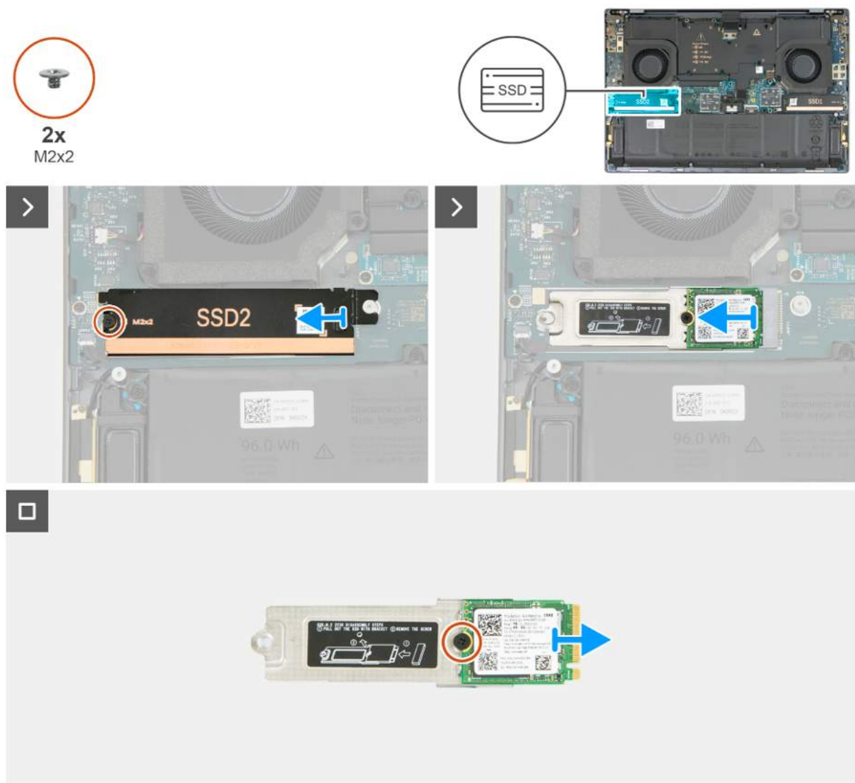
Rysunek 27. Wymontowywanie dysku SSD M.2 2230 (SSD2)
