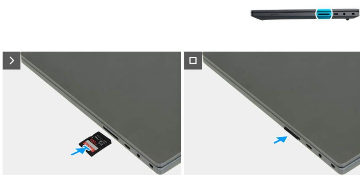
Rysunek 12. Instalowanie karty pamięci
