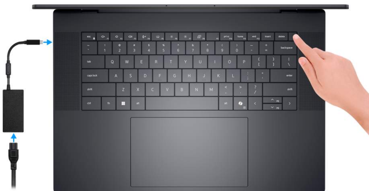
Rysunek 8. Podłącz zasilacz i naciśnij przycisk zasilania
