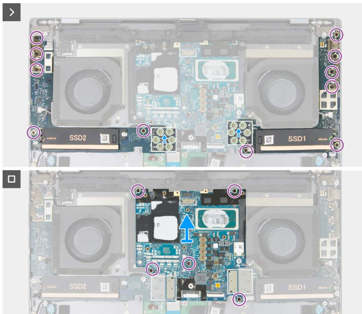
Rysunek 56. Wymontowywanie płyty głównej (zintegrowana karta graficzna)
