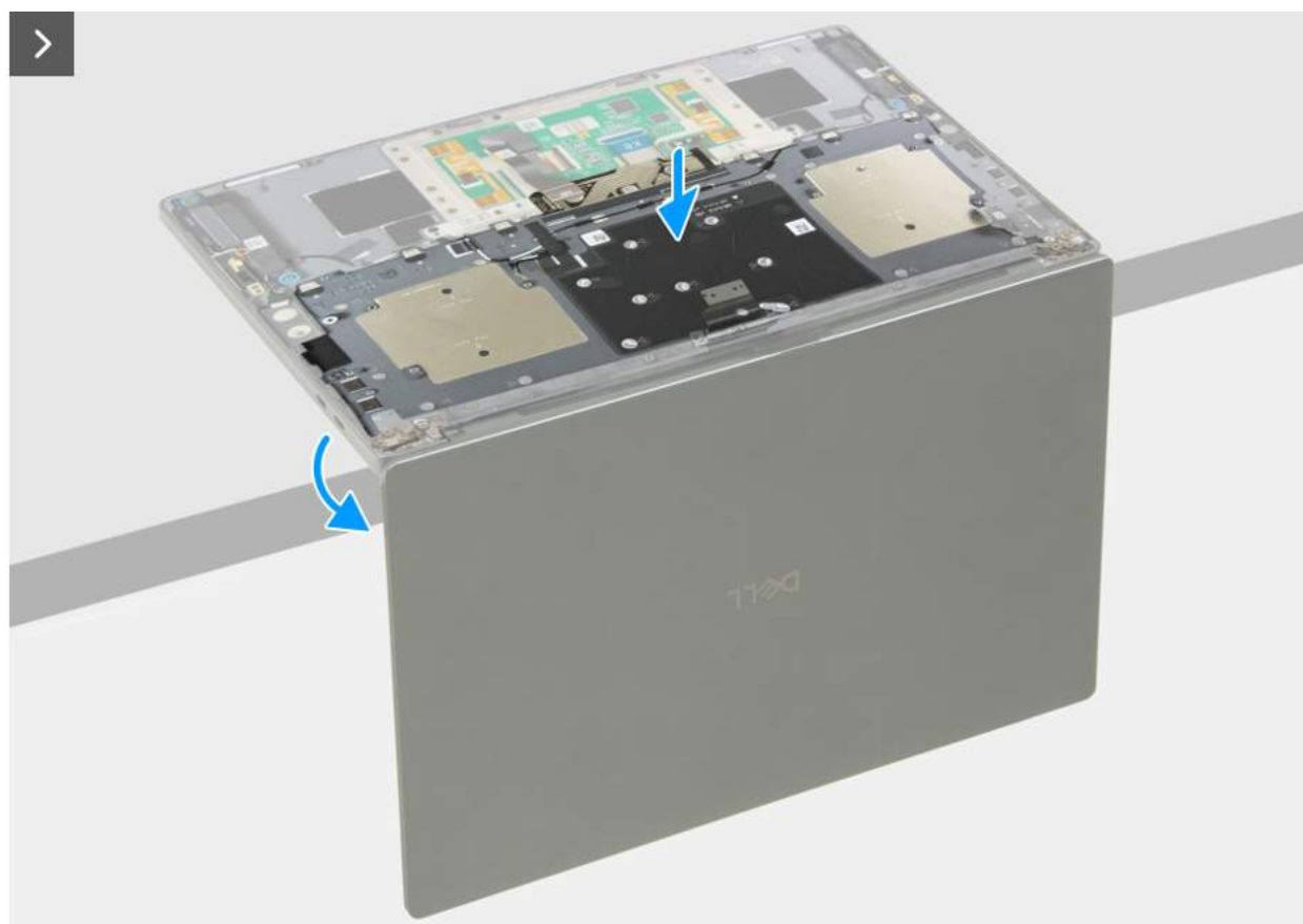
Rysunek 75. Instalowanie klawiatury
