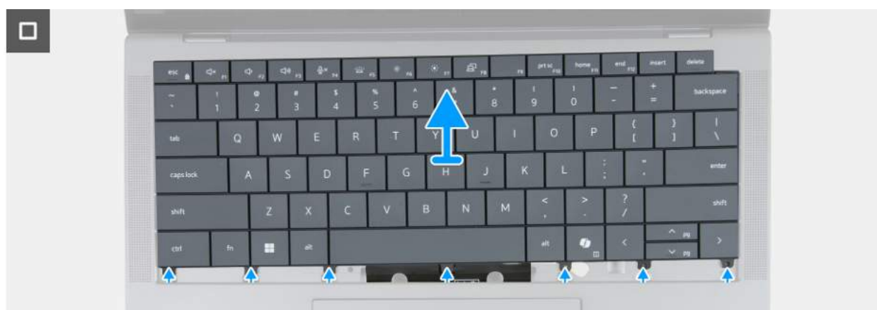
Rysunek 72. Wymontowywanie klawiatury
