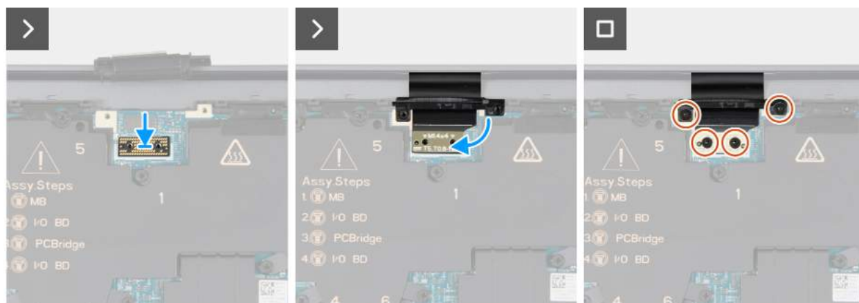
Rysunek 39. Instalowanie zestawu wyświetlacza
