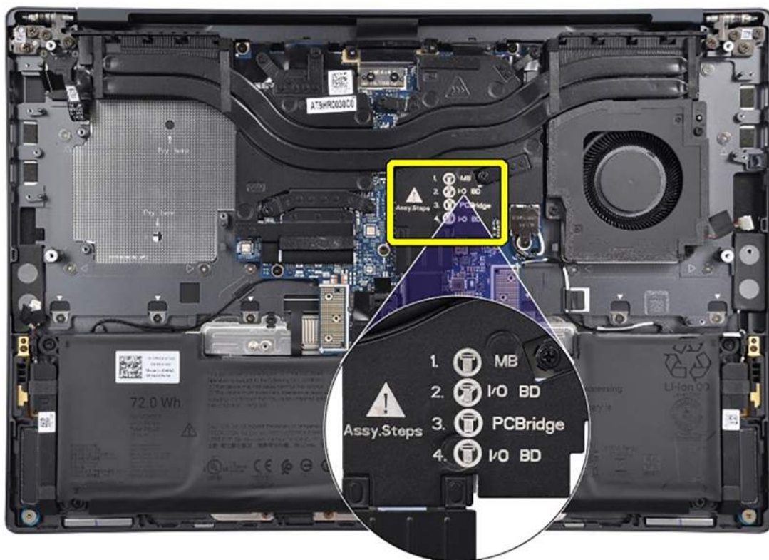
Rysunek 61. Kroki montażowe nadrukowane na radiatorze
