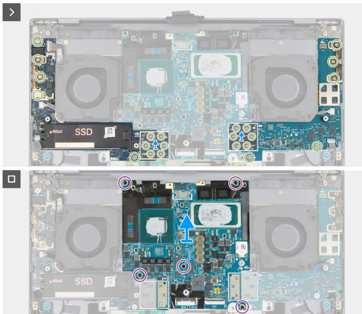
Rysunek 60. Wymontowywanie płyty głównej (autonomiczna karta graficzna)
