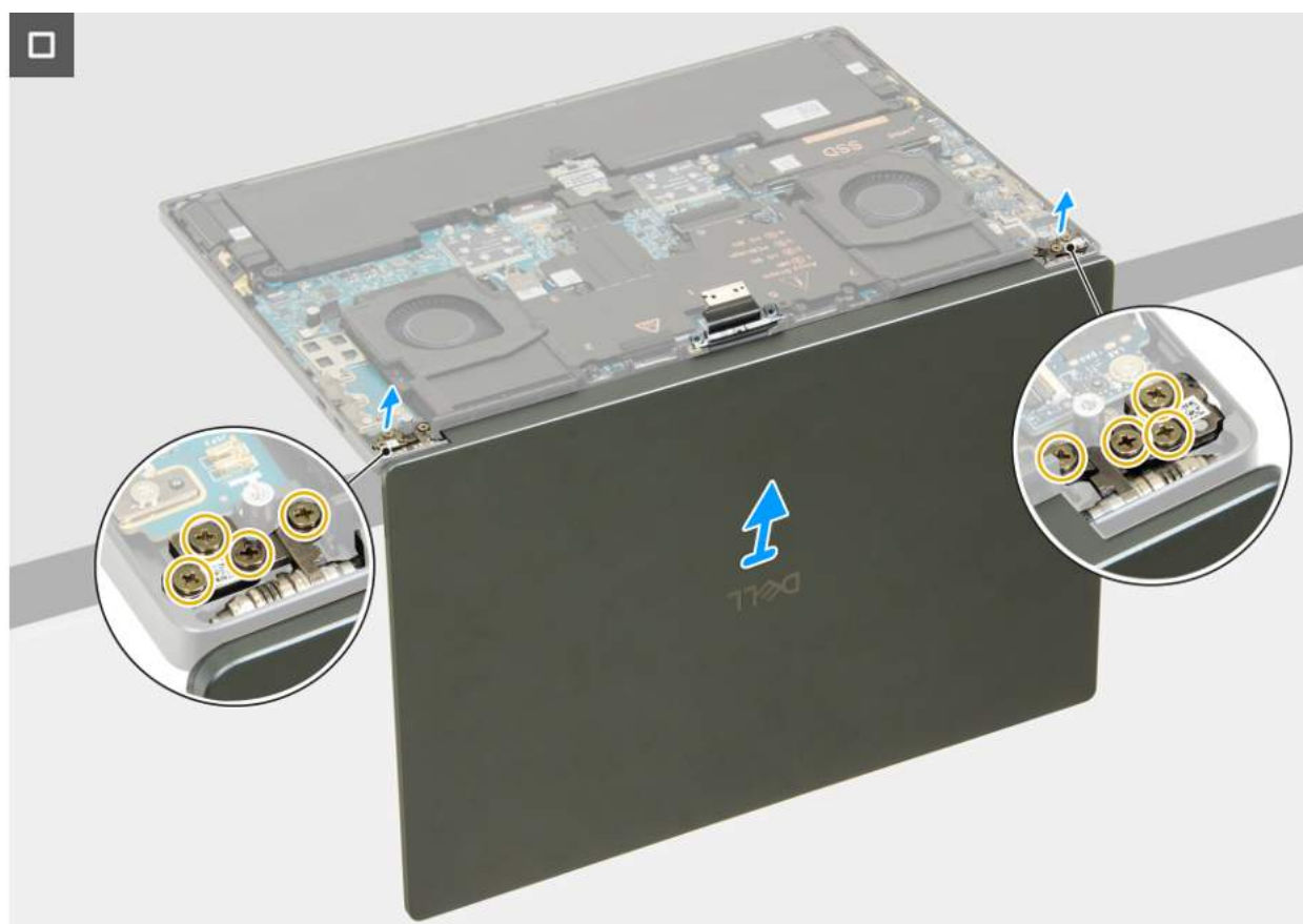
Rysunek 32. Wymontowywanie zestawu wyświetlacza
