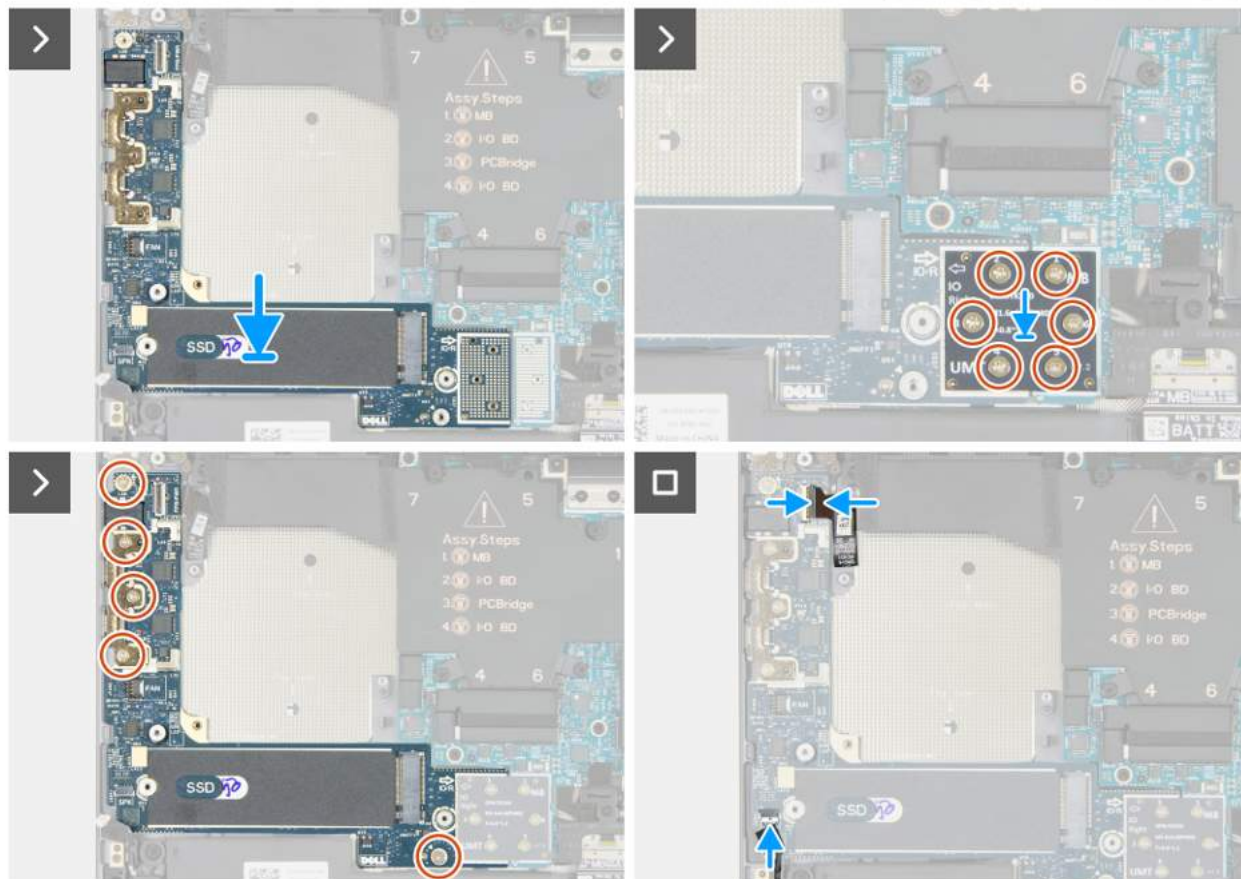
Rysunek 48. Instalowanie prawej płyty we/wy
