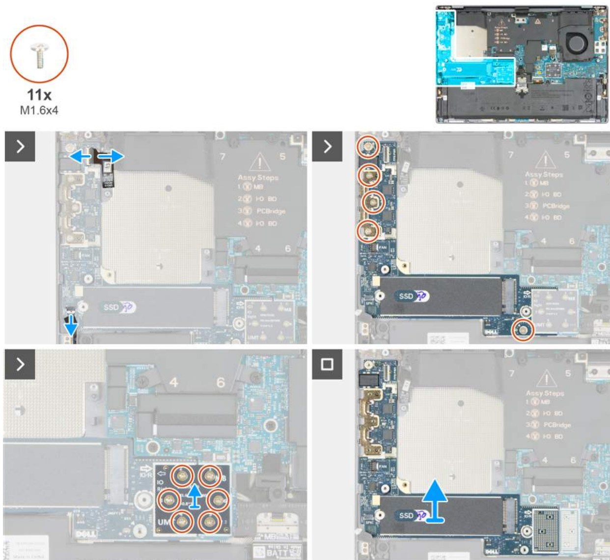
Rysunek 47. Wymontowywanie prawej płyty we/wy
