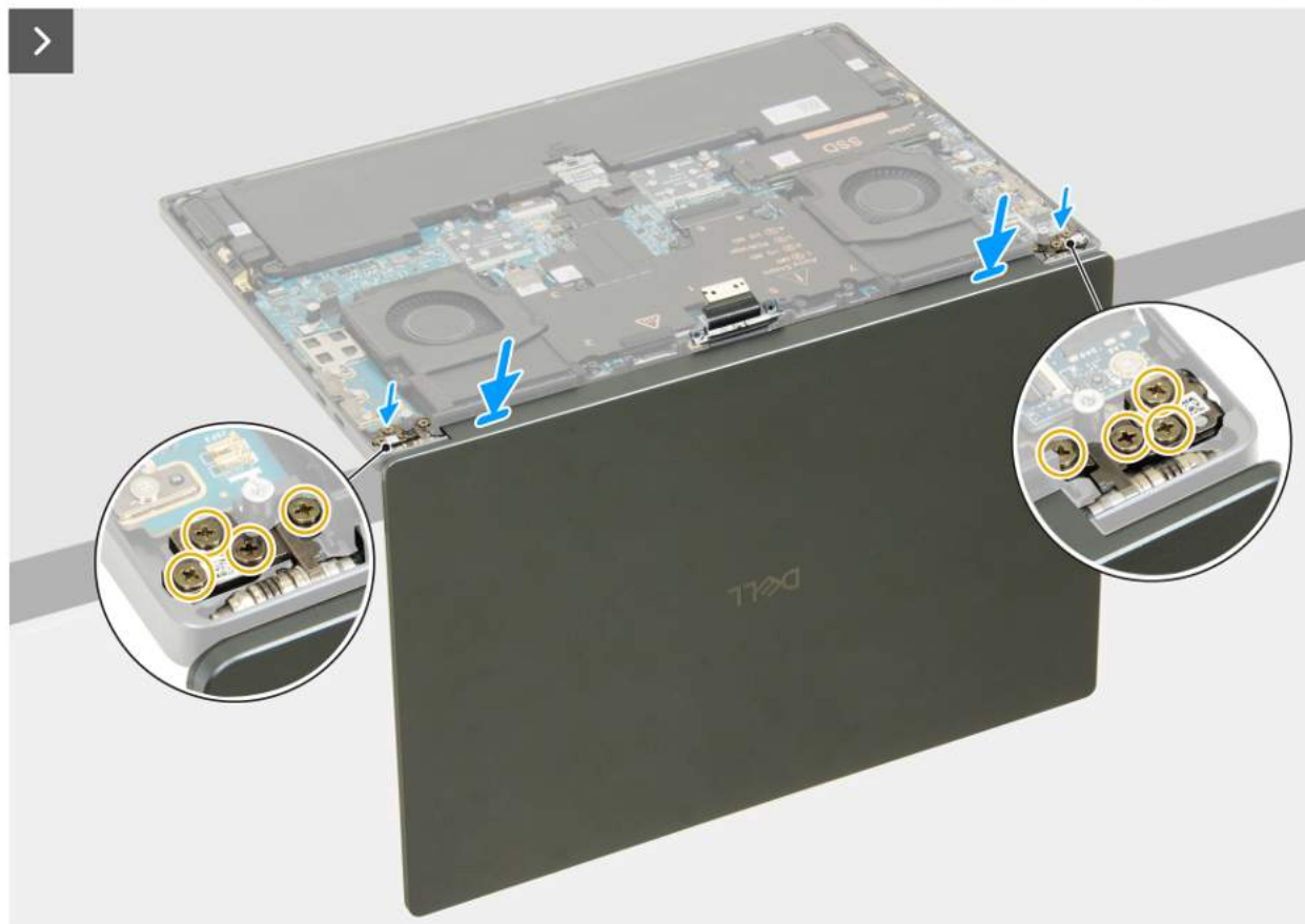
Rysunek 38. Instalowanie zestawu wyświetlacza
