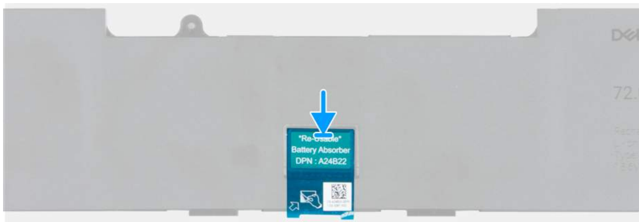
Rysunek 20. Instalowanie pochłaniacza baterii
