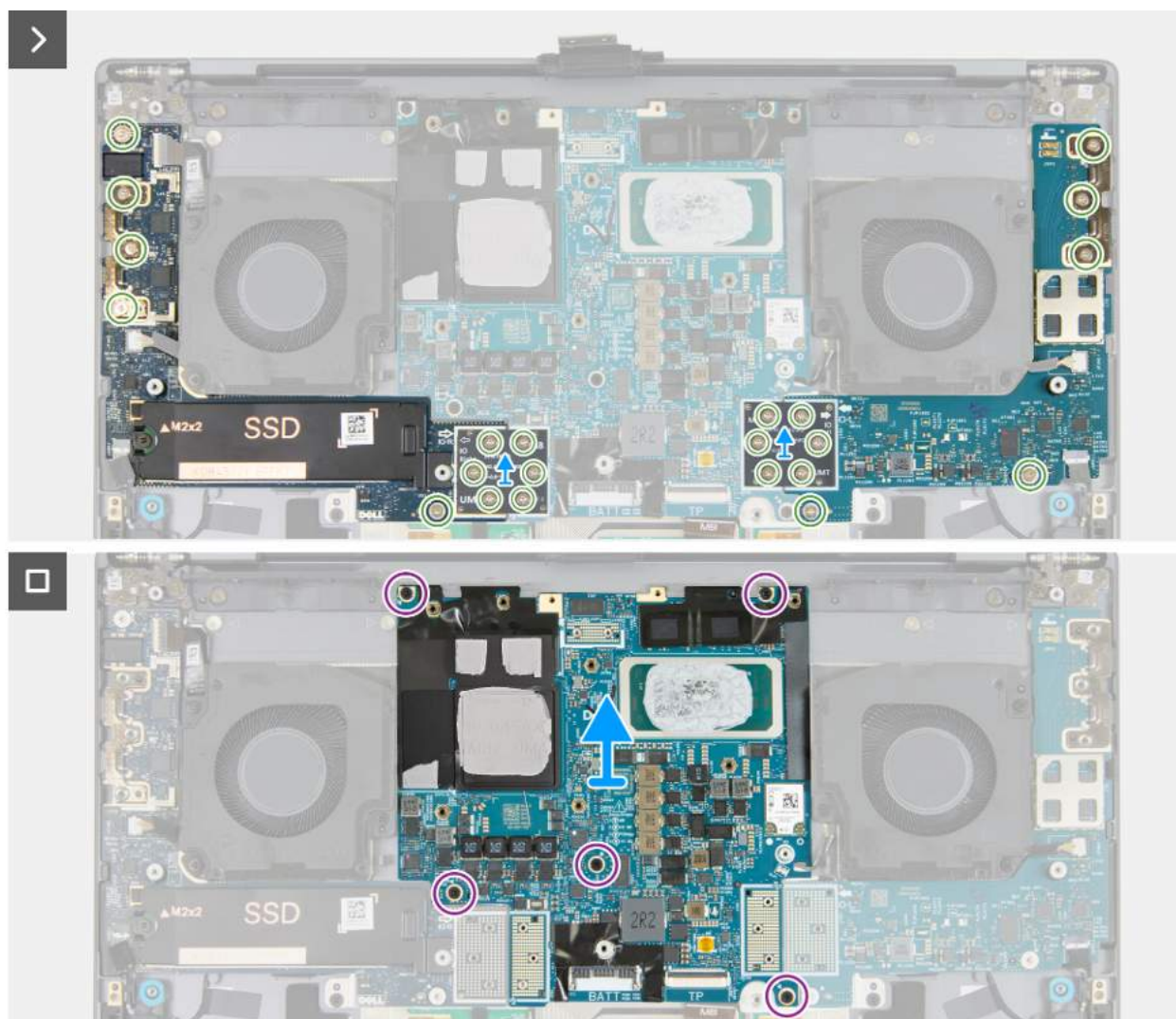
Rysunek 51. Wymontowywanie płyty głównej (zintegrowana karta graficzna)
