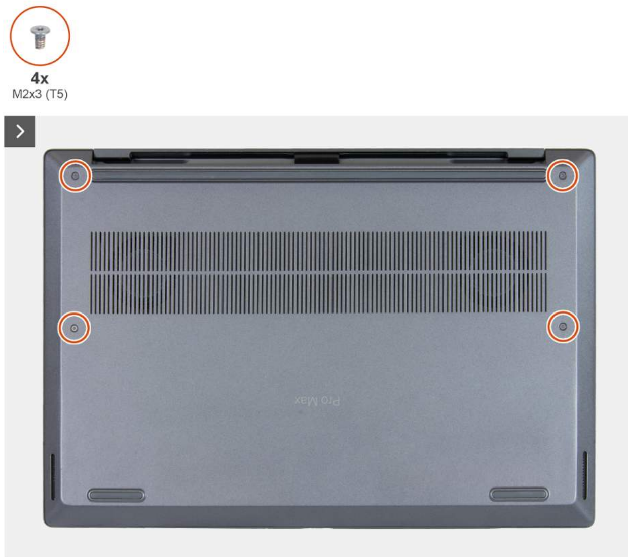
Rysunek 12. Wymontowywanie pokrywy dolnej
