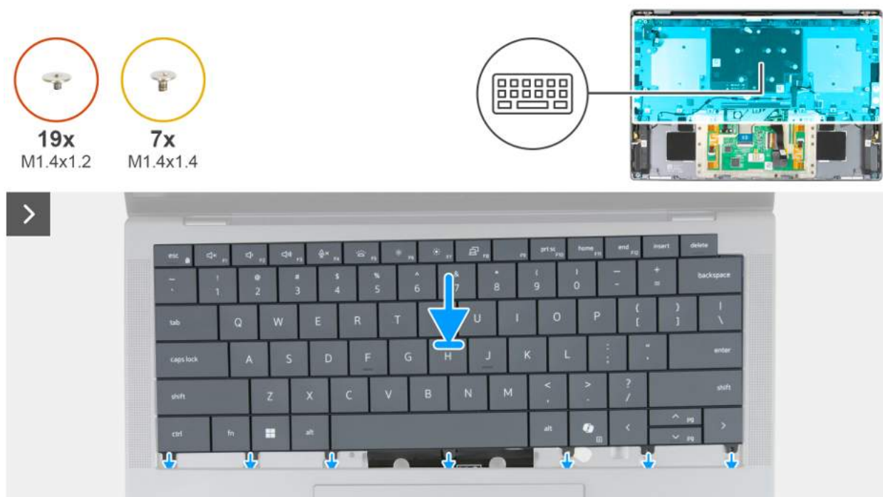
Rysunek 74. Instalowanie klawiatury
