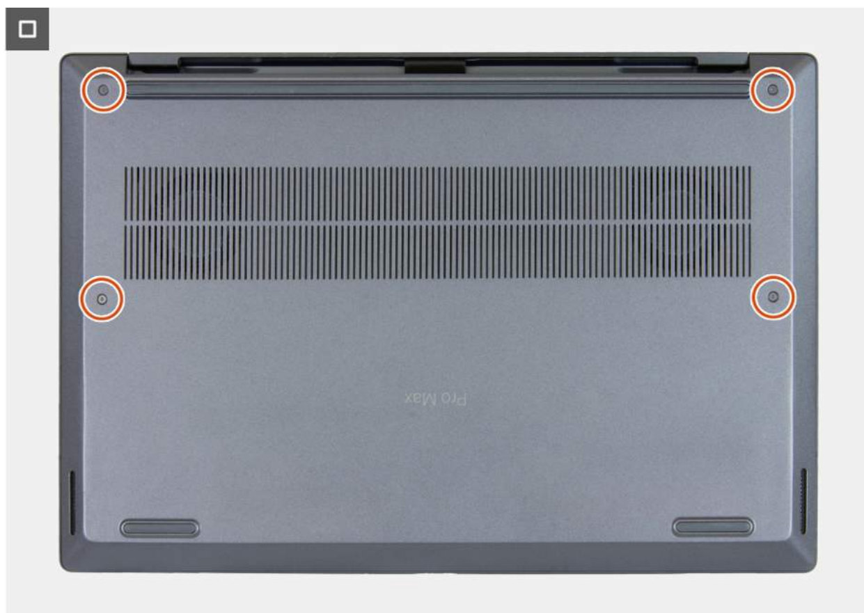
Rysunek 15. Instalowanie pokrywy dolnej
