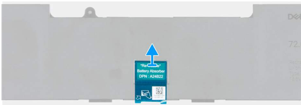
Rysunek 18. Wymontowywanie pochłaniacza baterii
