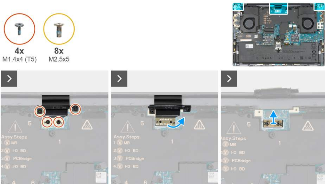
Rysunek 31. Wymontowywanie zestawu wyświetlacza
