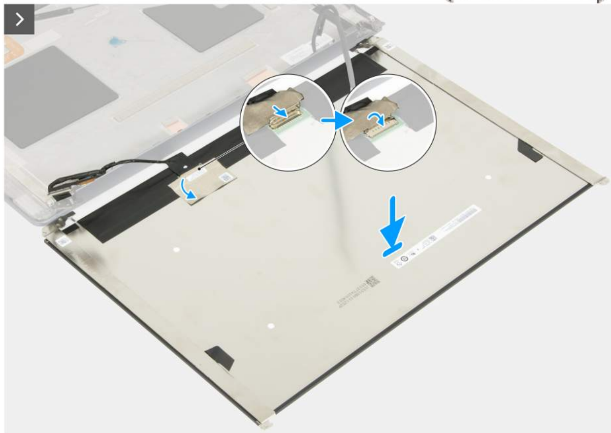
Rysunek 97. Instalowanie wyświetlacza
