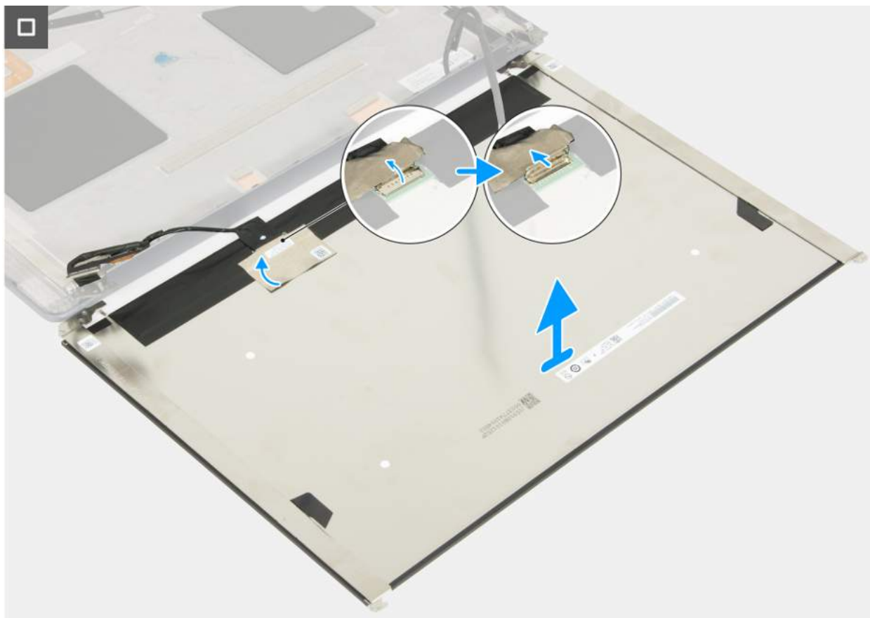
Rysunek 96. Wymontowywanie wyświetlacza
