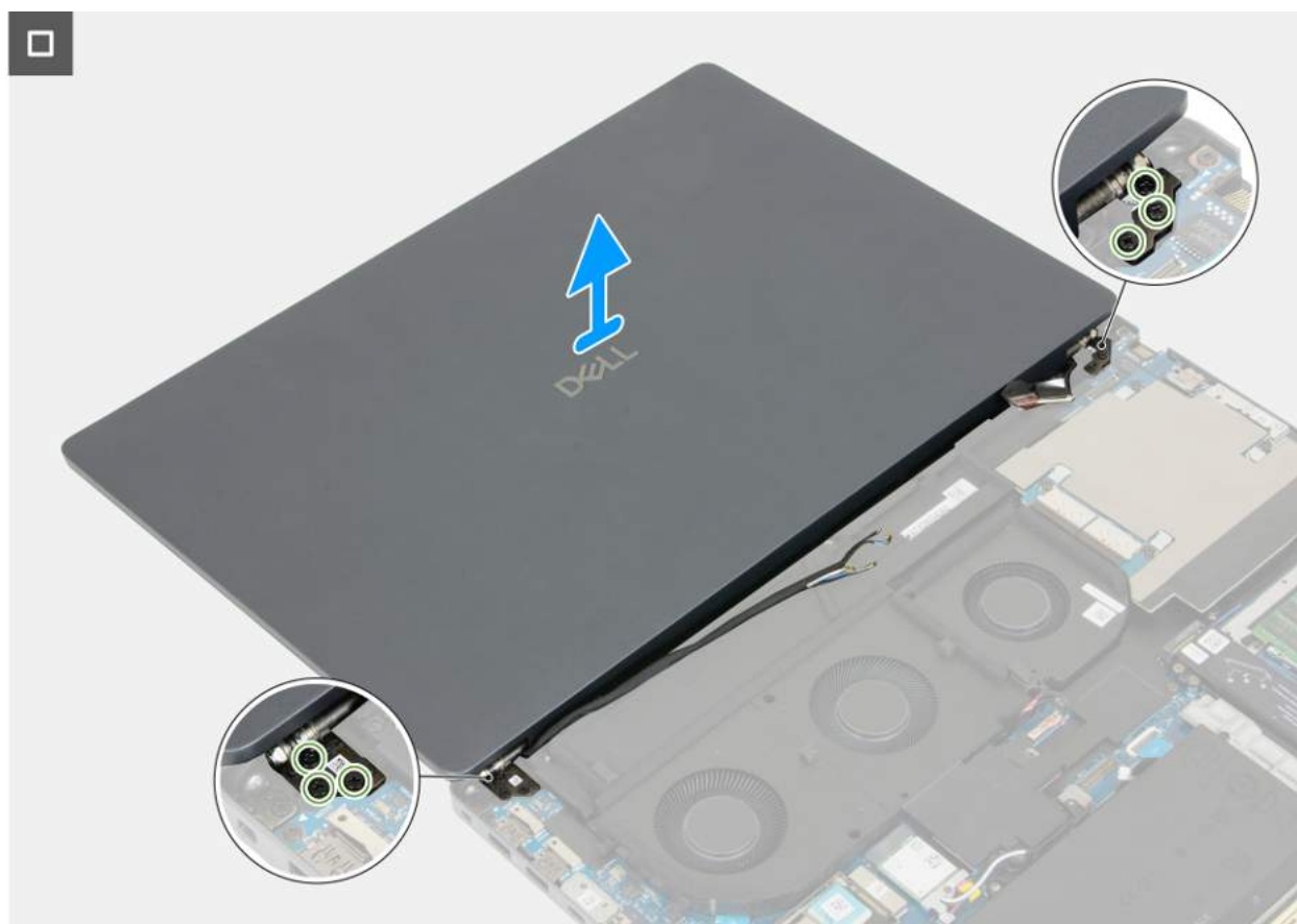
Rysunek 64. Wymontowywanie zestawu wyświetlacza
