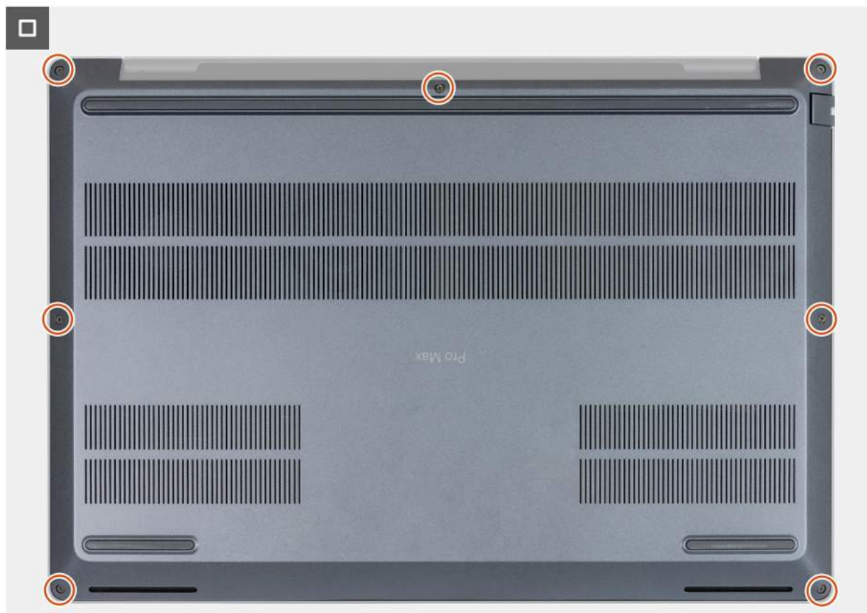
Rysunek 29. Dokręcanie mocujących
