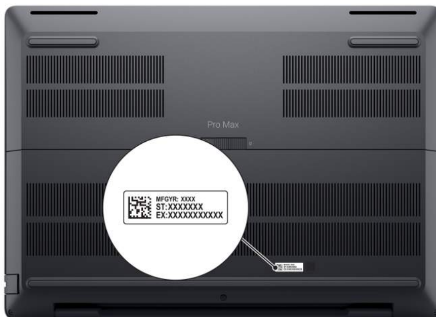
Rysunek 6. Lokalizacja etykiety z kodem Service Tag / kodem obsługi ekspresowej
