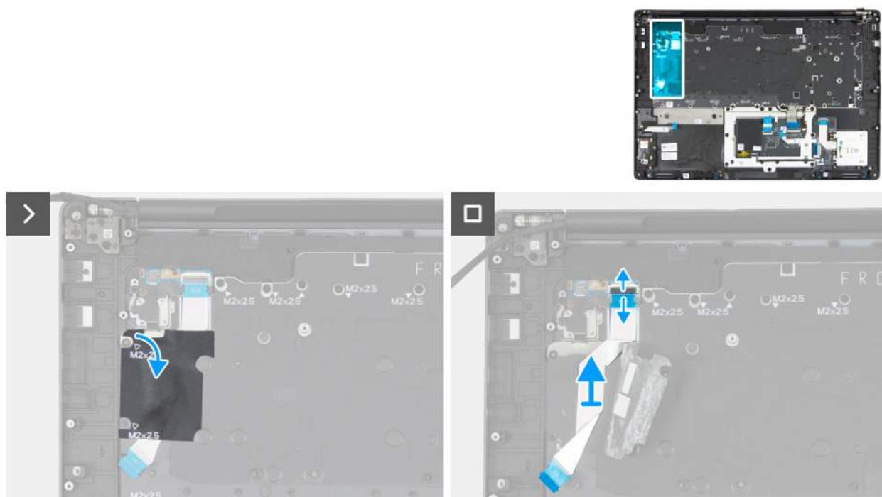
Rysunek 123. Wymontowywanie kabla płyty przycisku zasilania
