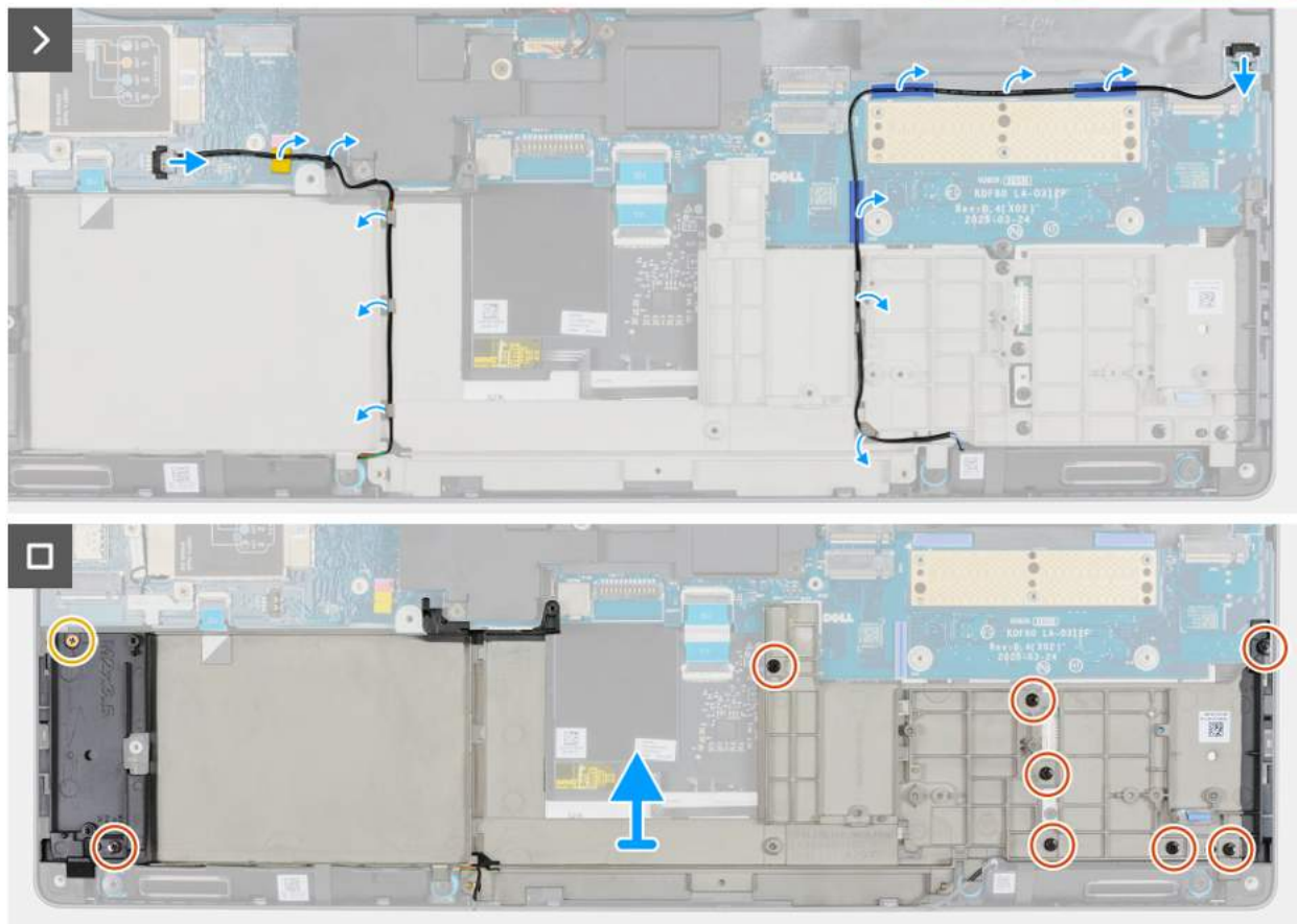
Rysunek 79. Wymontowywanie ramy wewnętrznej
