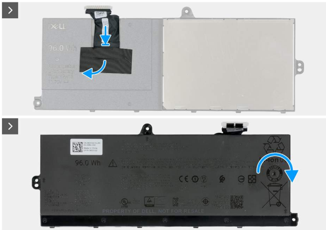
Rysunek 46. Wymiana kabla baterii
