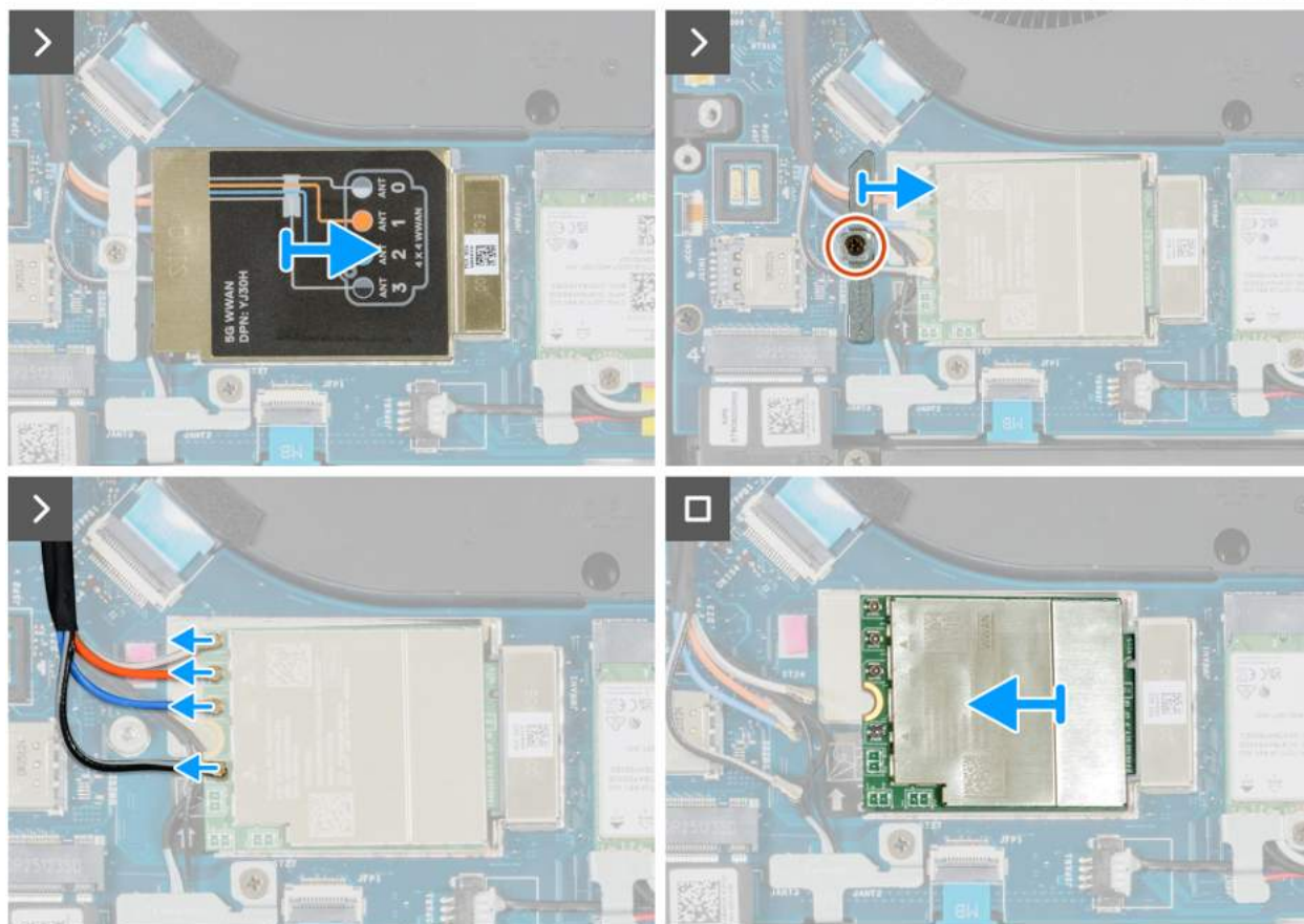
Rysunek 52. Wymontowywanie karty sieci WWAN
