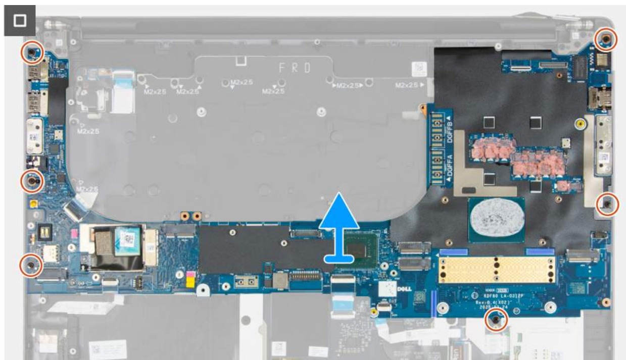
Rysunek 108. Wymontowywanie płyty głównej
