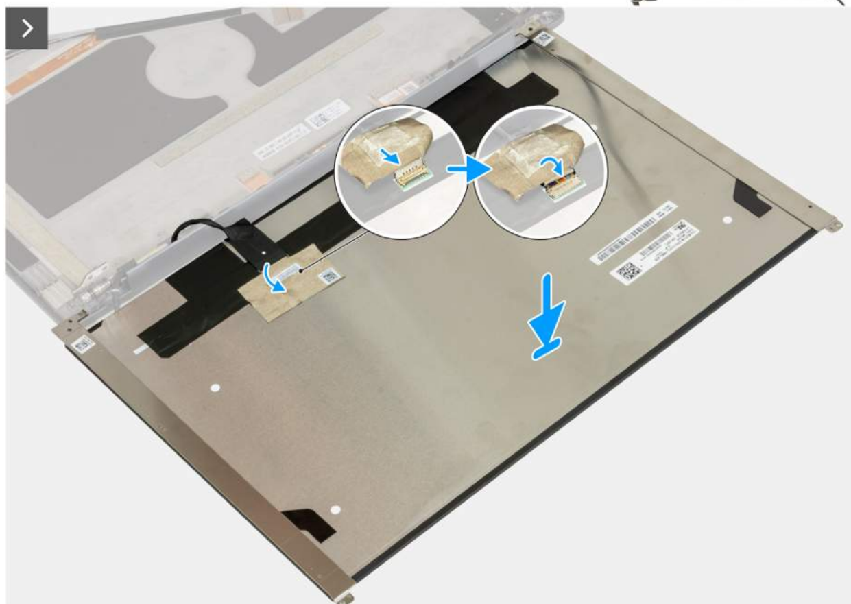
Rysunek 93. Instalowanie panelu wyświetlacza dla ekranów dotykowych
