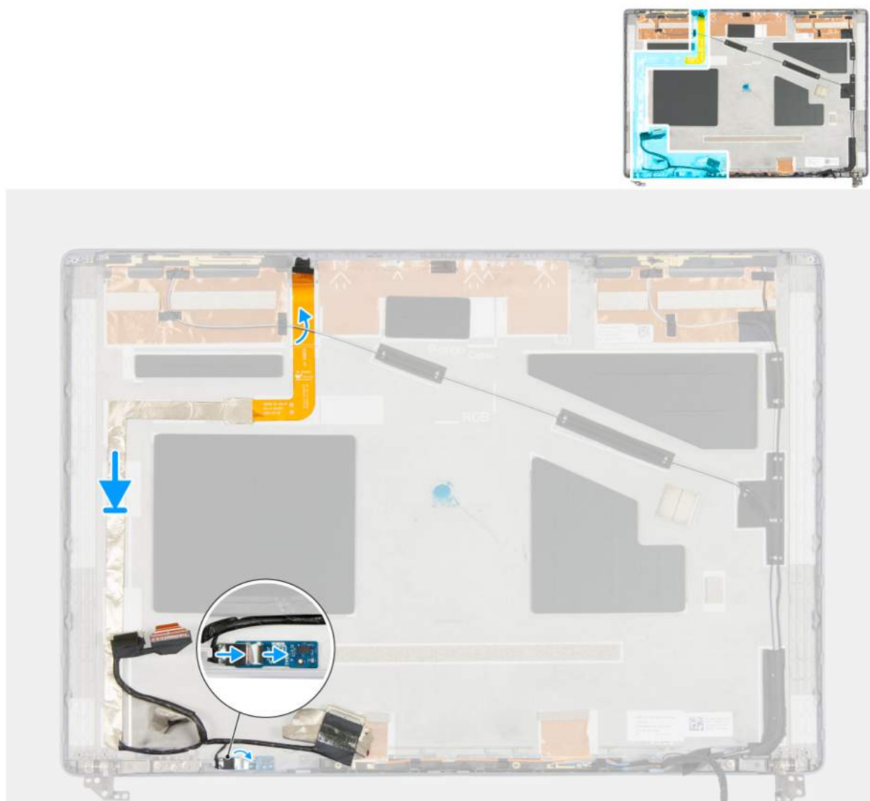
Rysunek 103. Instalowanie kabla wyświetlacza
