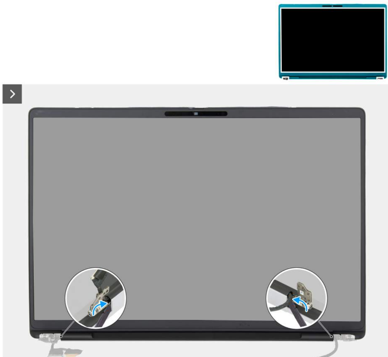
Rysunek 83. Wymontowywanie ramki wyświetlacza
