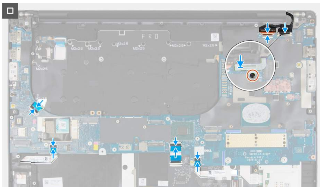
Rysunek 112. Instalowanie płyty głównej
