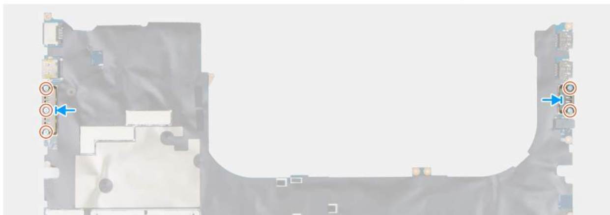
Rysunek 114. Instalowanie modułu złącza USB Type-C
