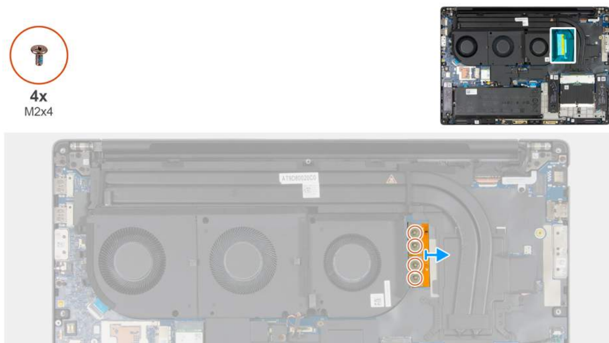
Rysunek 57. Wymontowanie zintegrowanego złącza płaskiego FPC
