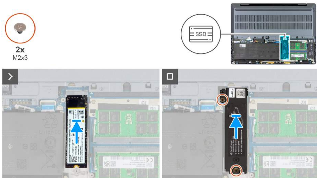
Rysunek 39. Instalowanie dysku SSD M.2 2280 w gnieździe 2 (SSD2)
