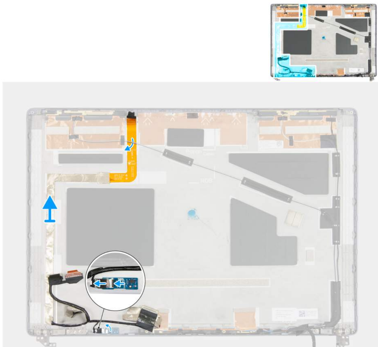
Rysunek 102. Wymontowywanie kabla wyświetlacza
