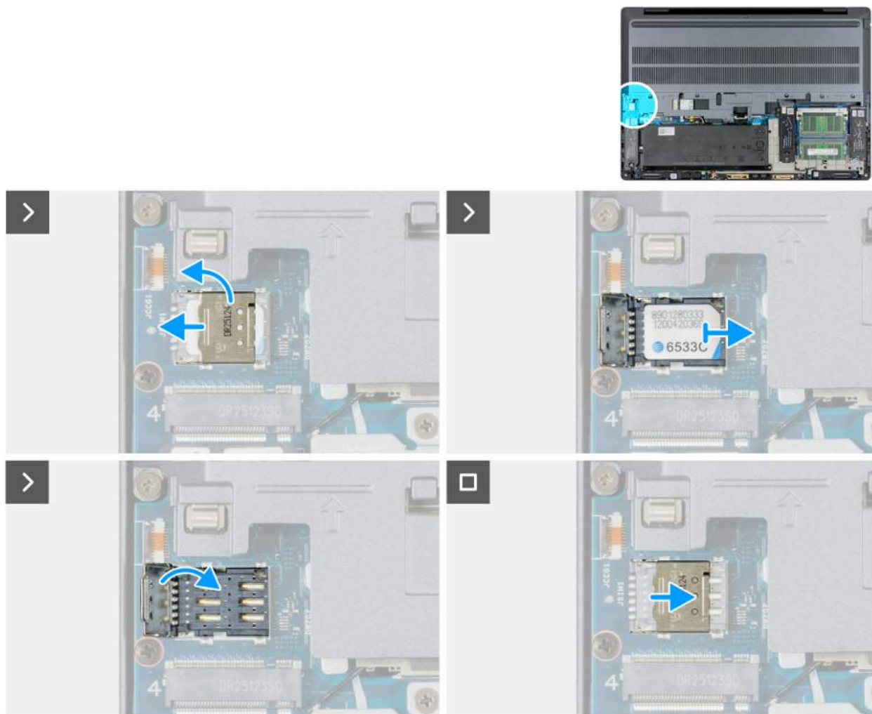
Rysunek 50. Wymontowywanie karty sieci SIM
