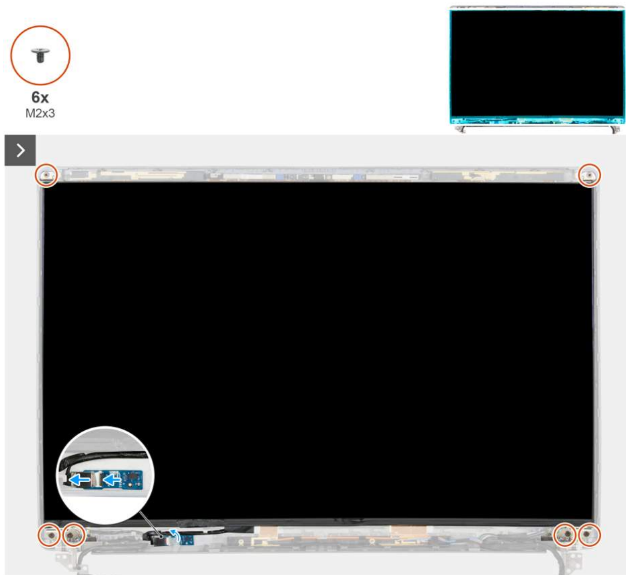
Rysunek 95. Wymontowywanie wyświetlacza
