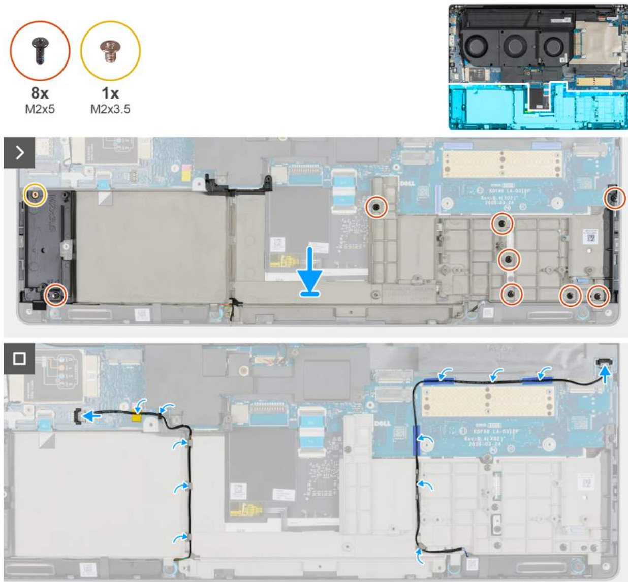
Rysunek 80. Instalowanie ramy wewnętrznej
