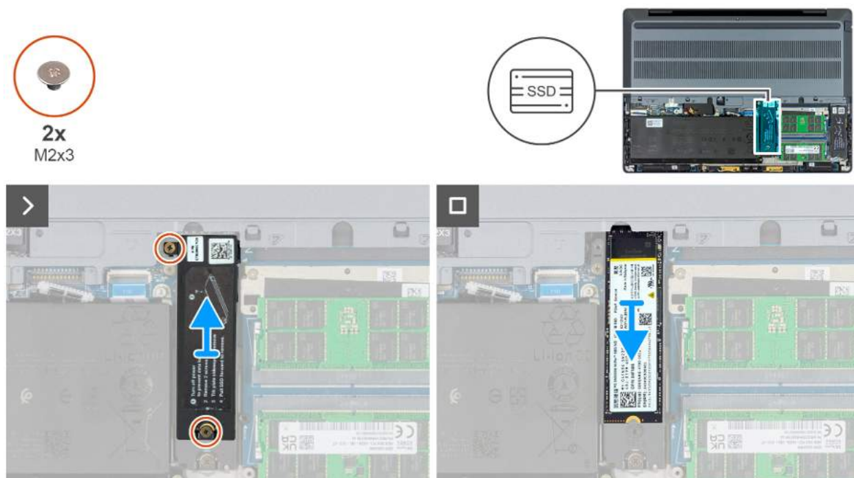
Rysunek 36. Wymontowywanie dysku SSD M.2 2280 z gniazda 3 (SSD3)
