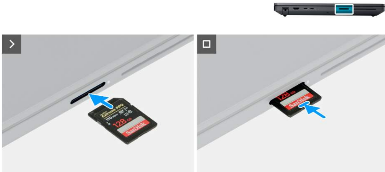
Rysunek 11. Instalowanie karty sieci SD
