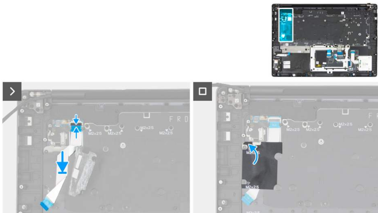
Rysunek 124. Instalowanie kabla płyty przycisku zasilania
