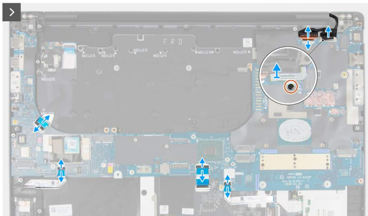
Rysunek 107. Wymontowywanie płyty głównej
