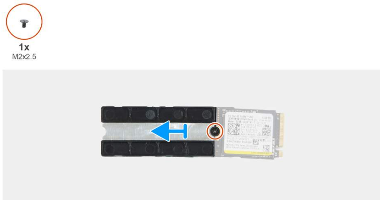
Rysunek 42. Wymontowywanie dysku SSD M.2 2230
