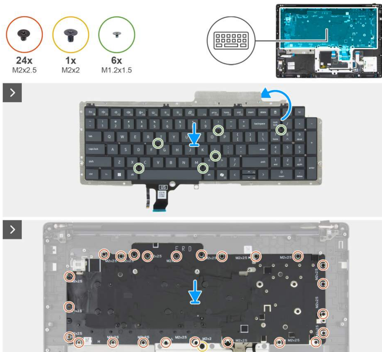
Rysunek 119. Instalowanie klawiatury
