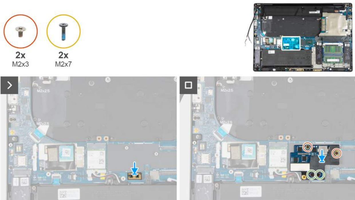
Rysunek 72. Instalowanie płyty zasilania
