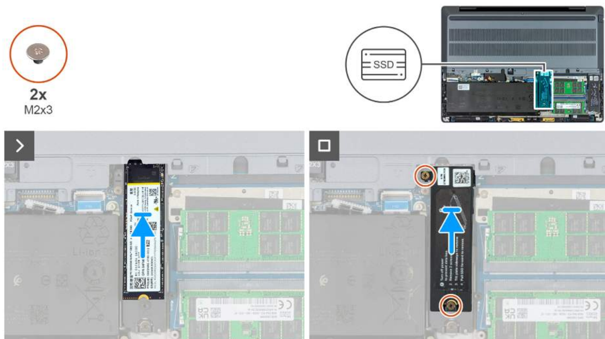
Rysunek 37. Instalowanie dysku SSD M.2 2280 w gnieździe 3 (SSD3)
