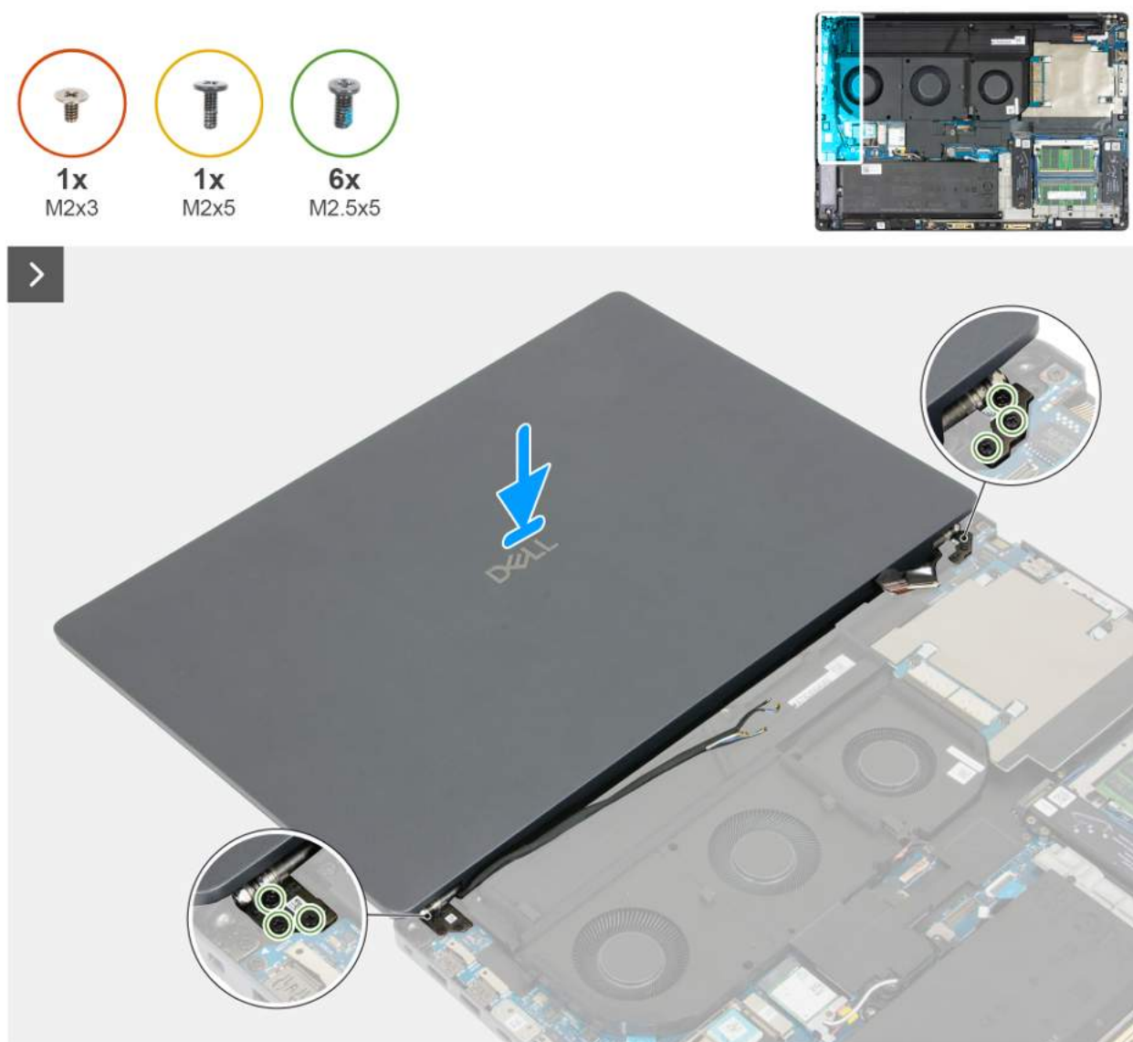
Rysunek 65. Instalowanie zestawu wyświetlacza
