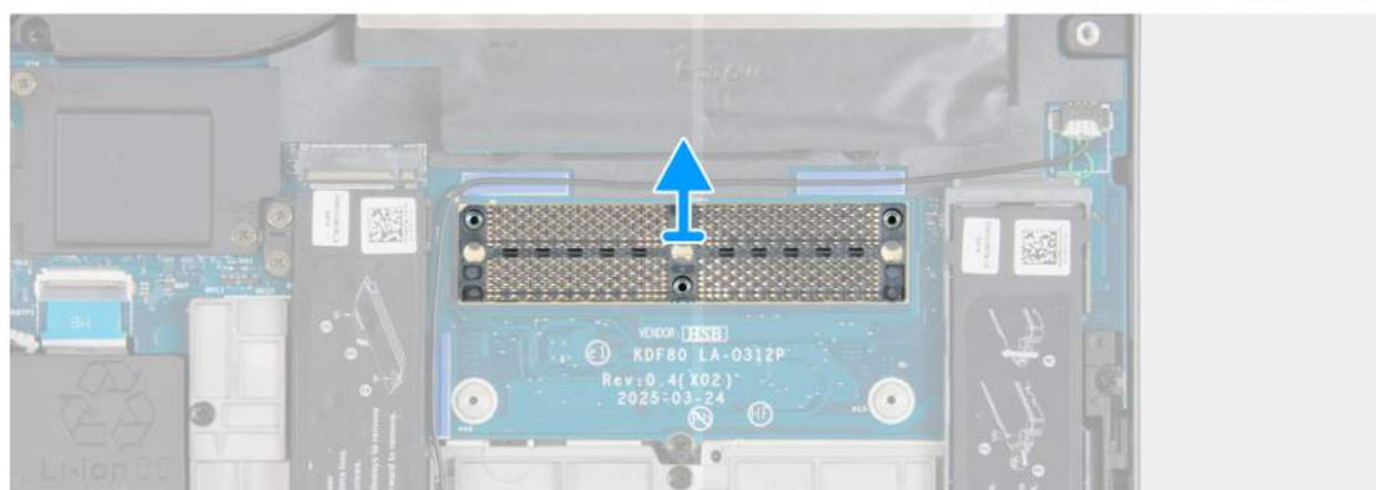
Rysunek 69. Wymontowywanie złącza pamięci
