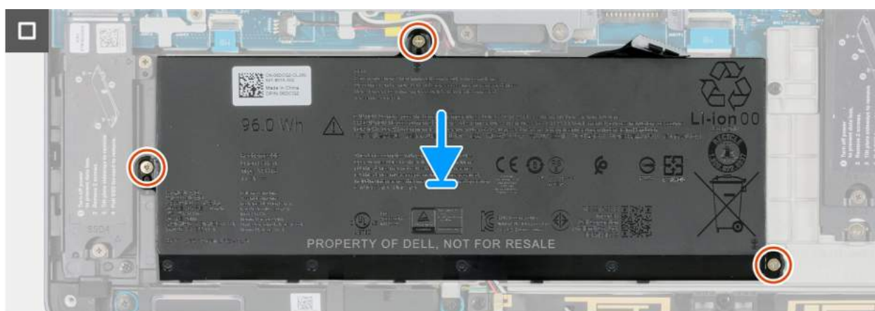
Rysunek 47. Wymiana baterii
