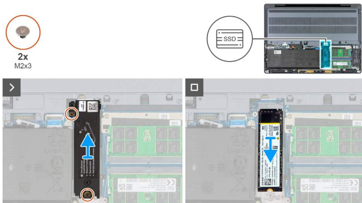
Rysunek 38. Wymontowywanie dysku SSD M.2 2280 z gniazda 2 (SSD2)
