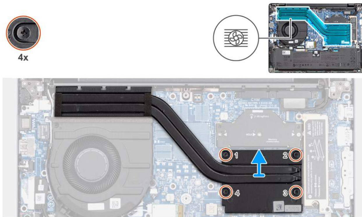
Rysunek 39. Wymontowywanie radiatora
