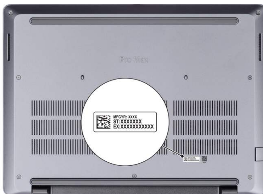
Rysunek 7. Lokalizacja etykiety z kodem Service Tag / kodem obsługi ekspresowej
