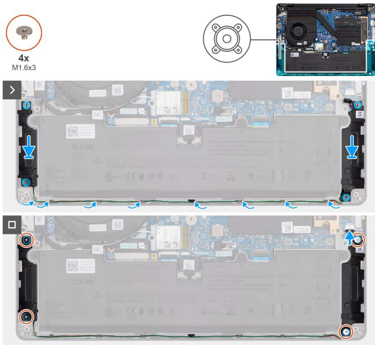
Rysunek 29. Instalowanie głośników
