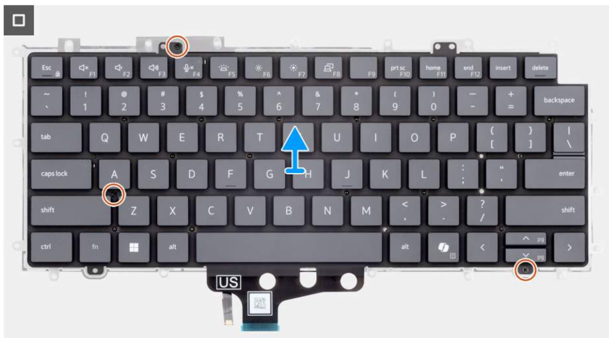
Rysunek 96. Wymontowywanie klawiatury
