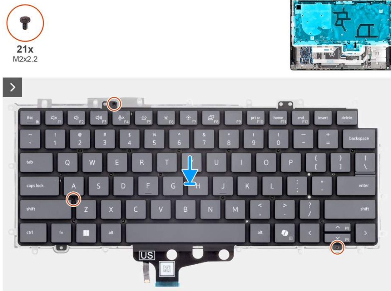
Rysunek 97. Instalowanie klawiatury
