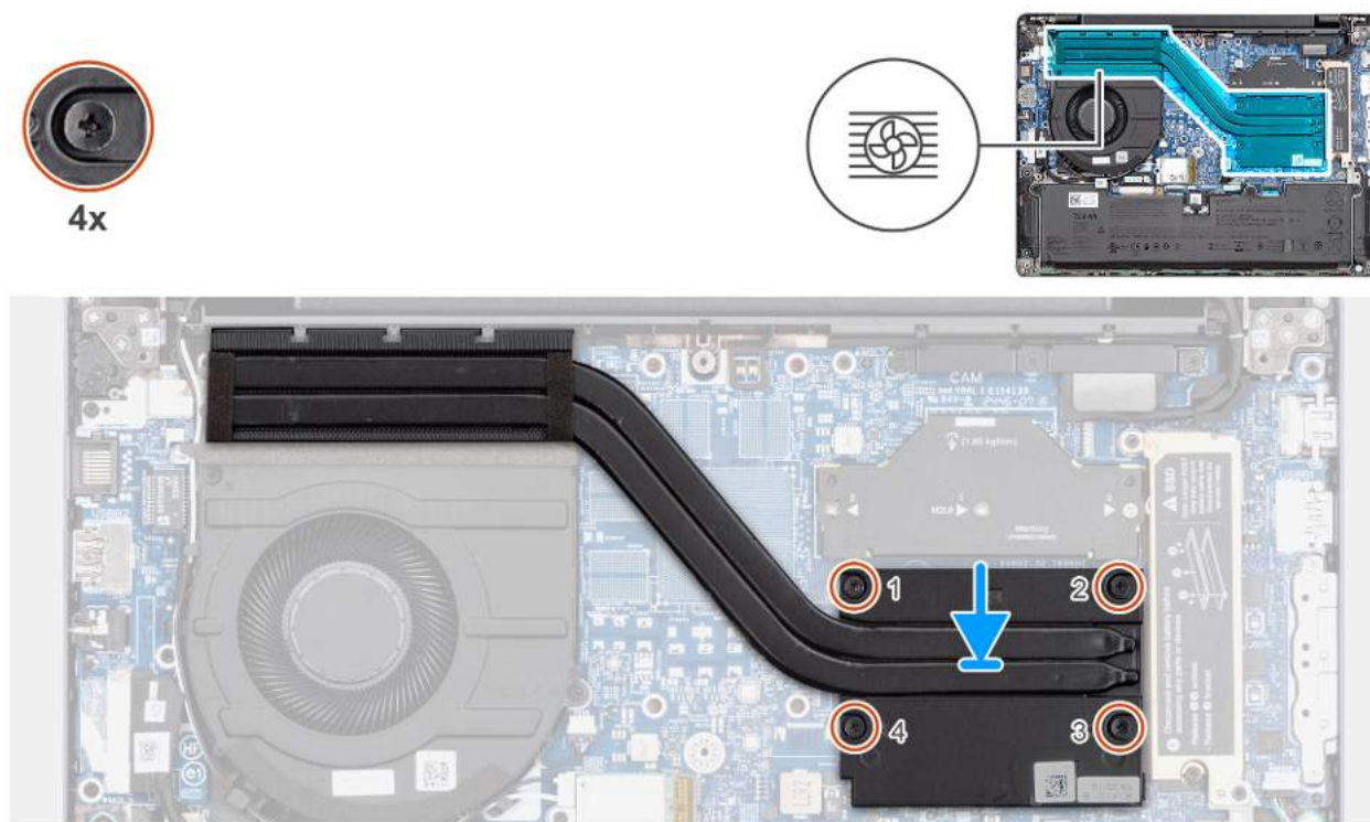
Rysunek 40. Instalowanie radiatora
