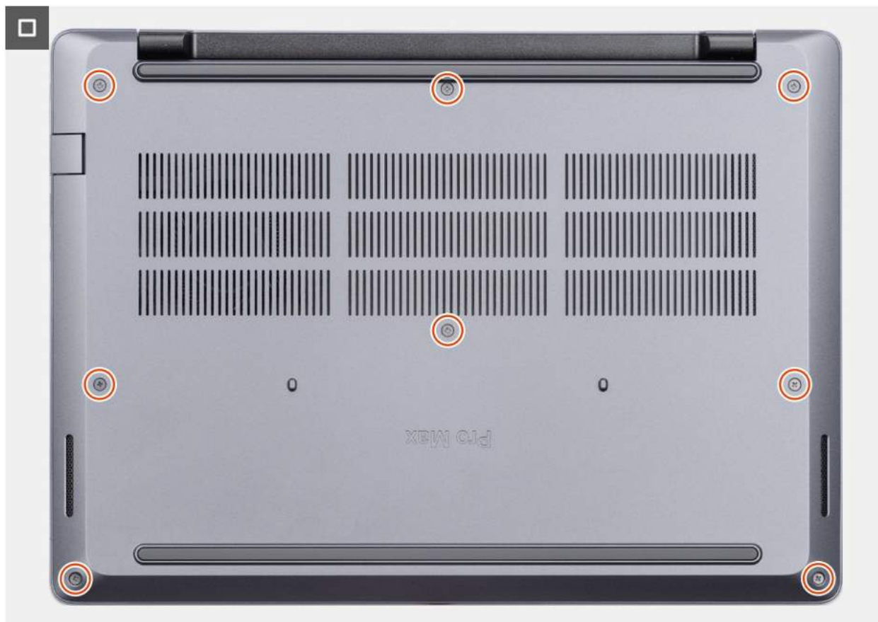
Rysunek 15. Instalowanie pokrywy dolnej
