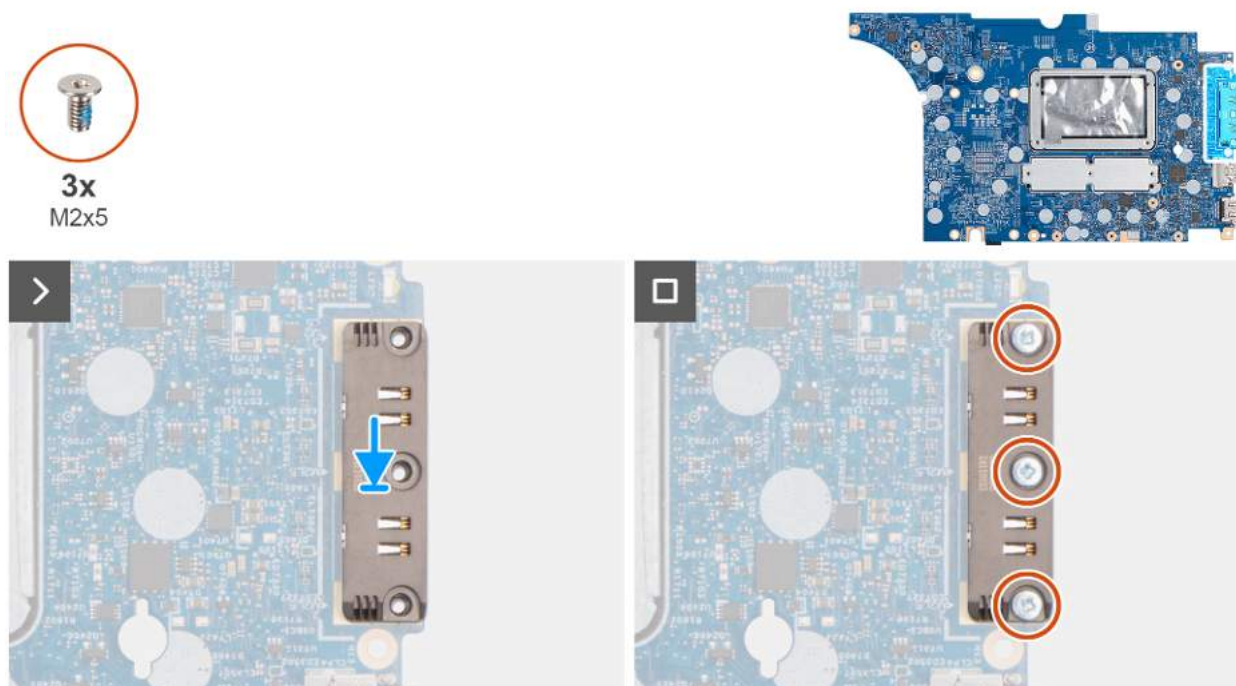
Rysunek 93. Instalowanie modułu USB Type-C
