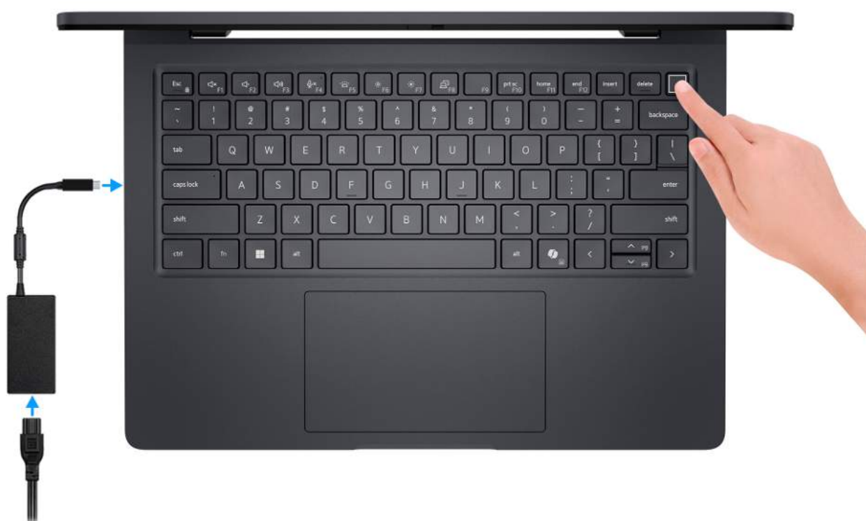
Rysunek 8. Podłącz zasilacz i naciśnij przycisk zasilania
