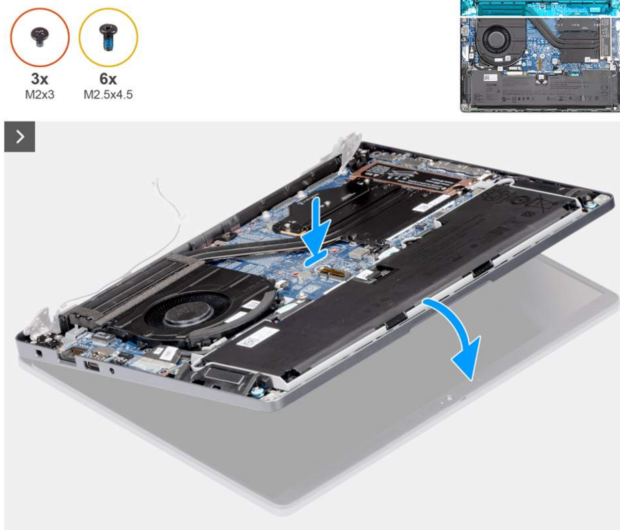
Rysunek 50. Instalowanie zestawu wyświetlacza
