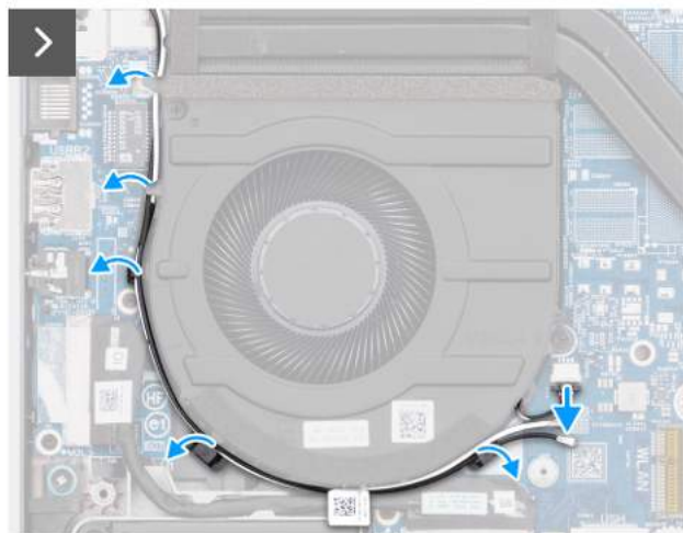
Rysunek 31. Wymontowywanie wentylatora
