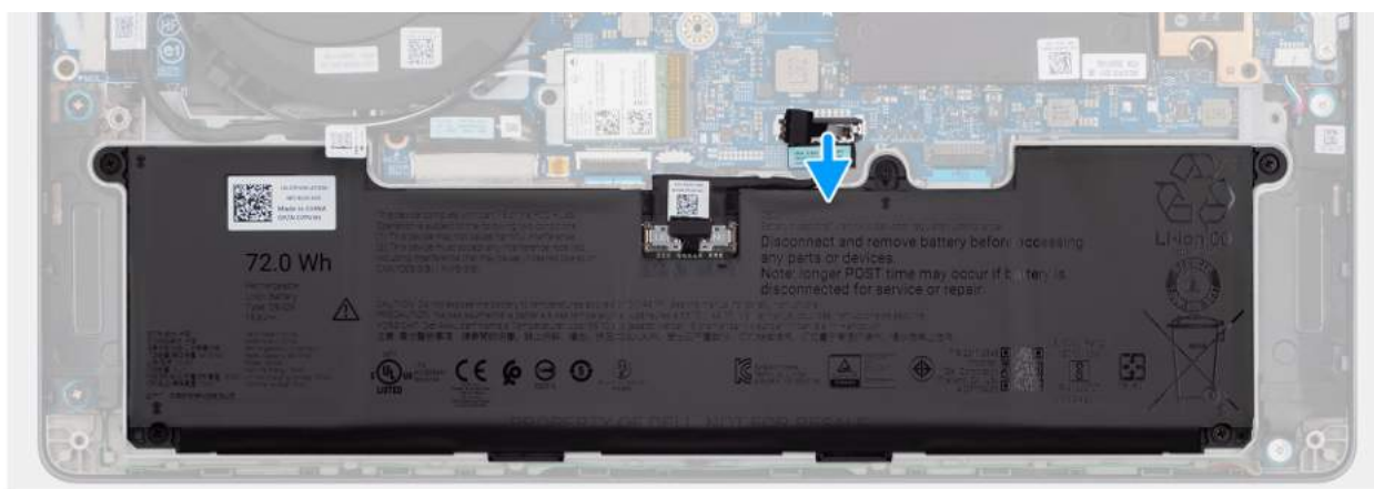
Rysunek 13. Wymontowywanie kabla baterii
