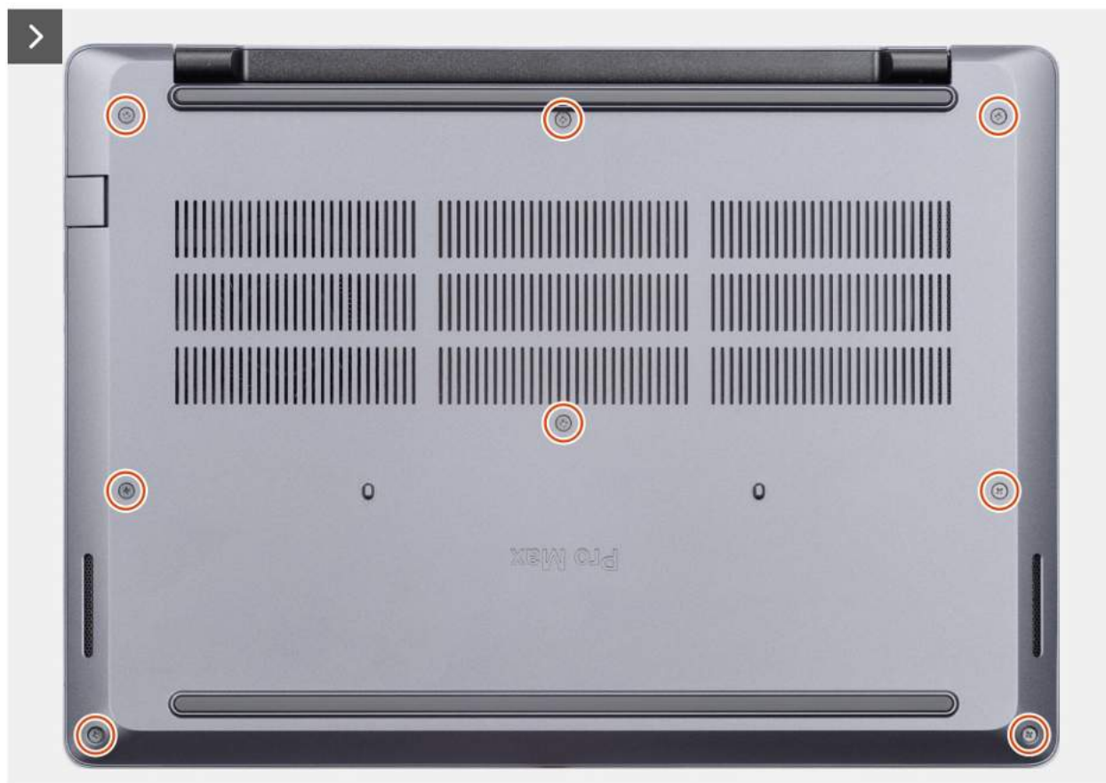
Rysunek 11. Wymontowywanie pokrywy dolnej
