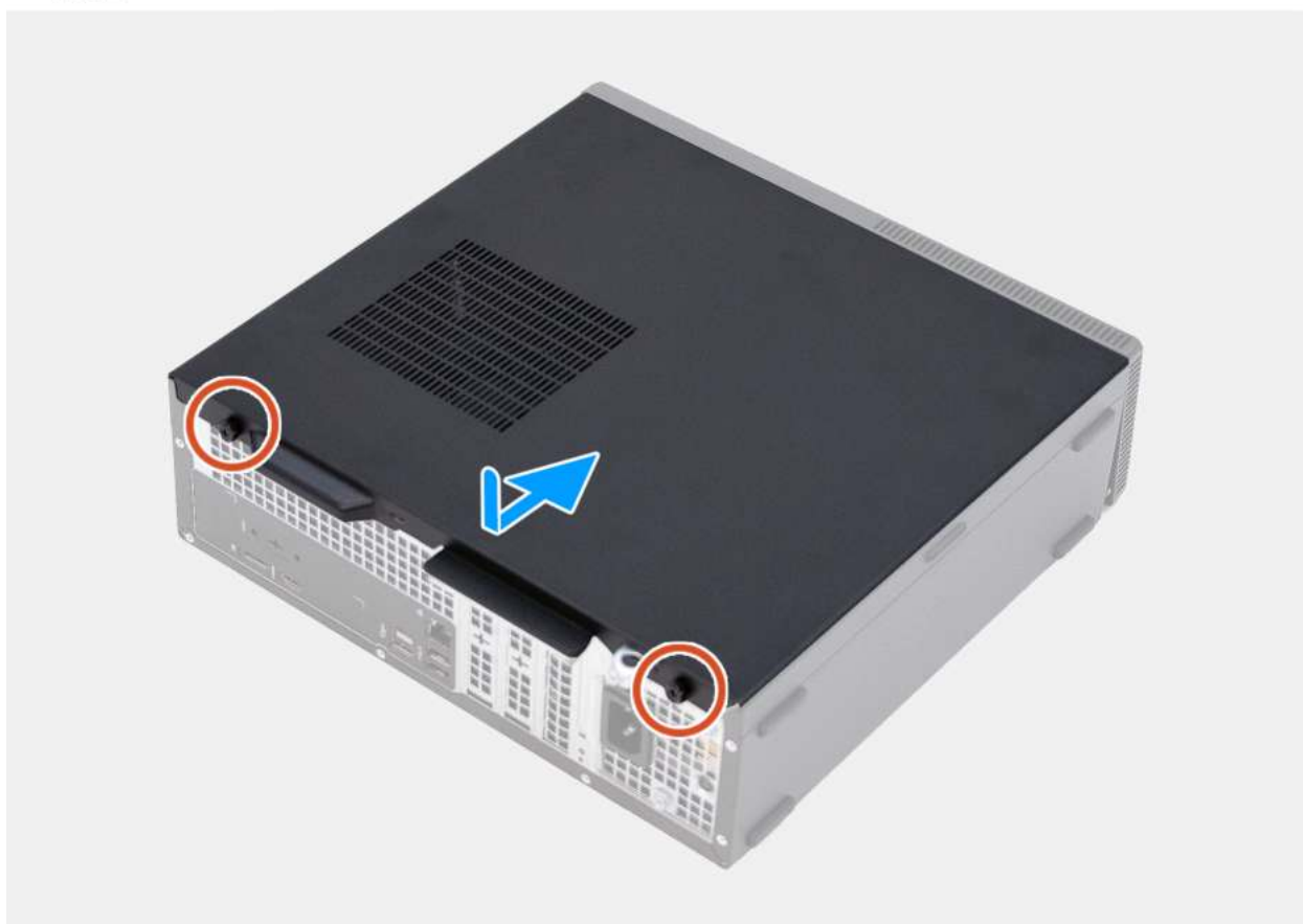
Rysunek 11. Instalowanie lewej pokrywy bocznej
