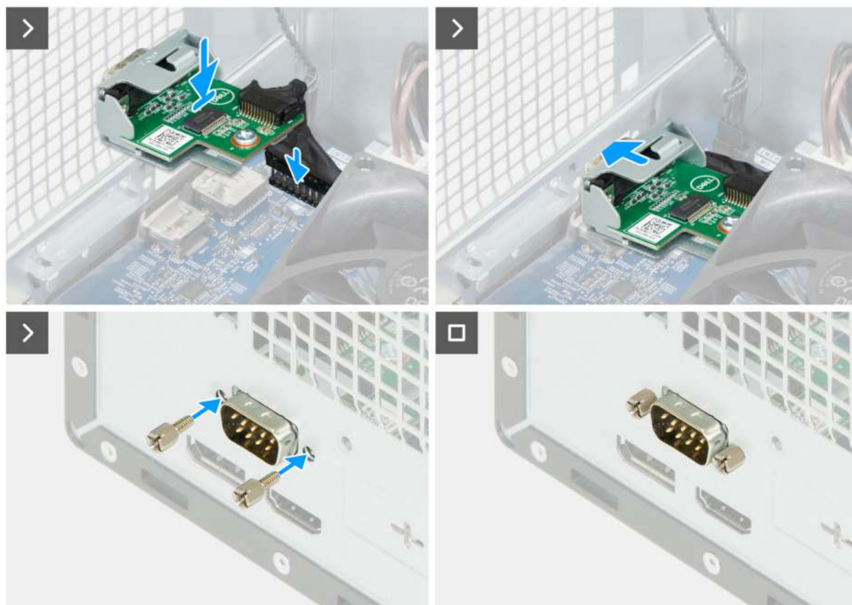
Rysunek 47. Instalowanie modułu portu szeregowego
