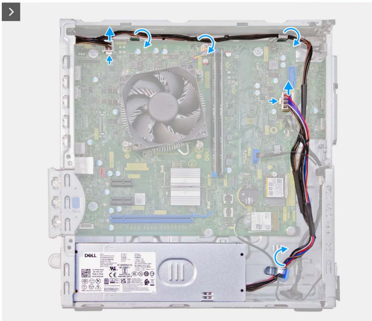
Rysunek 33. Wymontowywanie zasilacza
