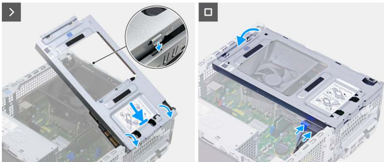
Rysunek 20. Instalowanie wnęki na dysk
