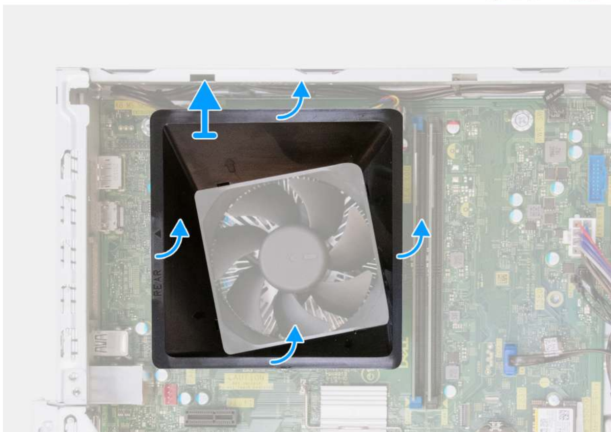
Rysunek 37. Wymontowywanie osłony wentylatora
