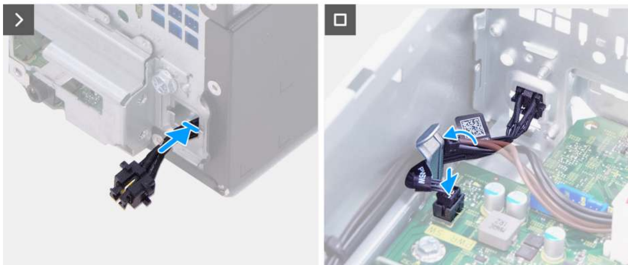
Rysunek 44. Instalowanie przycisku zasilania
