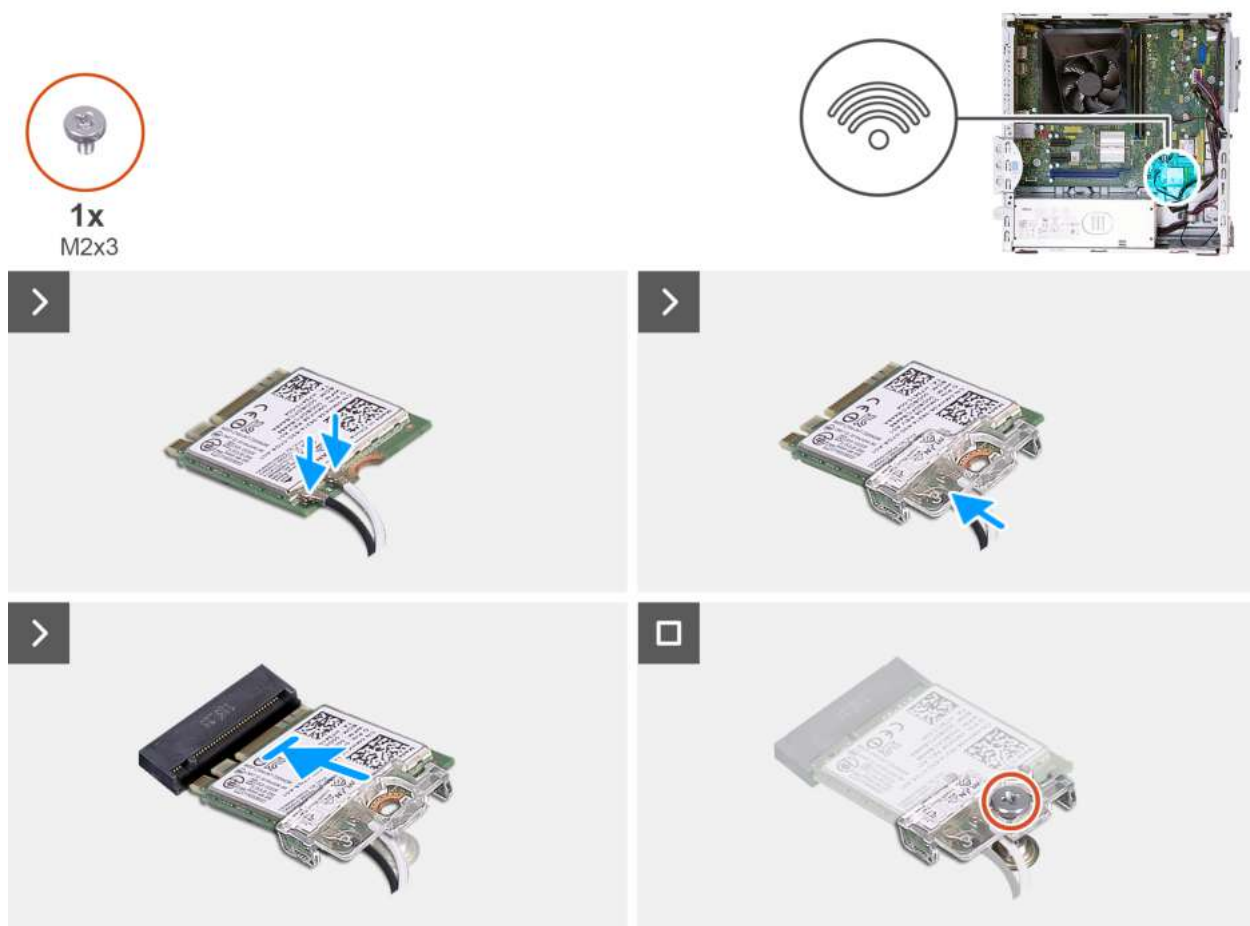
Rysunek 28. Instalowanie karty sieci bezprzewodowej
