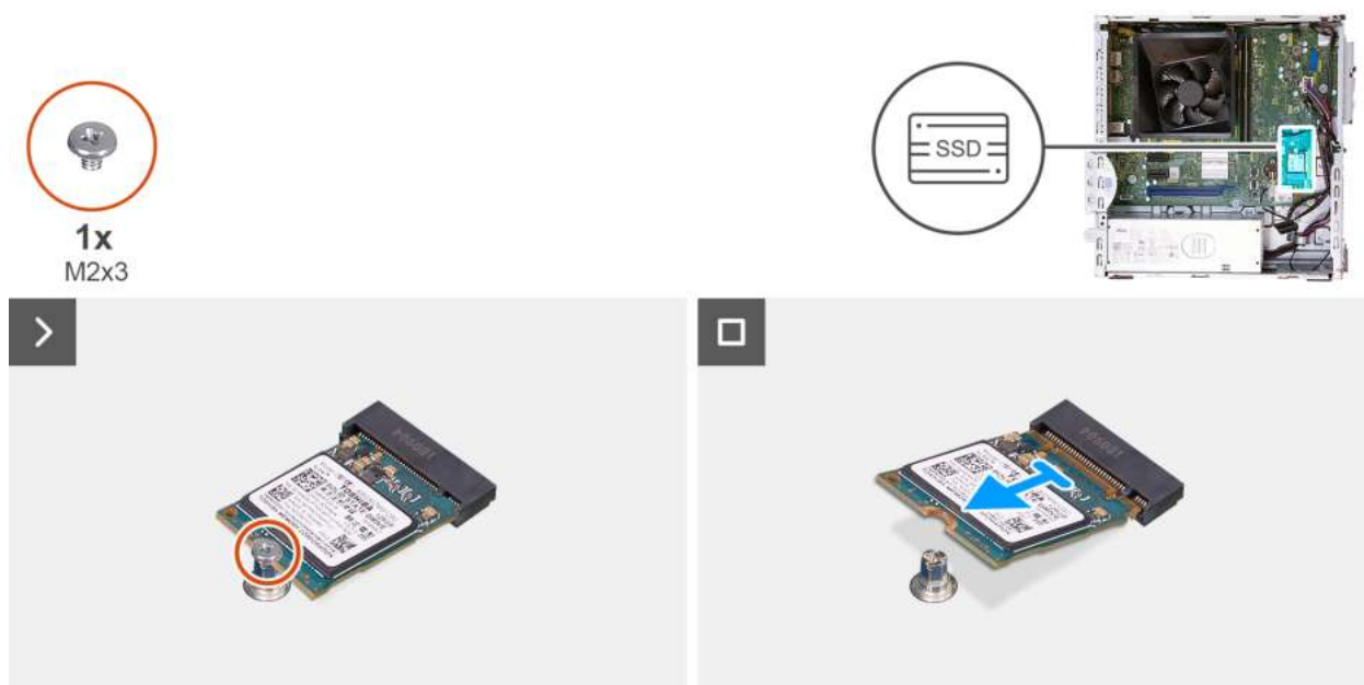
Rysunek 25. Wymontowywanie dysku SSD M.2 2230
