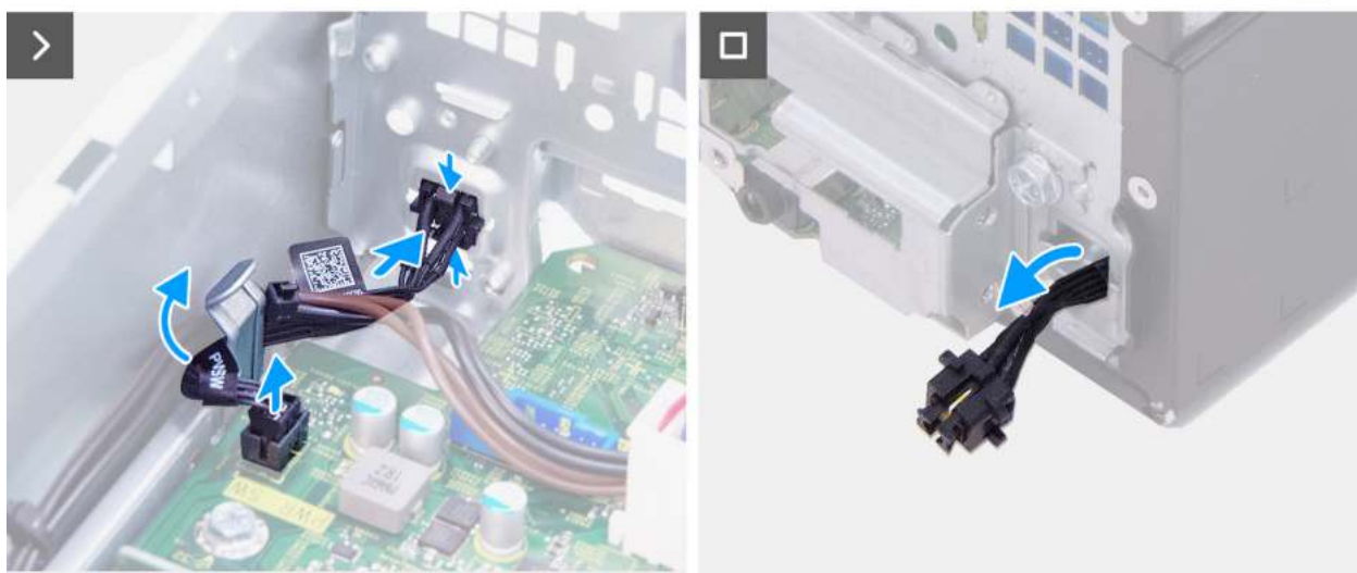
Rysunek 43. Wymontowywanie przycisku zasilania
