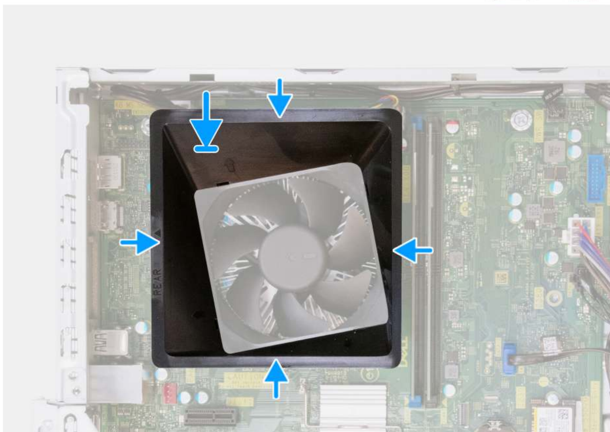
Rysunek 38. Instalowanie osłony wentylatora
