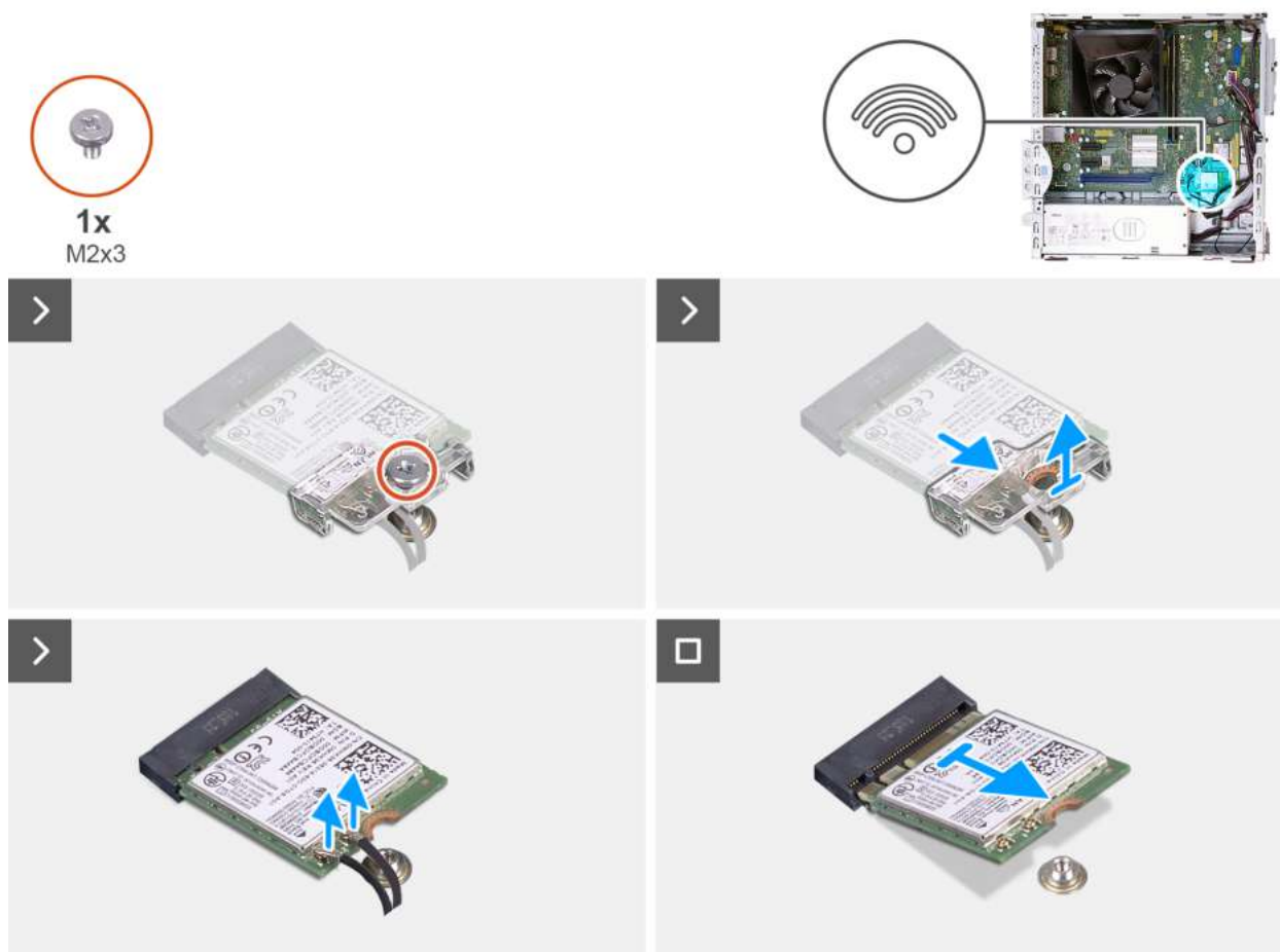
Rysunek 27. Wymontowywanie karty sieci bezprzewodowej
