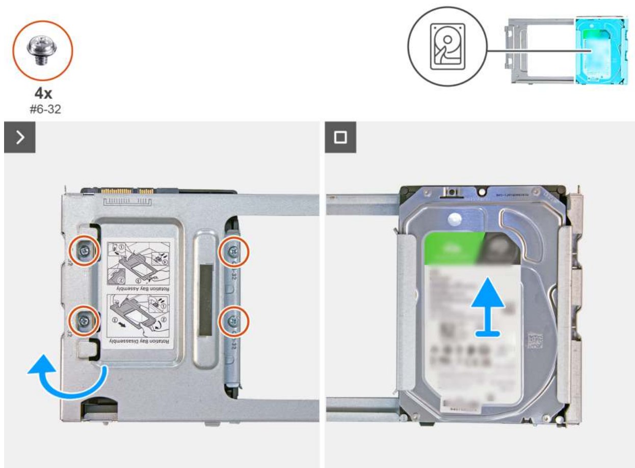
Rysunek 21. Wymontowywanie dysku twardego
