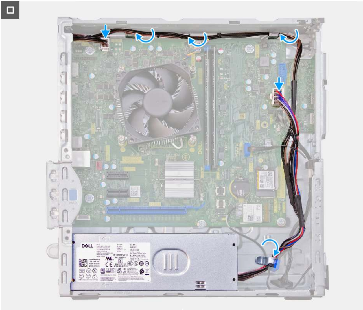
Rysunek 36. Instalowanie zasilacza
