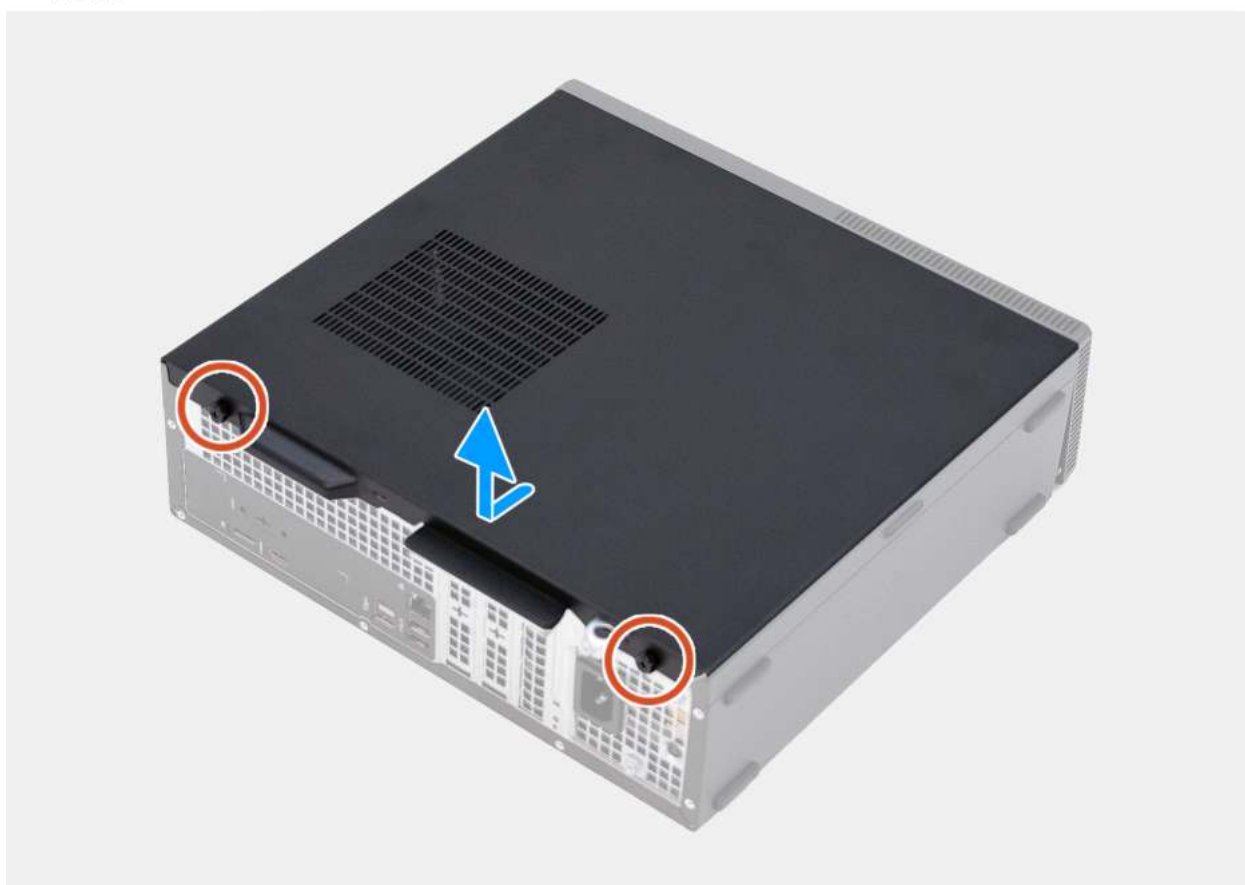
Rysunek 10. Wymontowywanie lewej pokrywy bocznej
