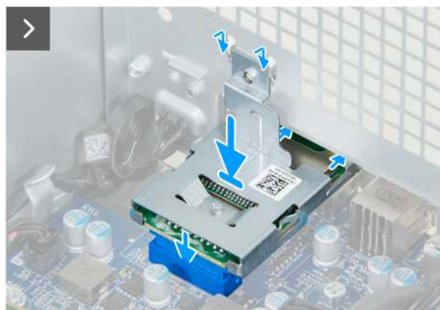
Rysunek 30. Instalowanie czytnika kart pamięci
