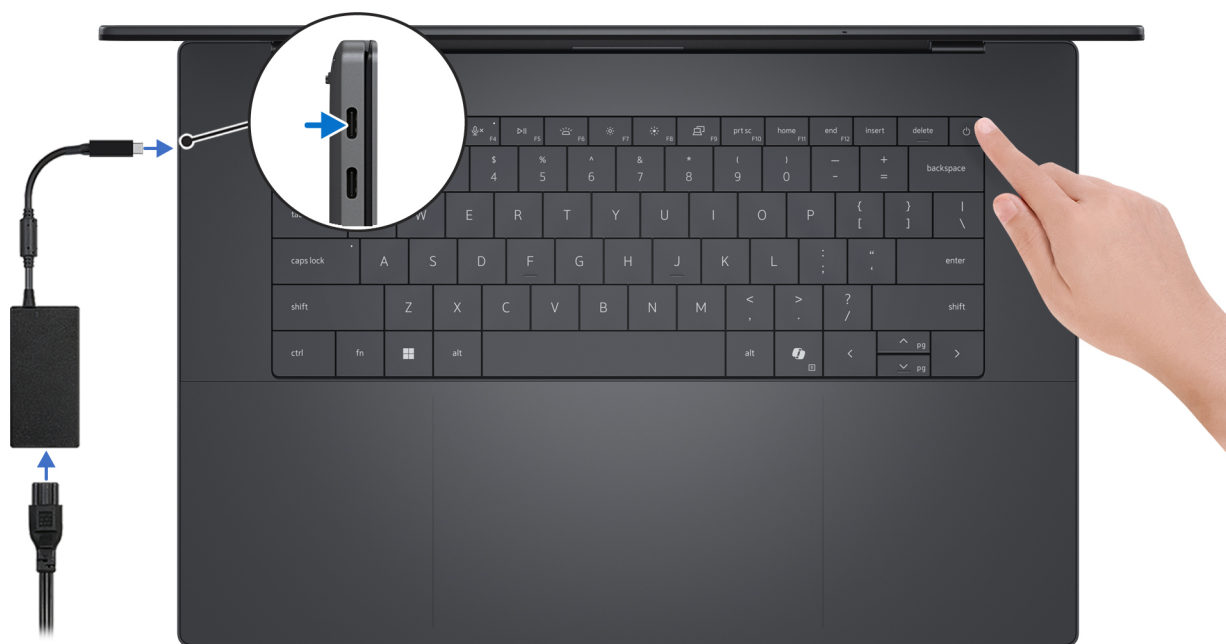
Rysunek 7. Podłącz zasilacz do komputera i źródła zasilania, a następnie naciśnij przycisk zasilania, aby go włączyć.
