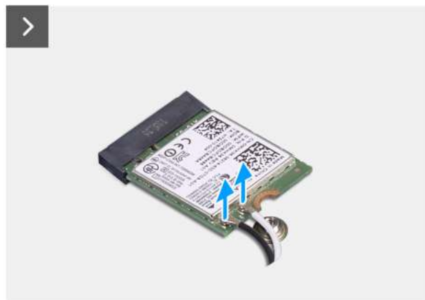
Rysunek 30. Wymontowywanie karty sieci bezprzewodowej
