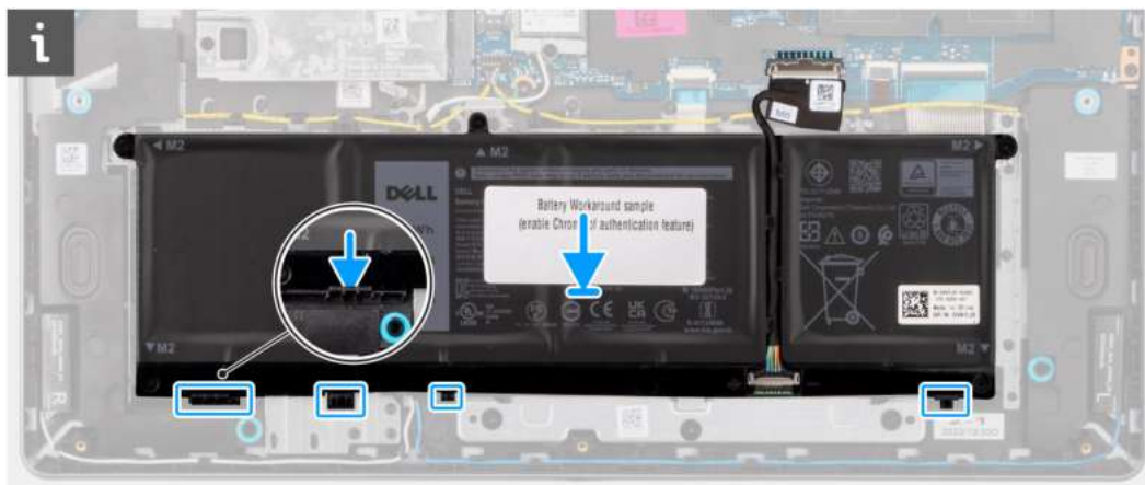
Rysunek 18. Instalowanie baterii — wkładanie wypustek do zaczepów
