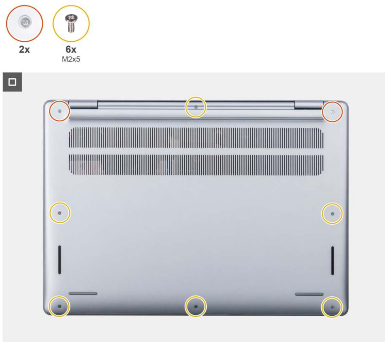
Rysunek 15. Instalowanie pokrywy dolnej
