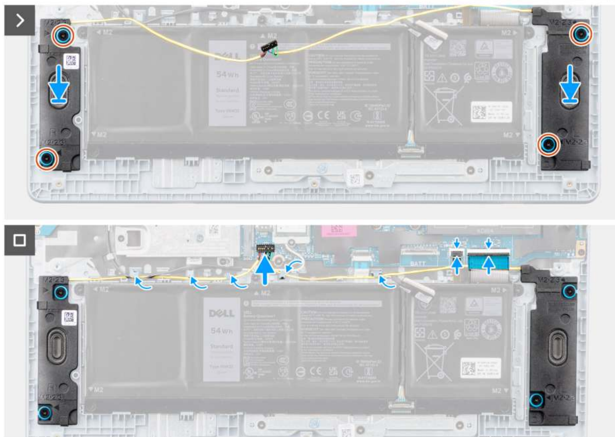
Rysunek 35. Instalowanie głośników
