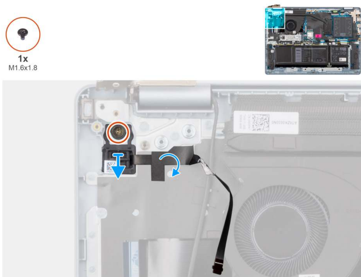
Rysunek 74. Wymontowywanie przycisku zasilania z czytnikiem linii papilarnych
