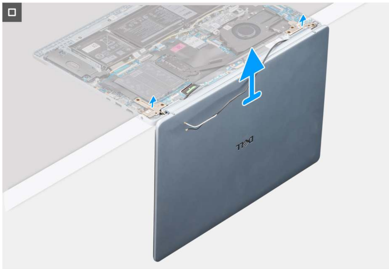
Rysunek 51. Wymontowywanie zestawu wyświetlacza
