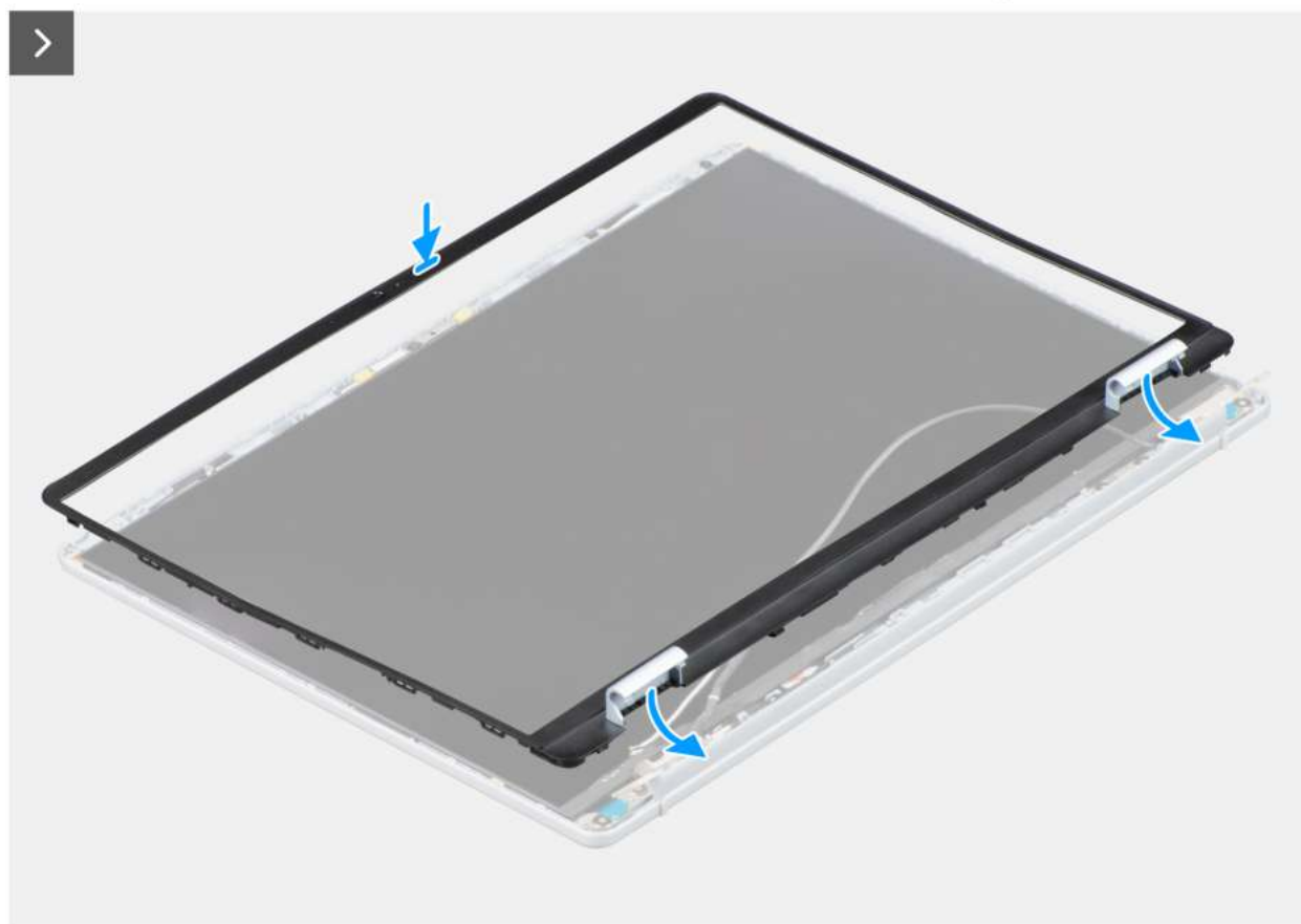
Rysunek 59. Instalowanie ramki wyświetlacza
