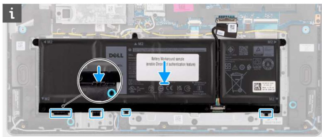
Rysunek 21. Instalowanie baterii — wkładanie wypustek do zaczepów
