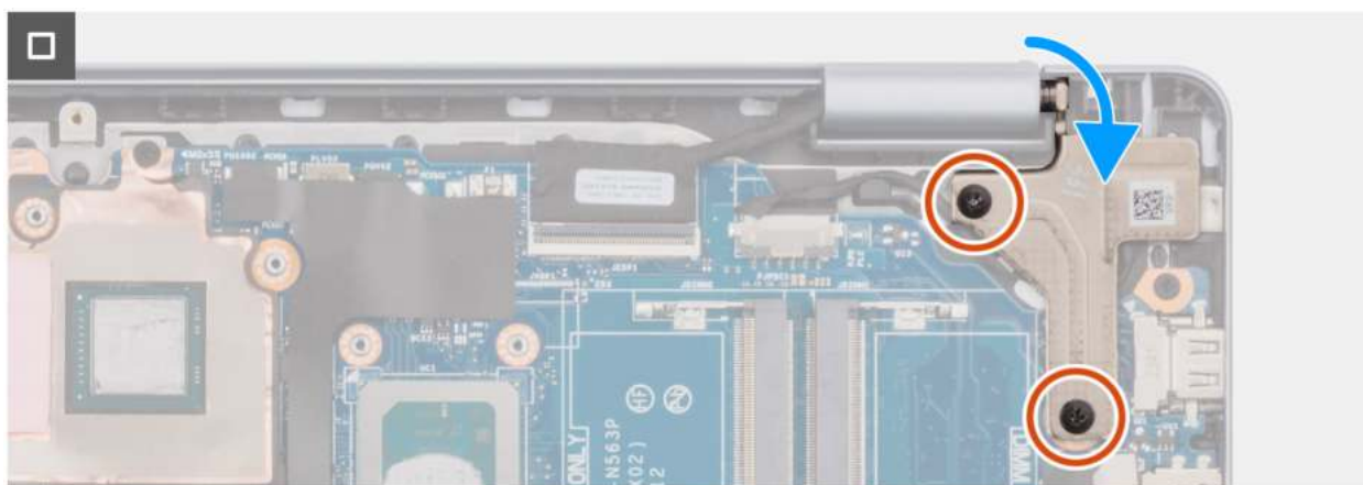
Rysunek 87. Instalowanie płyty głównej
