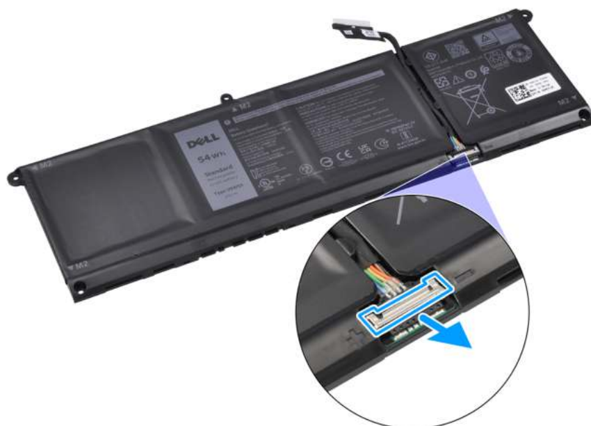
Rysunek 23. Odłączanie złącza kabla baterii
