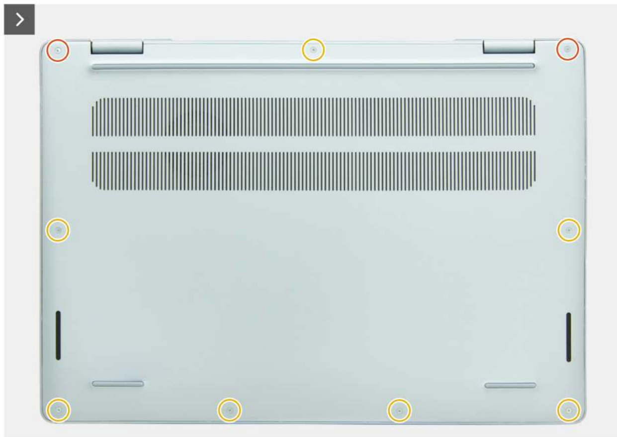
Rysunek 10. Wymontowywanie pokrywy dolnej
