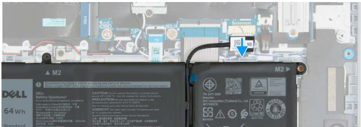
Rysunek 12. Odłączanie kabla baterii
