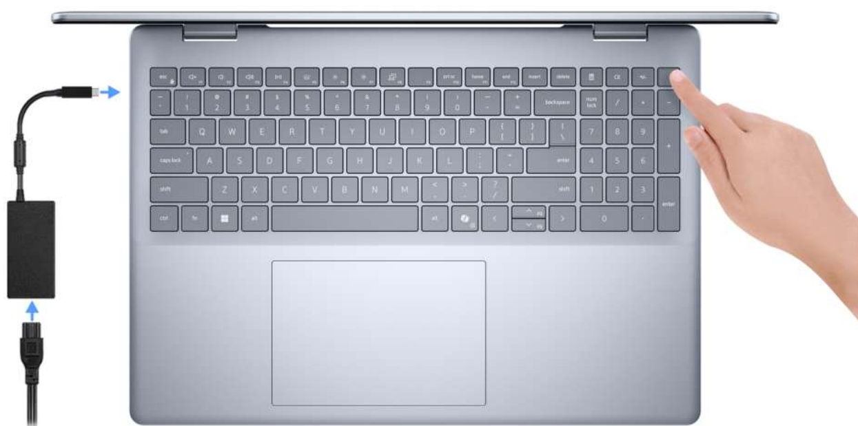
Rysunek 7. Podłącz zasilacz i naciśnij przycisk zasilania.
