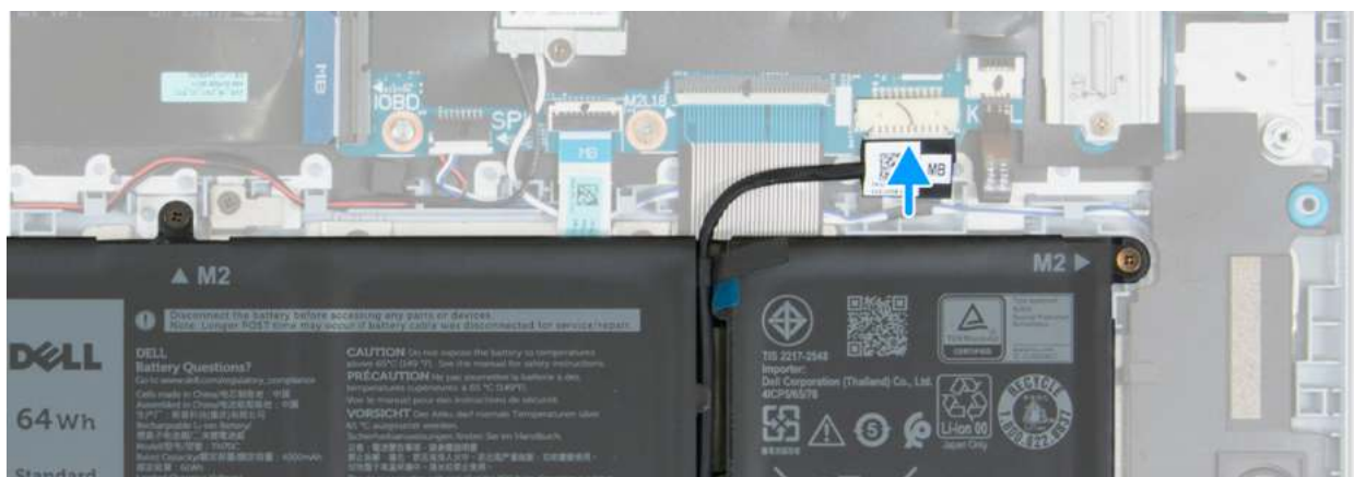
Rysunek 13. Podłączanie kabla baterii
