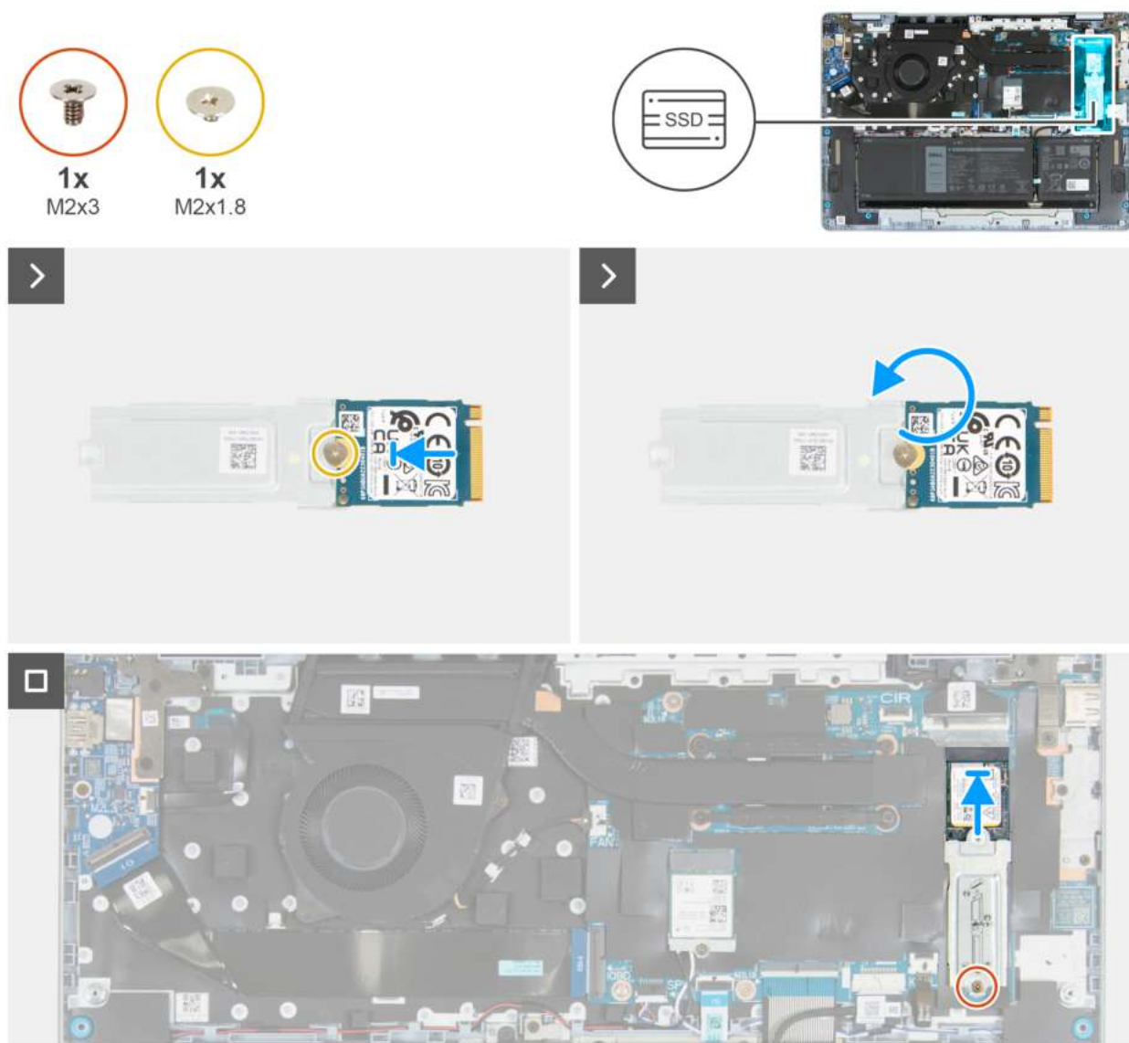
Rysunek 21. Instalowanie dysku SSD M.2 2230
