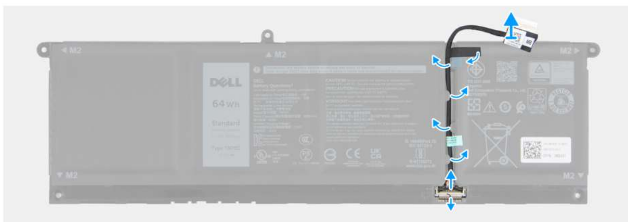
Rysunek 18. Wymontowywanie kabla baterii
