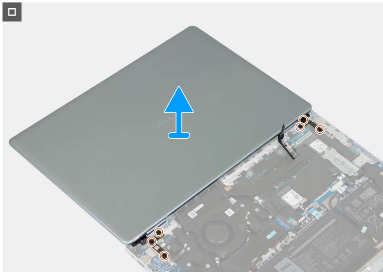
Rysunek 29. Wymontowywanie zestawu wyświetlacza — krok 2
