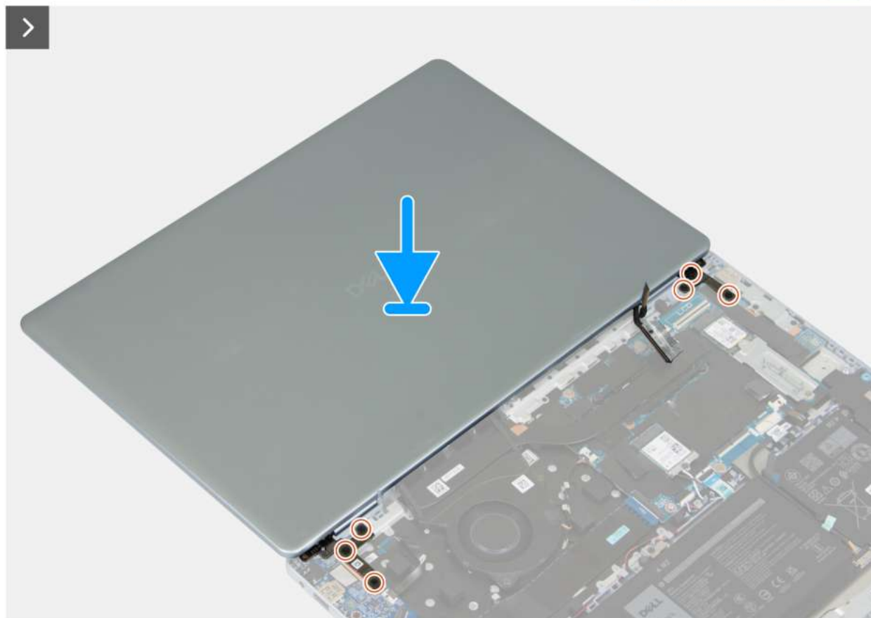
Rysunek 31. Instalowanie zestawu wyświetlacza — krok 1
