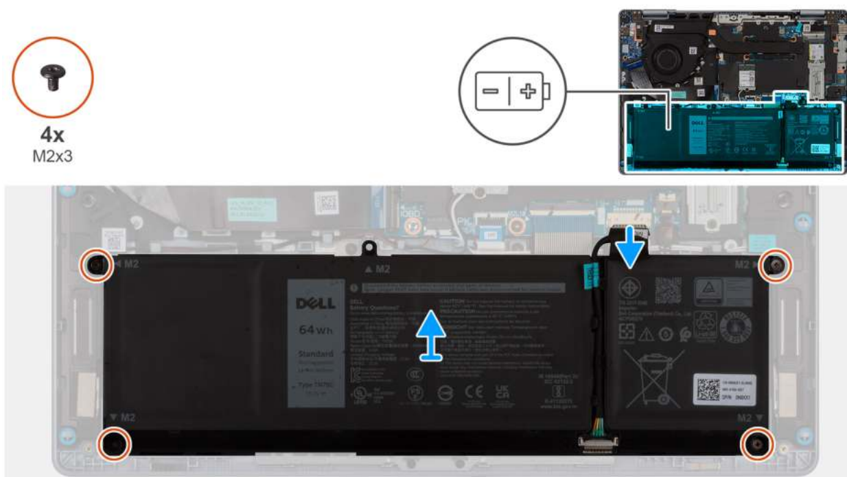
Rysunek 16. Wymontowywanie baterii
