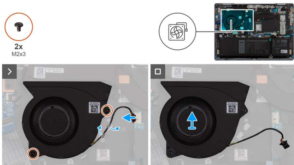
Rysunek 22. Wymontowywanie wentylatora
