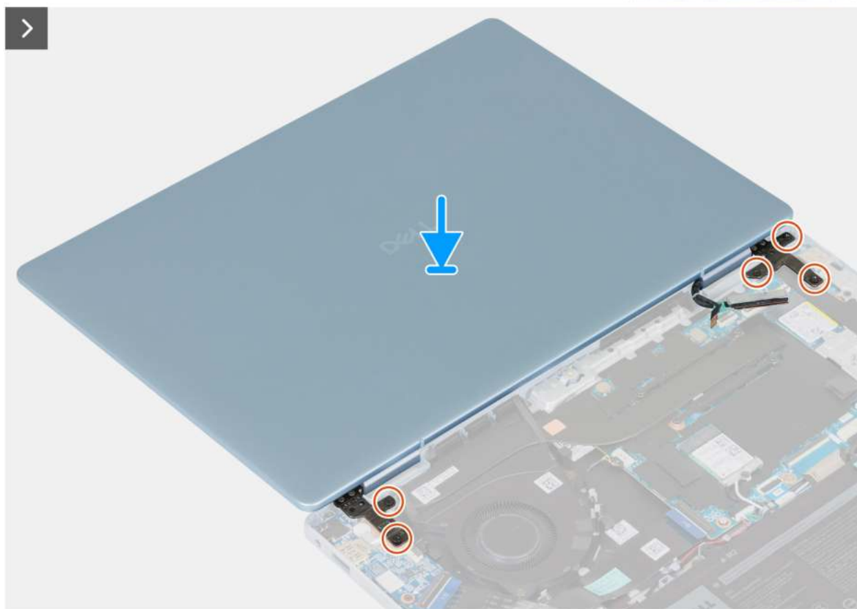
Rysunek 29. Instalowanie zestawu wyświetlacza — krok 1
