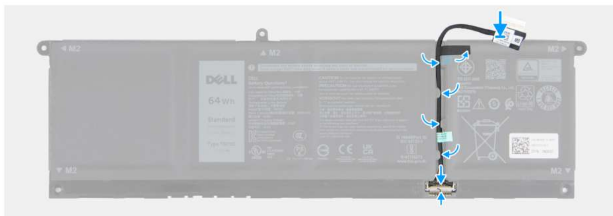
Rysunek 19. Instalowanie kabla baterii
