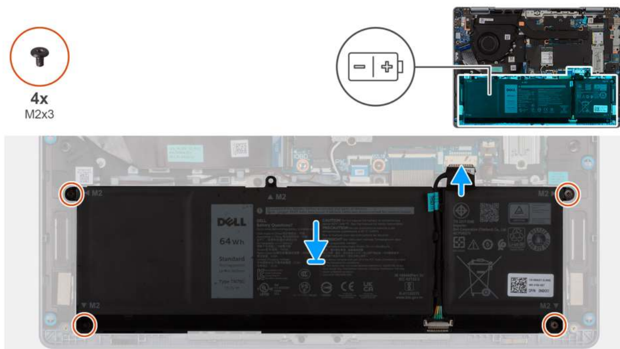
Rysunek 17. Instalowanie baterii
