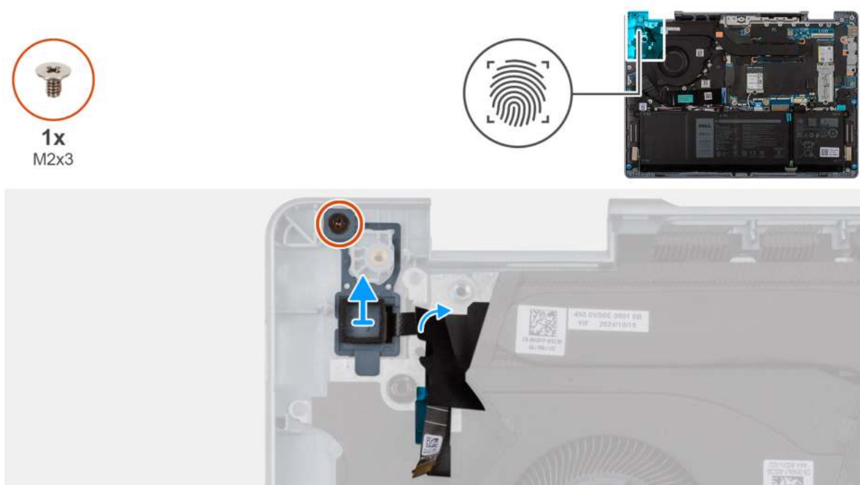
Rysunek 51. Wymontowywanie przycisku zasilania z czytnikiem linii papilarnych
