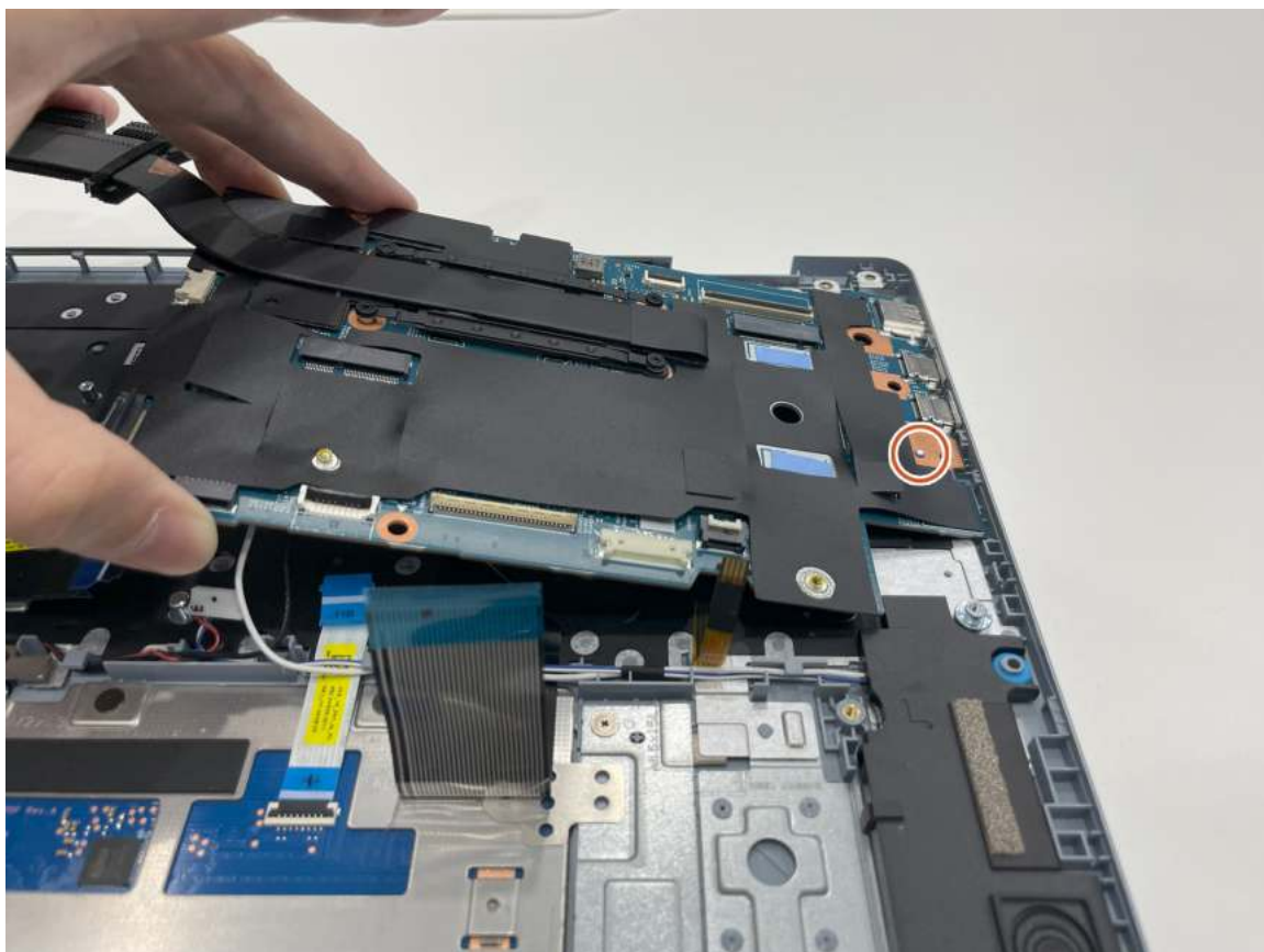
Rysunek 43. Wymontowywanie płyty głównej bez jej uszkodzenia
