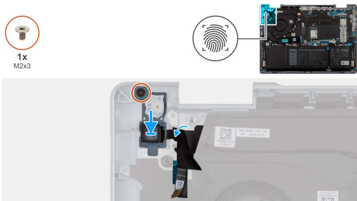
Rysunek 52. Instalowanie przycisku zasilania z czytnikiem linii papilarnych
