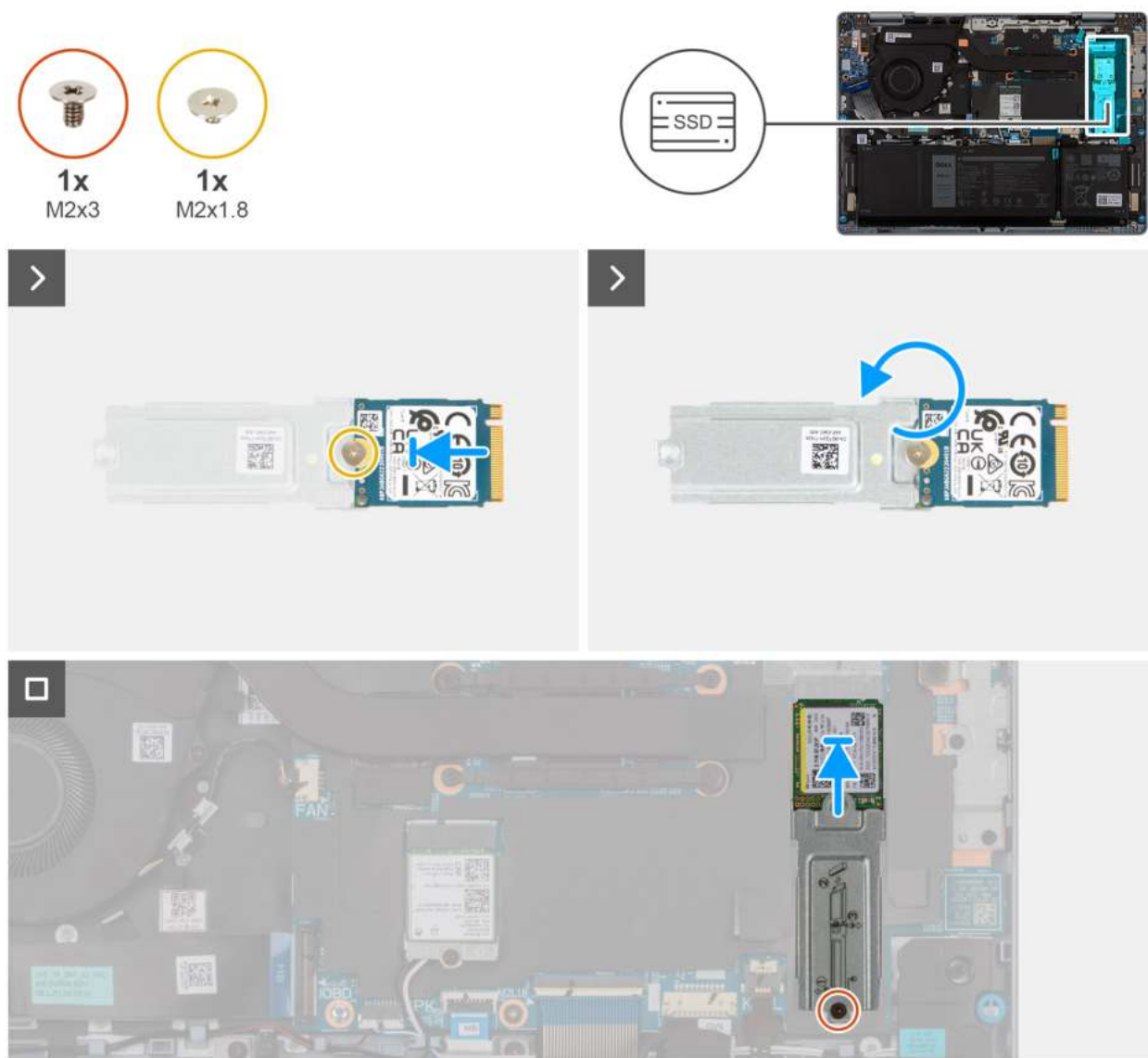
Rysunek 21. Instalowanie dysku SSD M.2 2230
