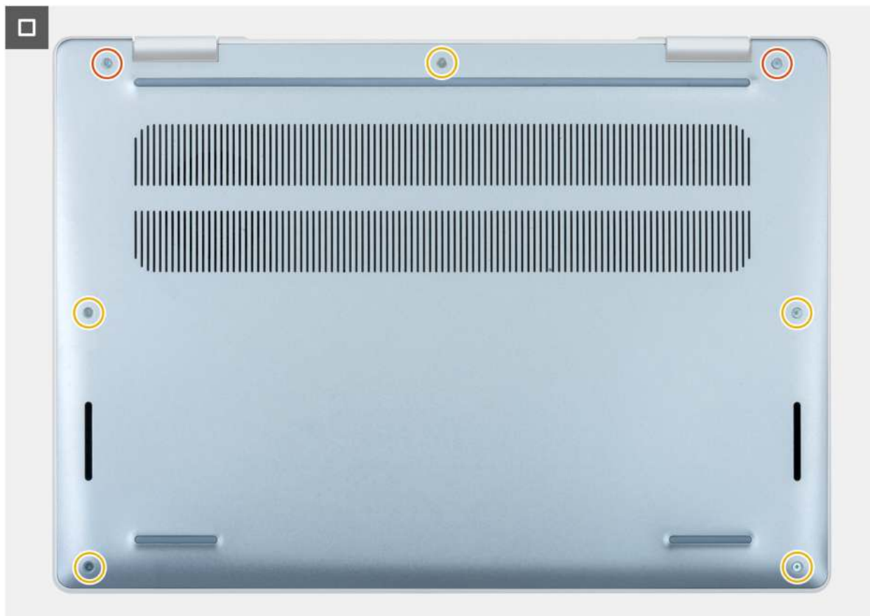
Rysunek 15. Instalowanie pokrywy dolnej
