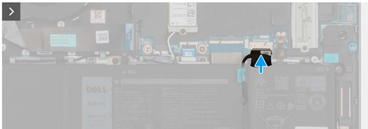
Rysunek 13. Podłączanie kabla baterii
