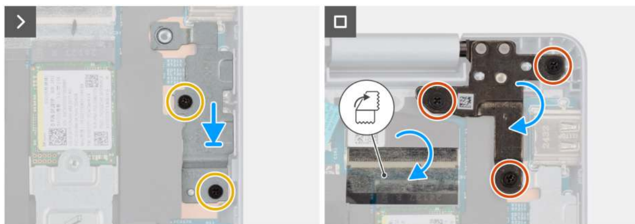
Rysunek 47. Instalowanie płyty głównej
