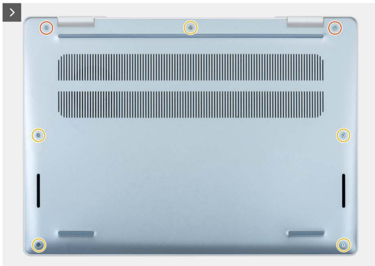
Rysunek 10. Wymontowywanie pokrywy dolnej
