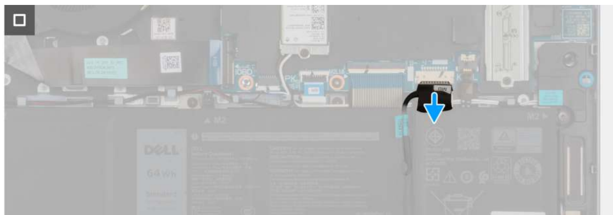
Rysunek 12. Odłączanie kabla baterii
