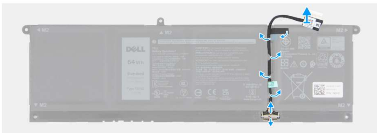
Rysunek 18. Wymontowywanie kabla baterii
