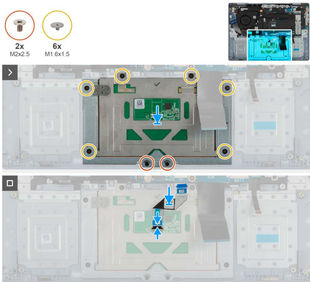
Rysunek 54. Instalowanie touchpada
