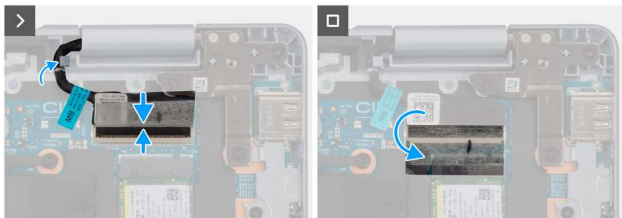
Rysunek 45. Podłączanie kabla wyświetlacza
