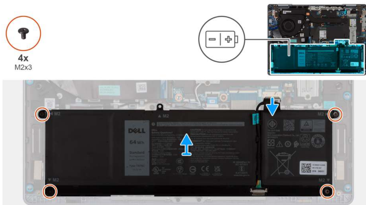
Rysunek 18. Wymontowywanie baterii
