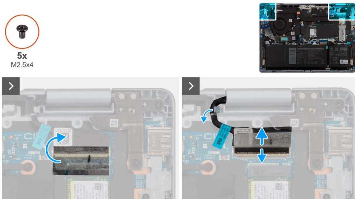
Rysunek 40. Odłączanie kabla wyświetlacza
