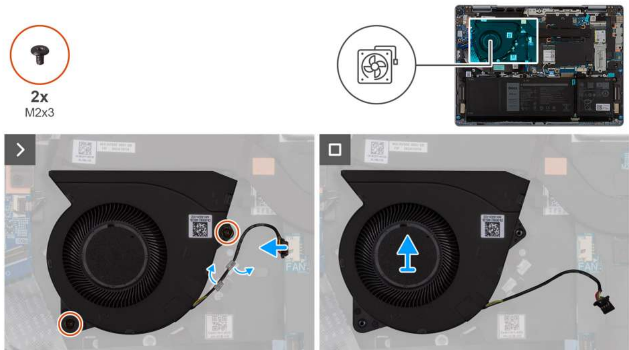
Rysunek 26. Wymontowywanie wentylatora systemowego
