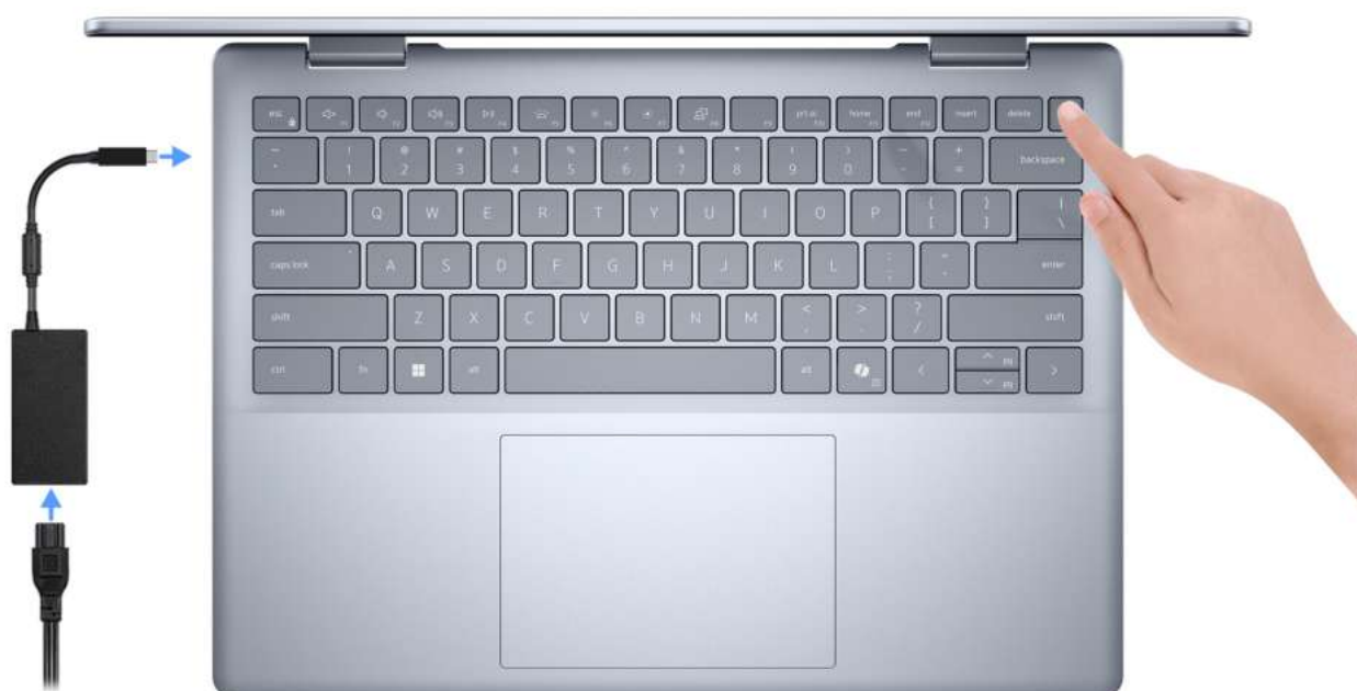
Rysunek 11. Podłącz zasilacz i naciśnij przycisk zasilania.
