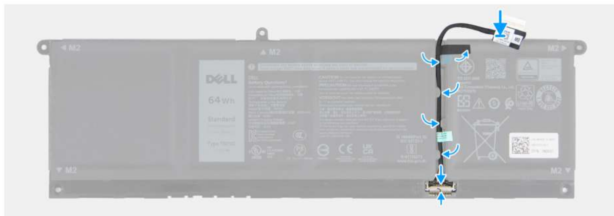
Rysunek 21. Podłączanie kabla baterii
