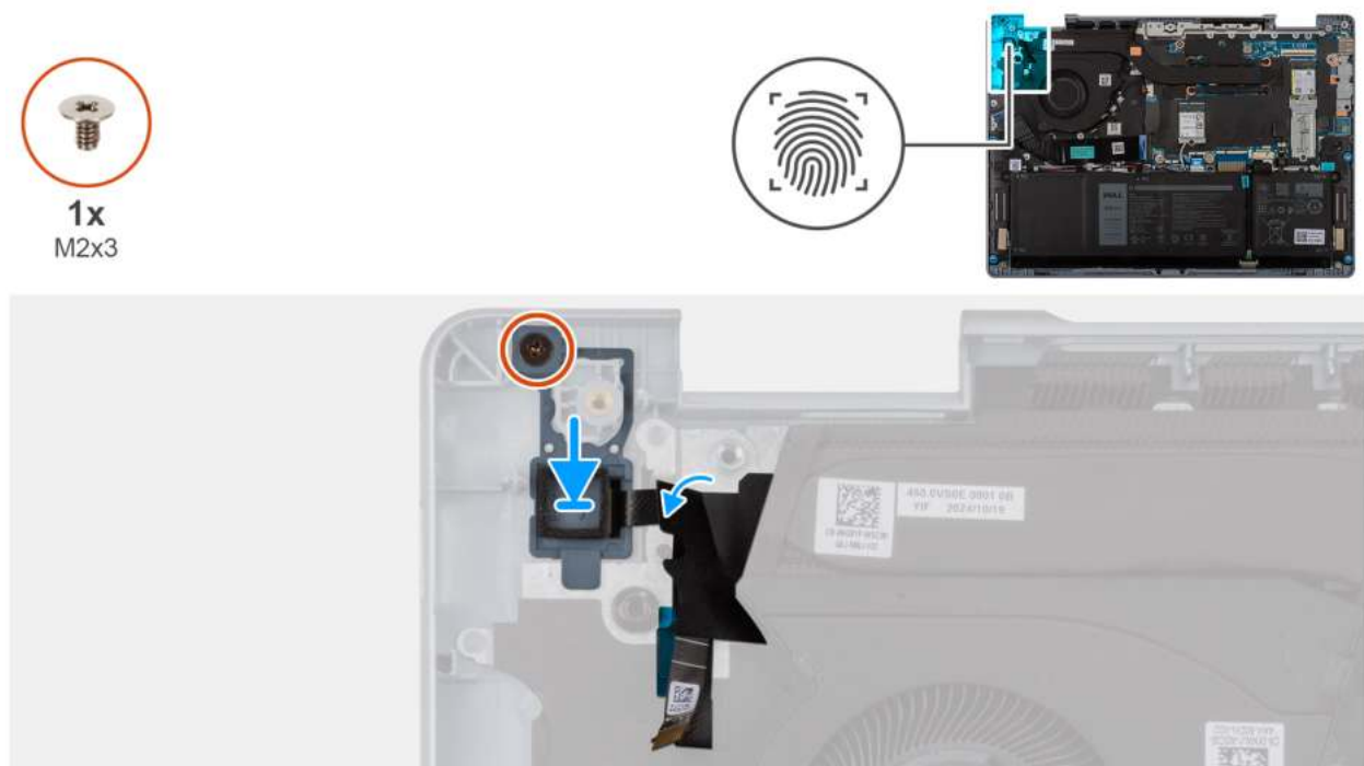
Rysunek 47. Instalowanie przycisku zasilania z czytnikiem linii papilarnych
