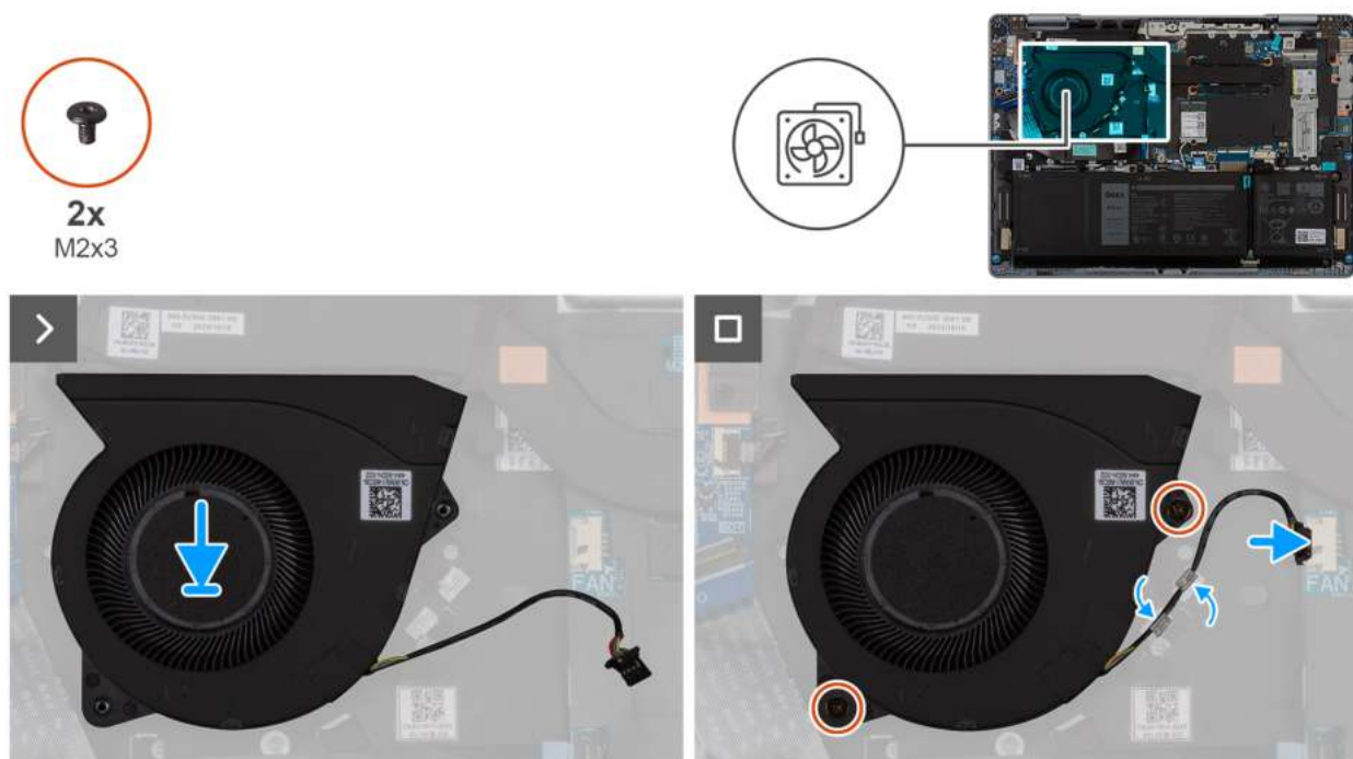
Rysunek 27. Instalowanie wentylatora systemowego
