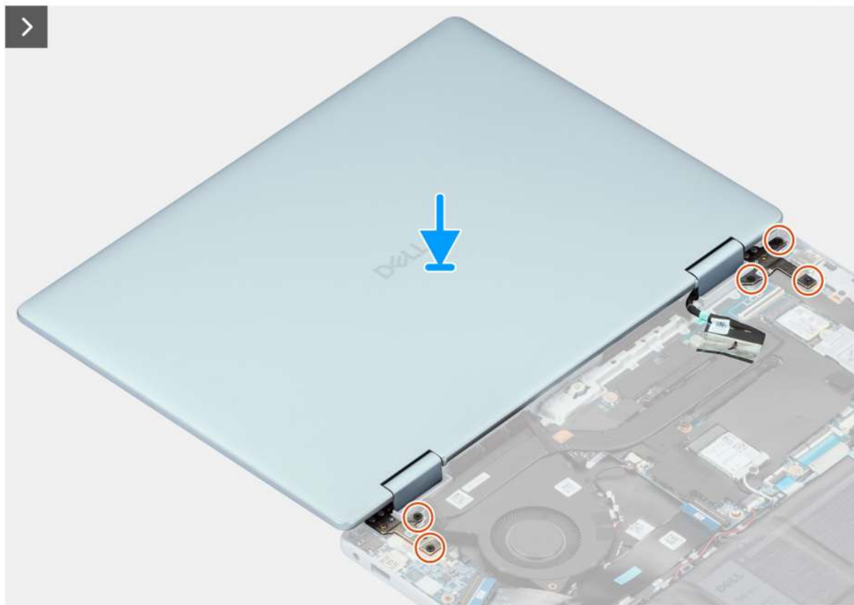
Rysunek 44. Instalowanie zestawu wyświetlacza
