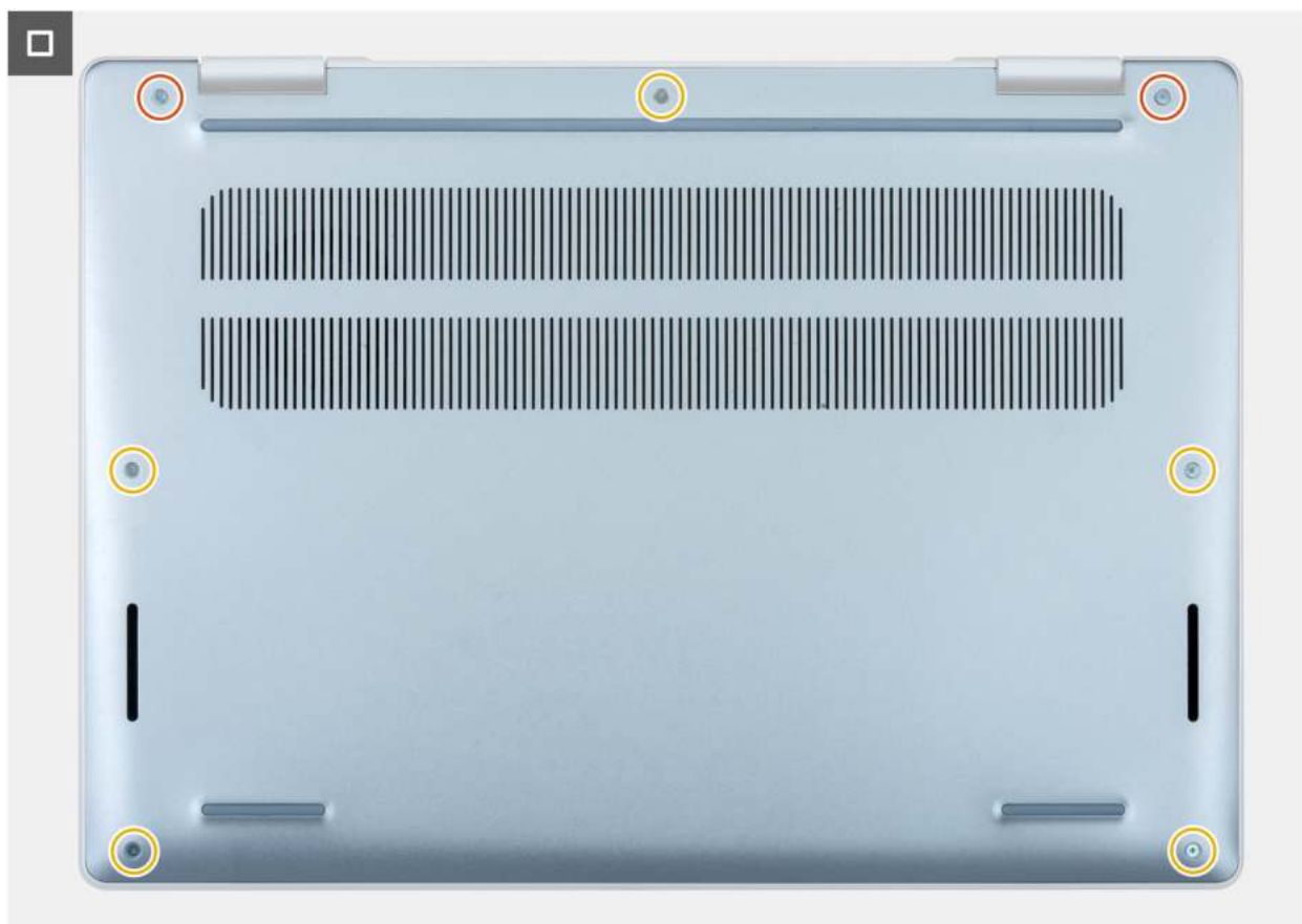
Rysunek 17. Dokręcanie śrub
