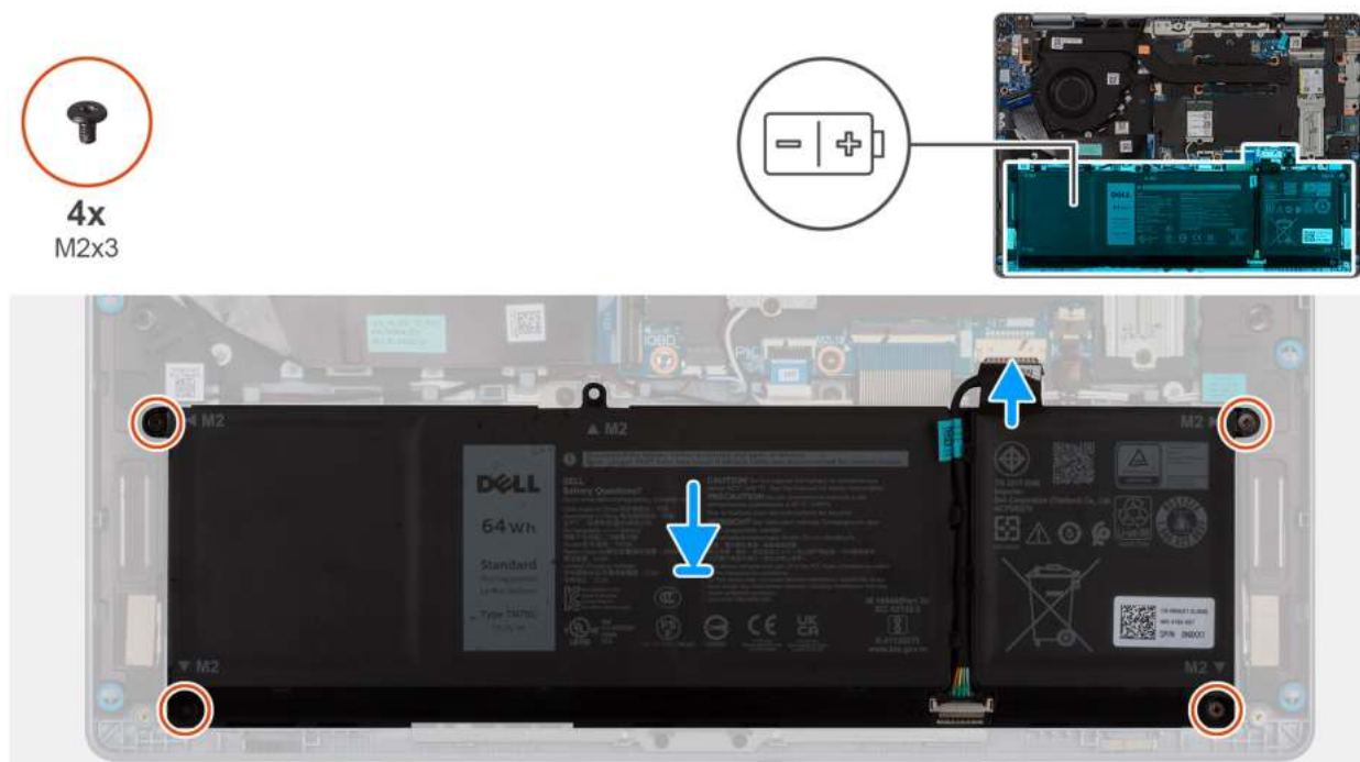
Rysunek 19. Instalowanie baterii
