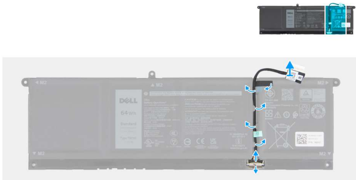
Rysunek 20. Odłączanie kabla baterii
