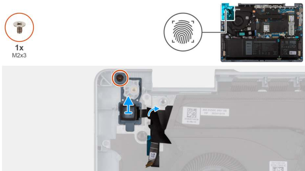
Rysunek 46. Wymontowywanie przycisku zasilania z czytnikiem linii papilarnych
