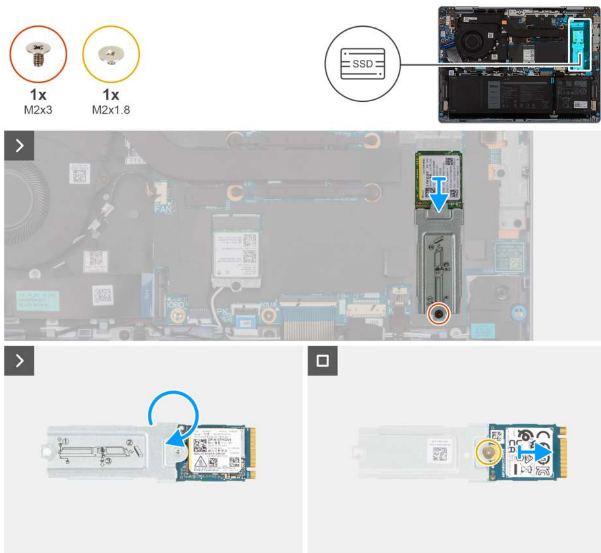
Rysunek 22. Wymontowywanie dysku SSD
