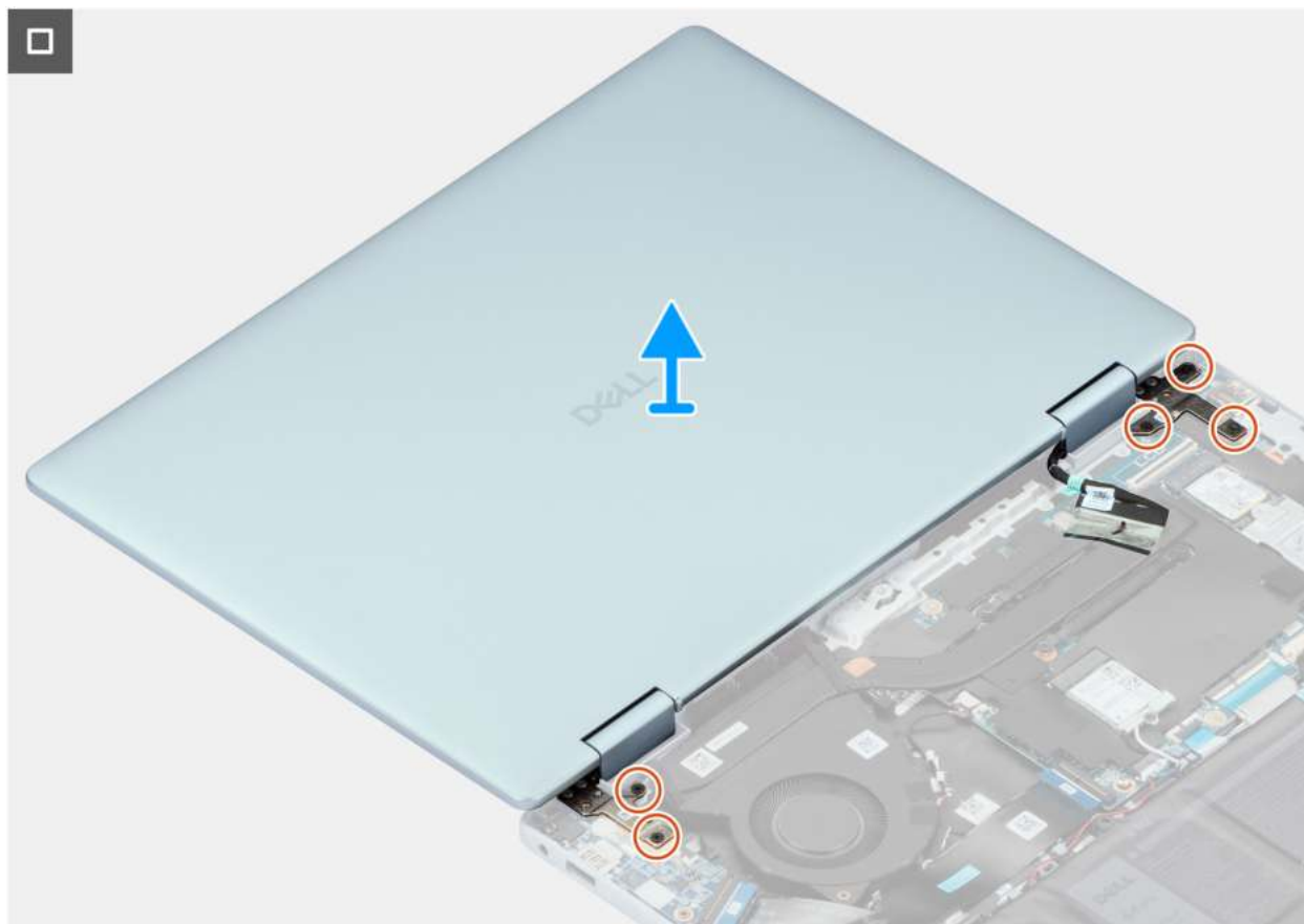
Rysunek 41. Wymontowywanie zestawu wyświetlacza
