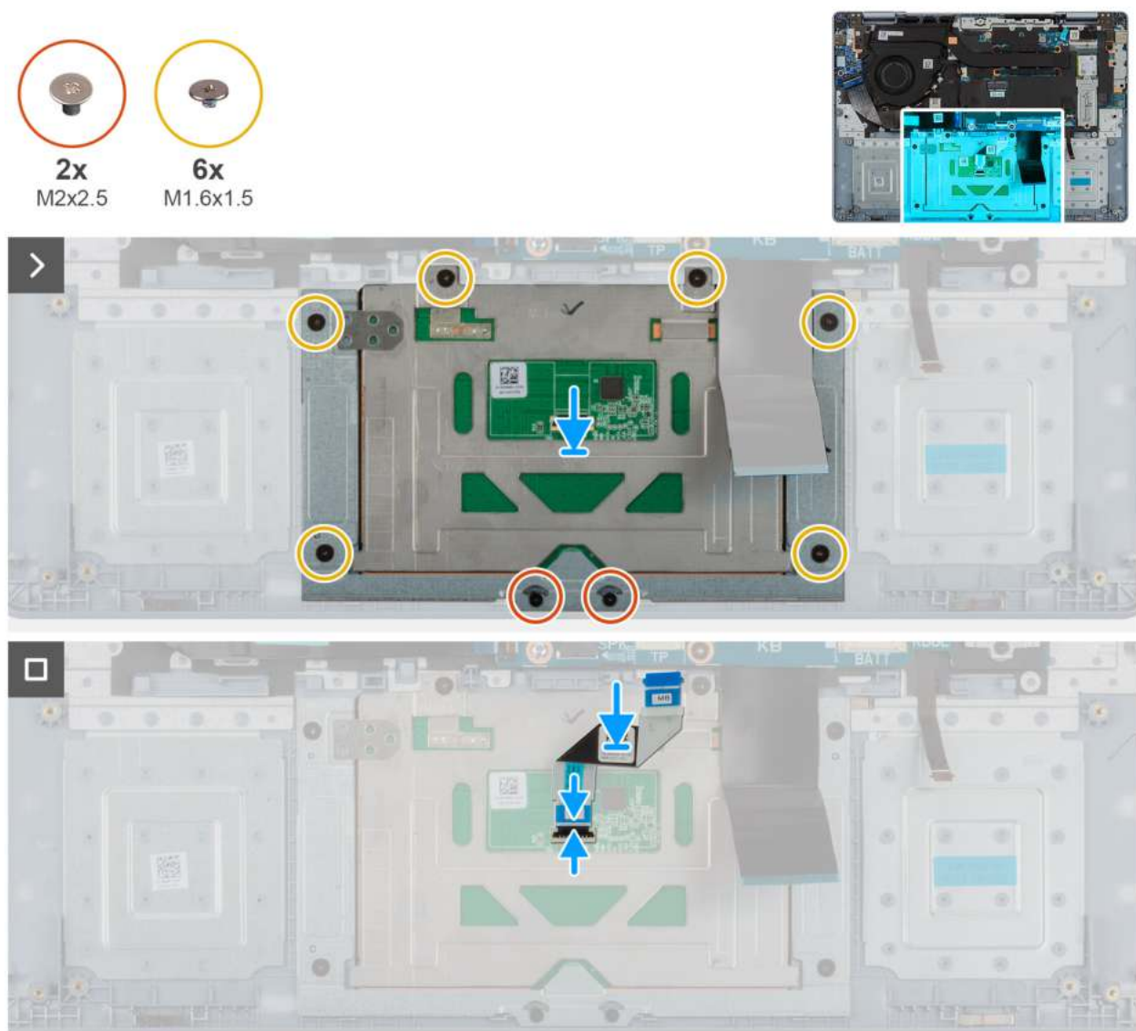
Rysunek 37. Instalowanie touchpada
